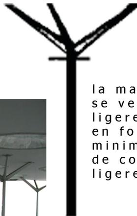
la magnitud de la cubierta se ve realizada ante la ligereza de las columnas en forma de árboles que minimizan la utilización de columnas y dan lugar a la ligereza espacial.
