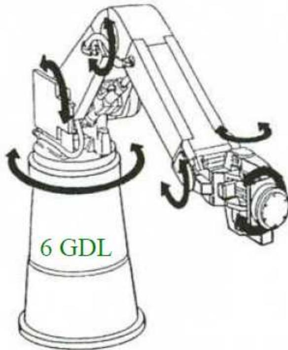
Fig. 4 Estructura de un robot Manipulador
