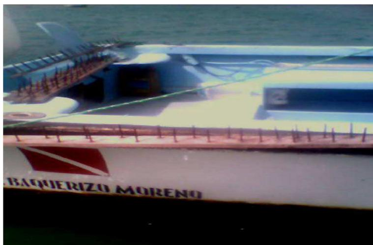
Gráfico I.- Embarcación protegida por madera con clavos
