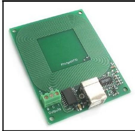
**Figura 2.6** Lector de RFID (www.phidgets.com)
