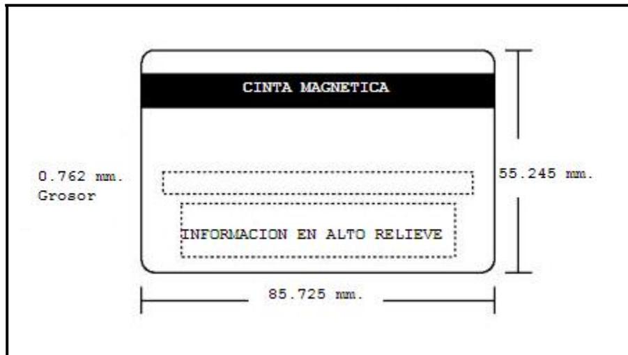
**Figura 2.8** Dimensiones de una tarjeta con cinta magnética
