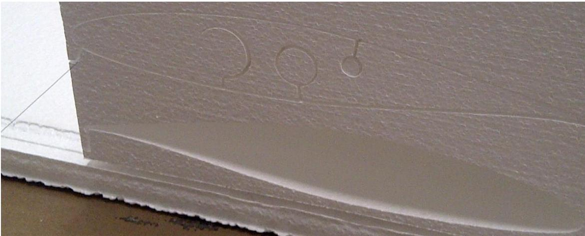
**Ilustración 136.- Corte CNC de las dos piezas de Sección II para cada ala; Proyecto Galapagos UAV**
