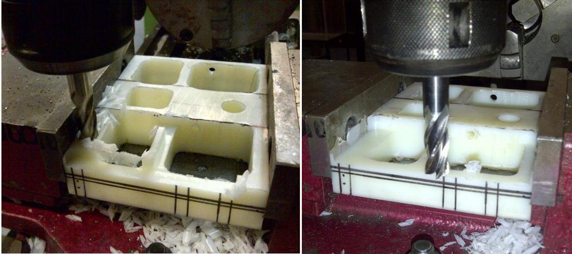
**Ilustración 125.- Generación de desnivel en Soporte Motor EVO-L; Proyecto Galapagos UAV**
