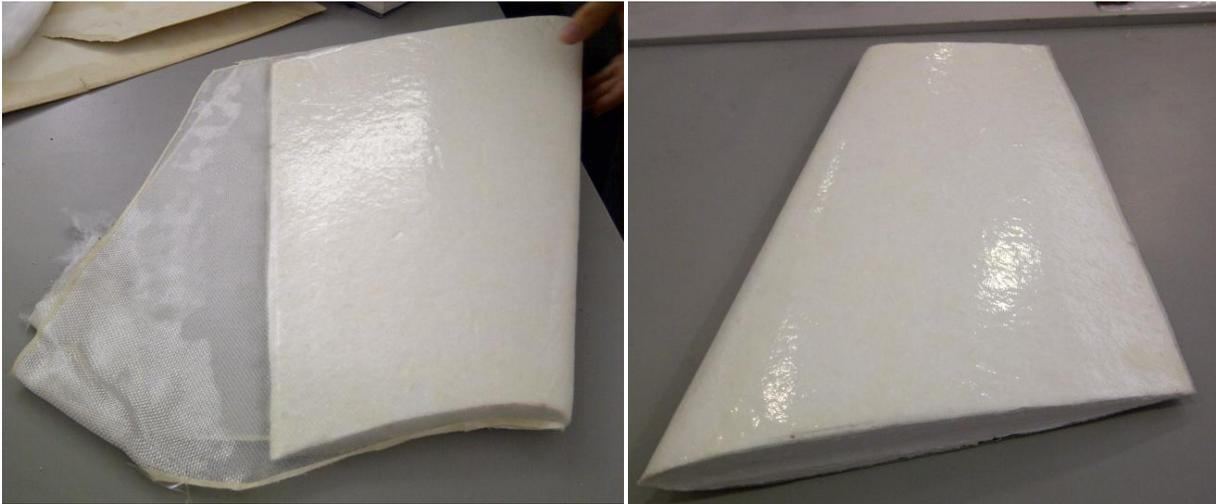
**Ilustración 40.- Resultados de Prueba III de Composites en Piezas: Proyecto Galapagos UAV**
