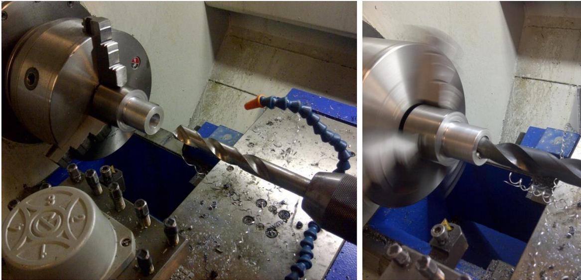
**Ilustración 92.-Taladrado del extremo tipo negativo del acople; Proyecto Galapagos UAV**
