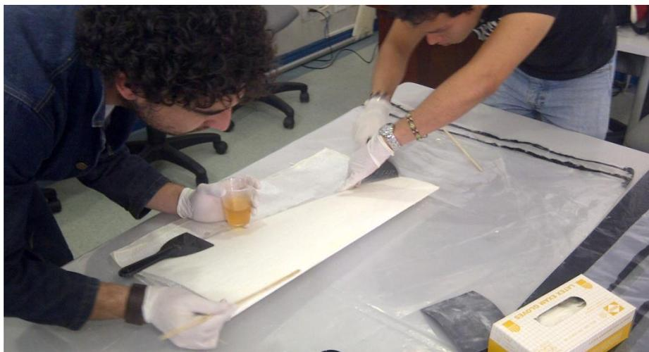
**Ilustración 184.- Resinado de Pieza Derecha para Cola Horizontal; Proyecto Galapagos UAV**
