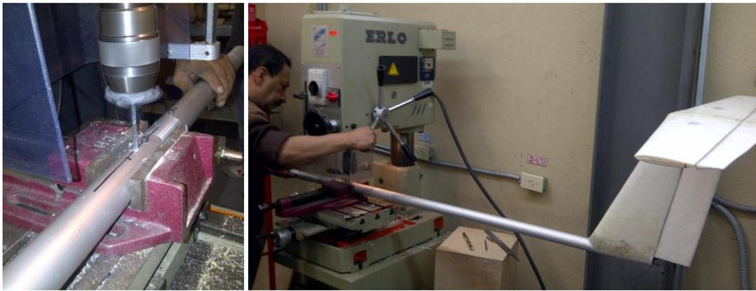
**Ilustración 231.- Perforaciones para Pasadores y Pines en Tubería Estructural; Proyecto Galapagos UAV**
