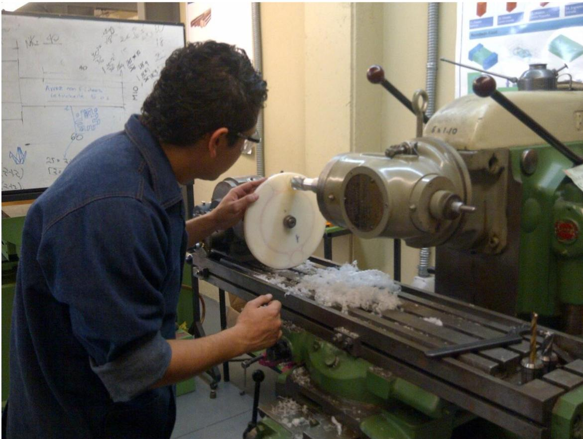
**Ilustración 80.- Alineación de discos con herramienta de corte: Proyecto Galapagos UAV**
