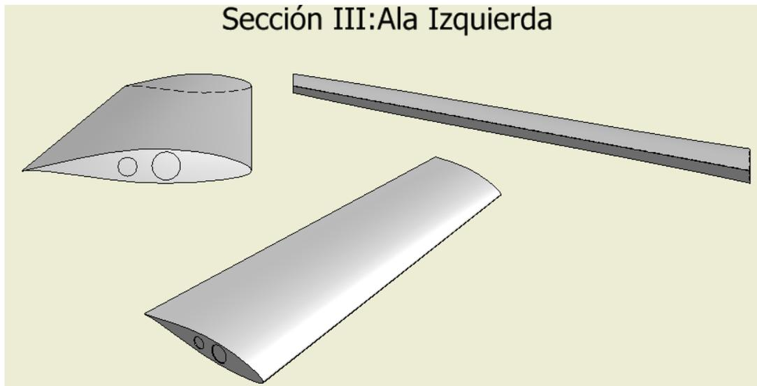
**Ilustración 139.- Modelos 3D Derecho-Izquierdo de la Sección III de ala; Proyecto Galapagos UAV)**
