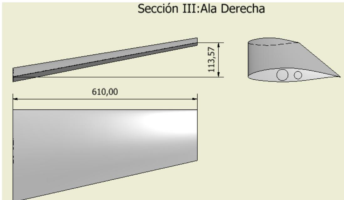
**Ilustración 138.- Modelos 3D Derecho-Izquierdo de la Sección III de ala; Proyecto Galapagos UAV**
