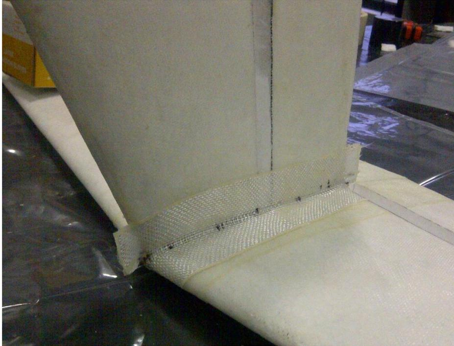
Ilustración 26.- Revestimiento de juntas con fibra de vidrio: Proyecto Galapagos UAV
