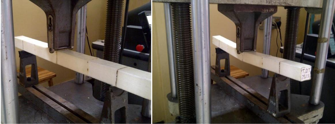
**Ilustración 50.- Ensayo de Flexión en Probetas con 25% de Junta: Proyecto Galapagos UAV**
