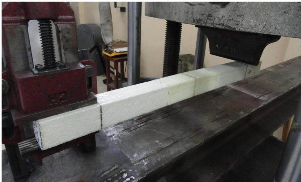
**Ilustración 54.- Ensayo de Deflexión en Junta de 15%: Proyecto Galapagos UAV**
