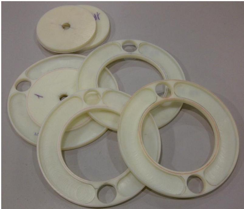
**Ilustración 88.- Manufactura final de Discos estructurales; Proyecto Galapagos UAV**
