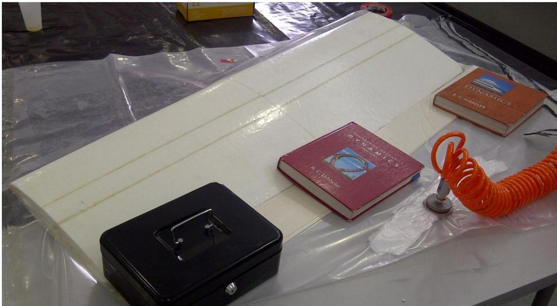
**Ilustración 161.- Sistema de Compactación para terminado de bordes; Proyecto Galapagos UAV**
