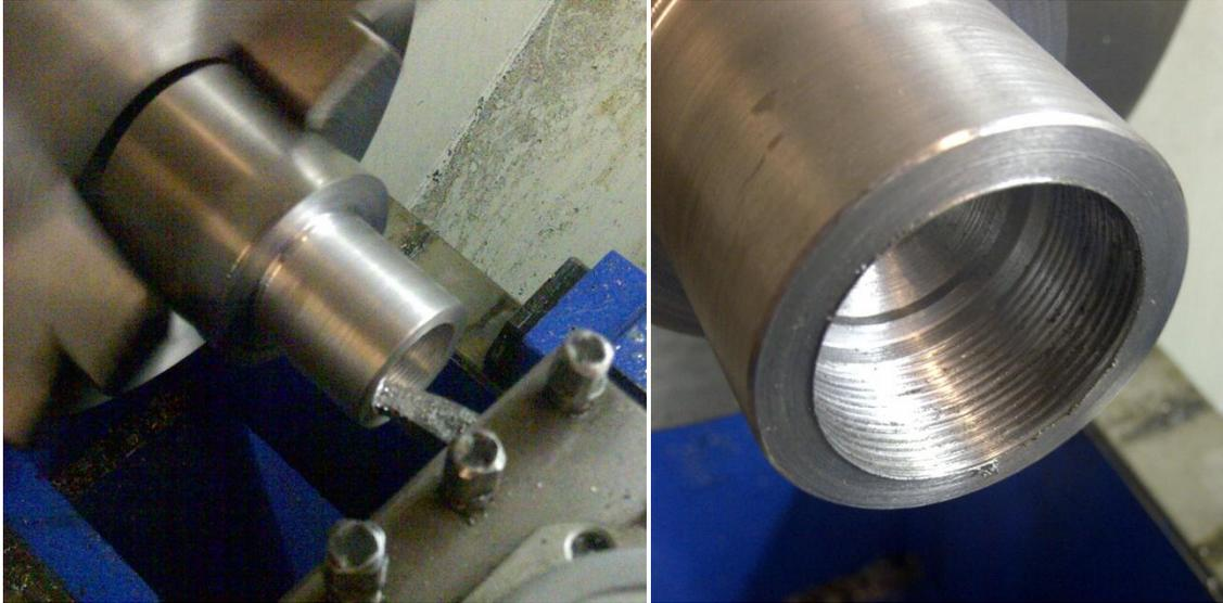
**Ilustración 93.- Roscado interno del extremo tipo negativo del acople; Proyecto Galapagos UAV**
