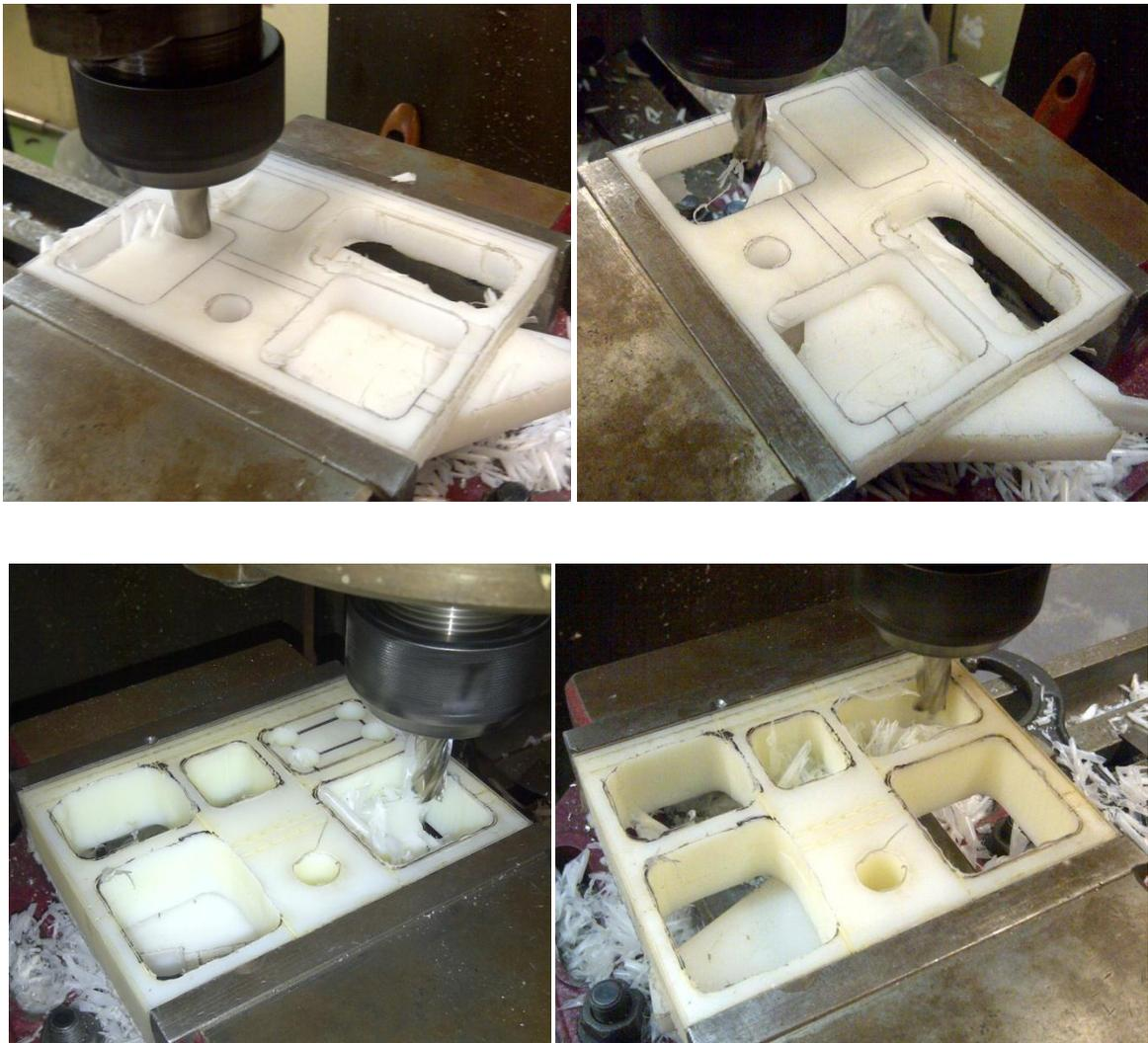
**Ilustración 124.- Vaciados de Soportes Motor EVOLUTION; Proyecto Galapagos UAV**
