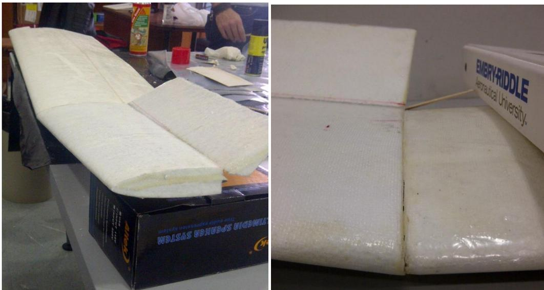
**Ilustración 174.- Adhesión de piezas de Sección I-II con Sección III; Proyecto Galapagos UAV**
