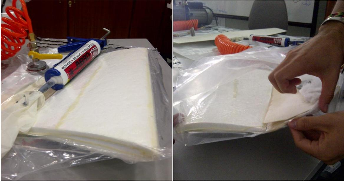
**Ilustración 199.- Proceso de Vacuum Bagging en Cola vertical; Proyecto Galapagos UAV**
