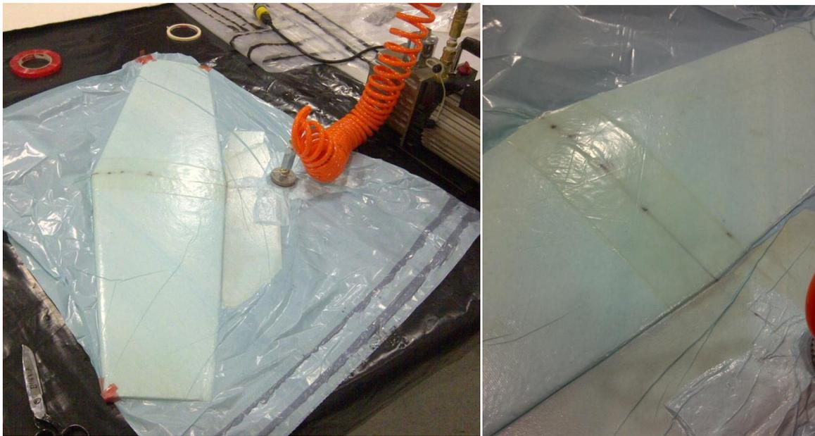
**Ilustración 189.- Proceso de Junta entre Piezas para formar la Cola Horizontal; Proyecto Galapagos UAV**
