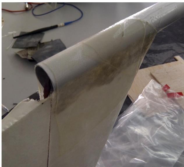
**Ilustración 213.- Resultado final de Junta de Cola y Tubería con Fibra Resinada; Proyecto Galapagos UAV**
