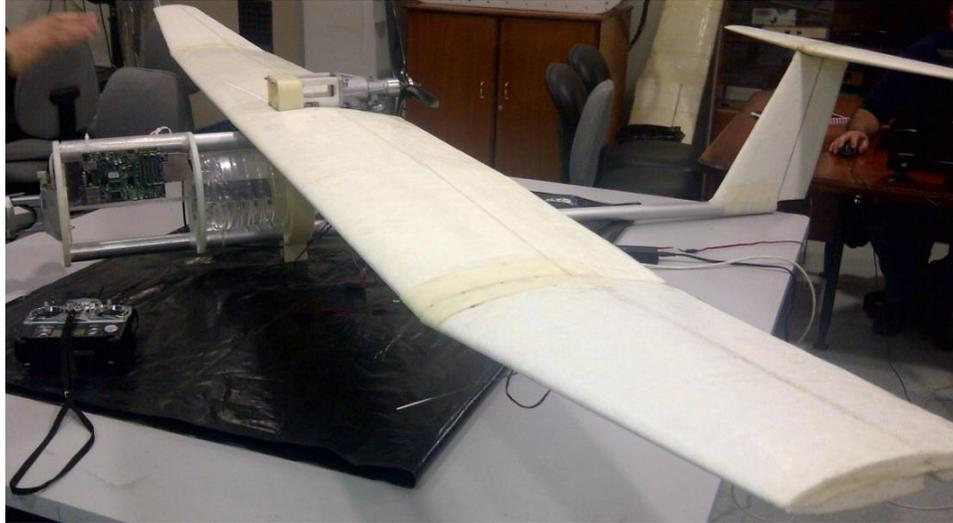
**Ilustración 179.- Resultado Final de Alas Ensambladas en Prototipo; Proyecto Galapagos U**
