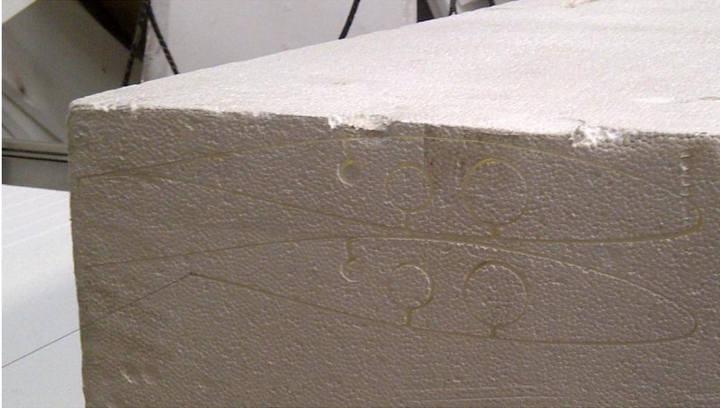
**Ilustración 23.- Corte de alas con alambre caliente: Proyecto Galapagos UAV**
