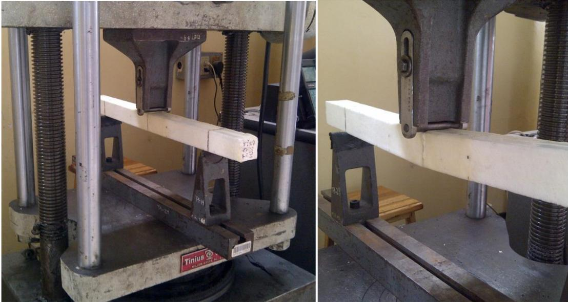
**Ilustración 49.- Ensayos de Flexión en Probetas con 15% de Junta: Proyecto Galapagos UAV**
