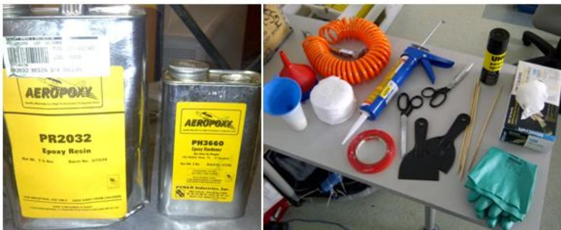
**Ilustración 159.- Materiales y Herramientas para Proceso de Resinado; Proyecto Galapagos UAV**
