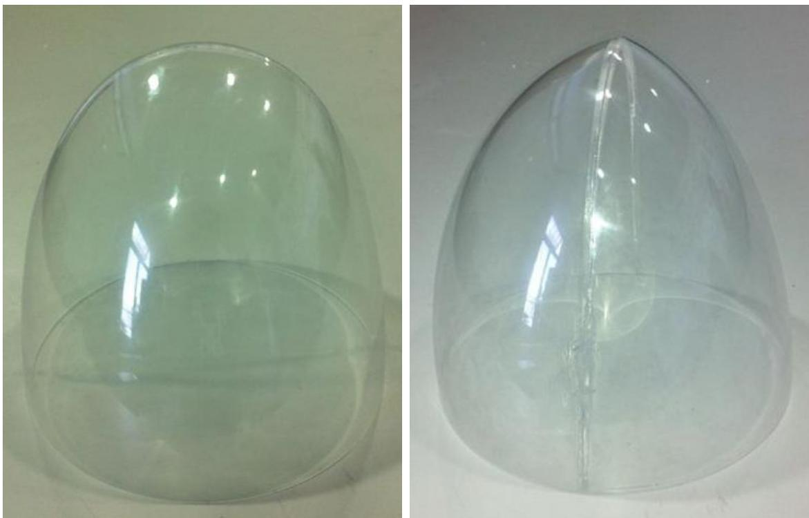
**Ilustración 225.- Visor Frontal manufacturado en Policarbonato Traslucido; Proyecto Galapagos UAV**
