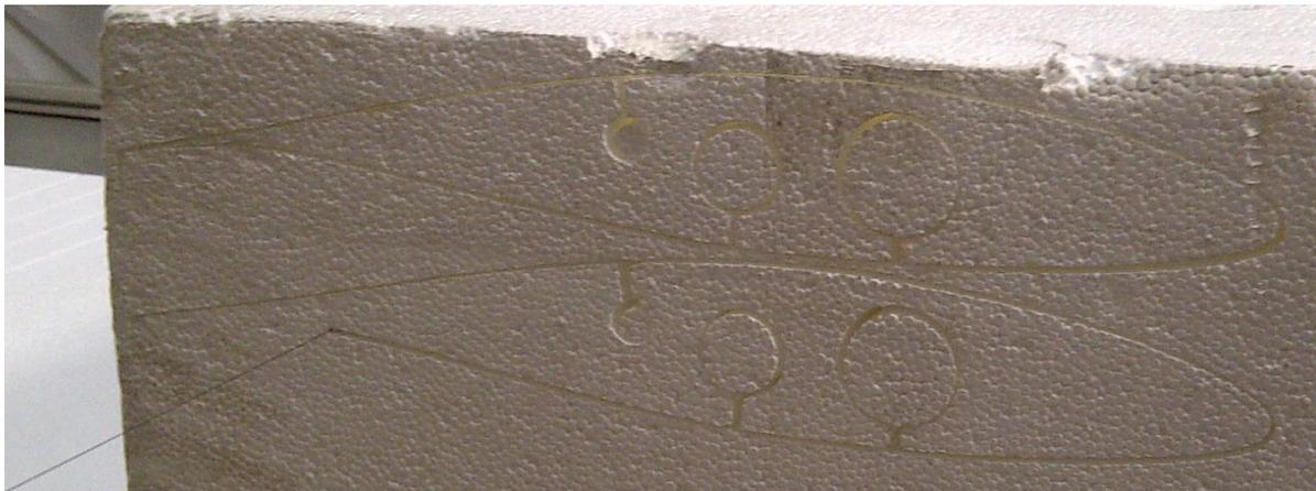
**Ilustración 133.- Corte CNC de las dos piezas de Sección I para las alas; Proyecto Galapagos UAV**
