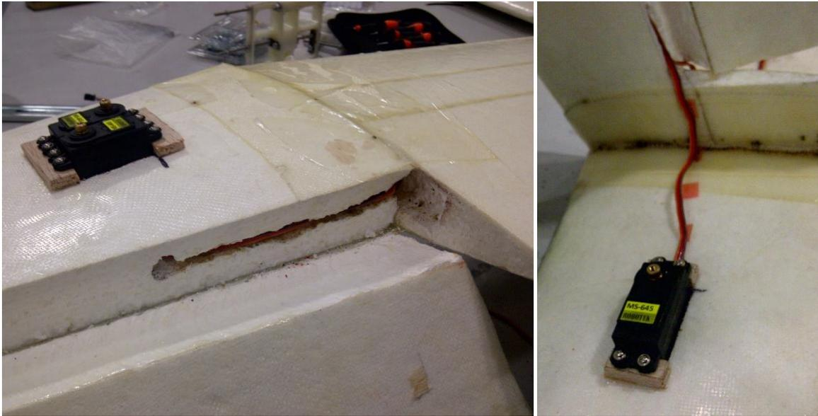
**Ilustración 236.- Ubicación Final de Servos en piezas con superficie de control; Proyecto Galapagos UAV**
