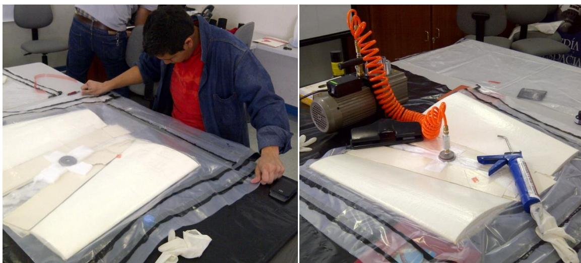
**Ilustración 167.- Sellado de bolsa y Proceso de Curado en piezas de Sección III; Proyecto Galapagos UAV**
