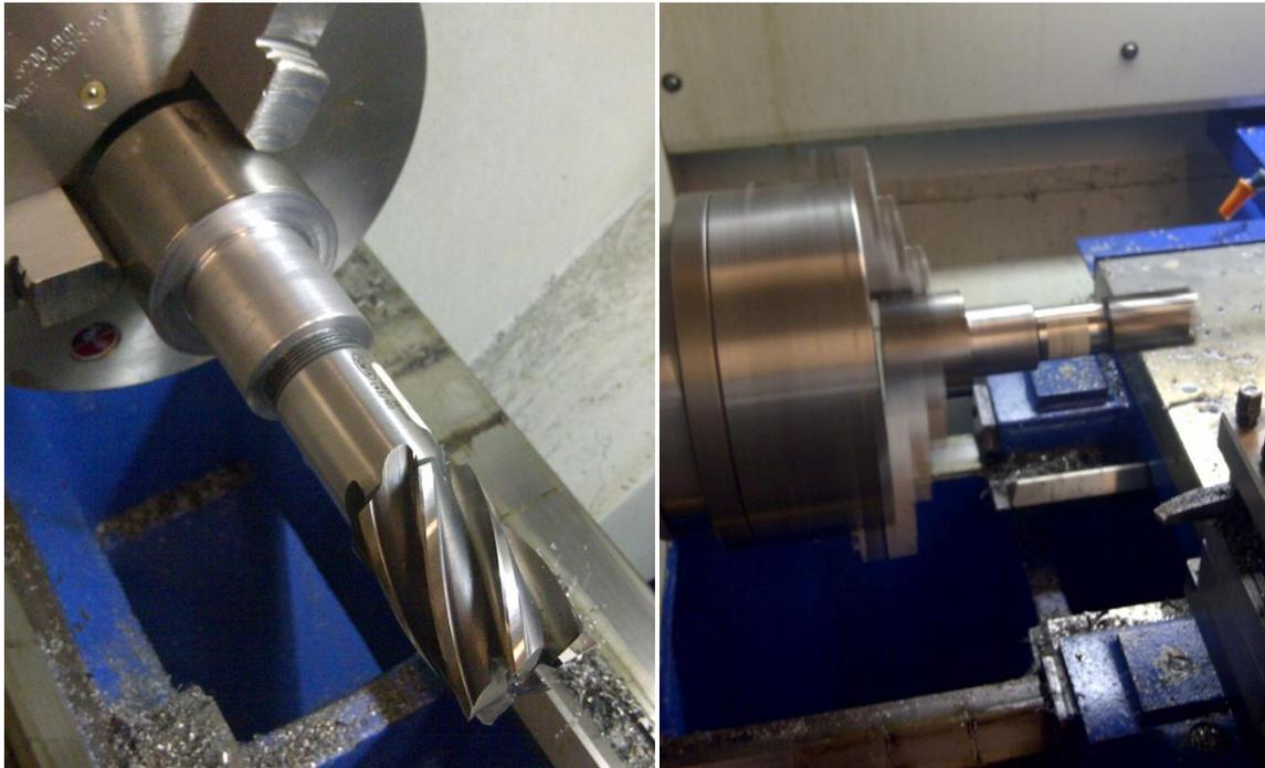
**Ilustración 94.- Prueba del roscado y acoplamiento de la fresa al elemento; Proyecto Galapagos UAV**
