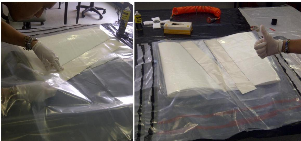
**Ilustración 166.- Sistema de Compactación de bordes en piezas de Sección III; Proyecto Galapagos UAV**
