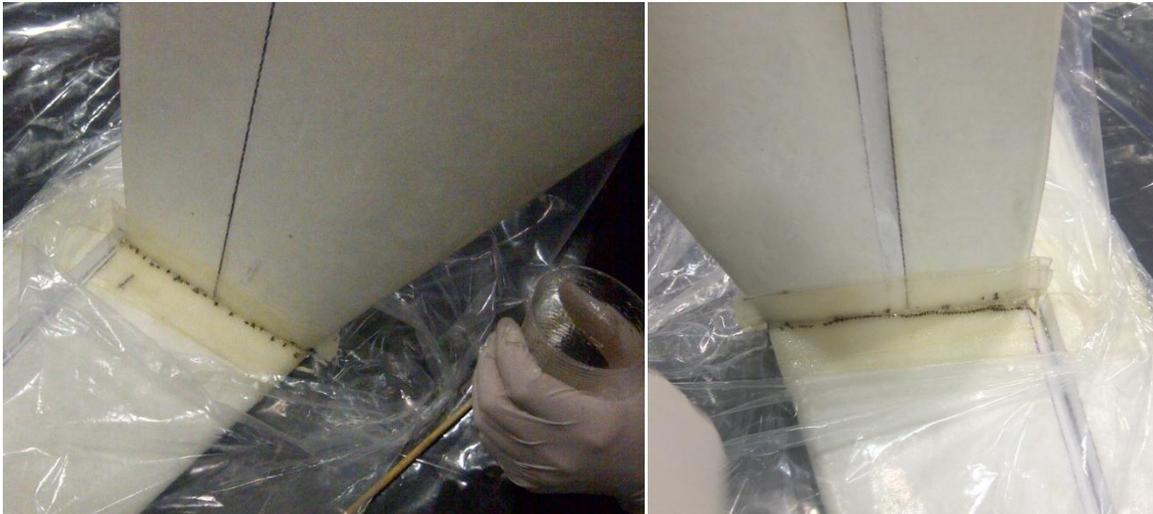
**Ilustración 206.- Resinado de Fibra de Vidrio para la Junta de la Cola; Proyecto Galapagos UAV**
