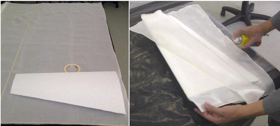
**Ilustración 164.- Corte y Adhesión de Fibra de Vidrio para Sección III del Ala; Proyecto Galapagos UAV**
