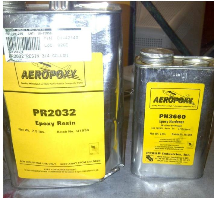
**Ilustración 30.- Resina y endurecedor AeroPoxy: Proyecto Galapagos UAV**
