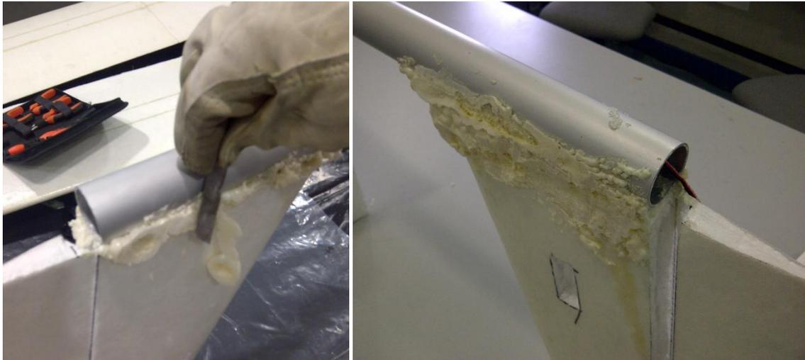
**Ilustración 209.- Eliminación de material extra de poliuretano en junta de cola; Proyecto Galapagos UAV**
