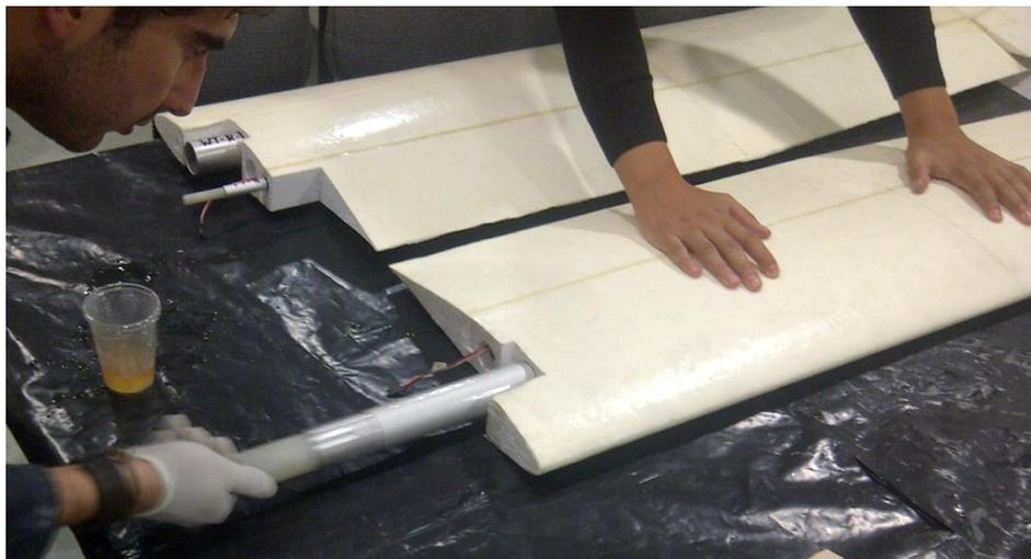
**Ilustración 67.- Wing Rods y Torsion Pins embonados en alas: Proyecto Galapagos UAV**
