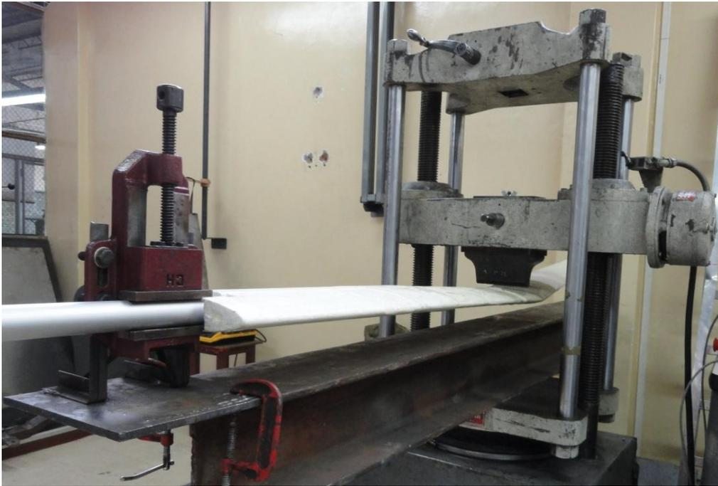
**Ilustración 58.- Ensayo de Deflexión en Ala Completa de prueba: Proyecto Galapagos UAV**
