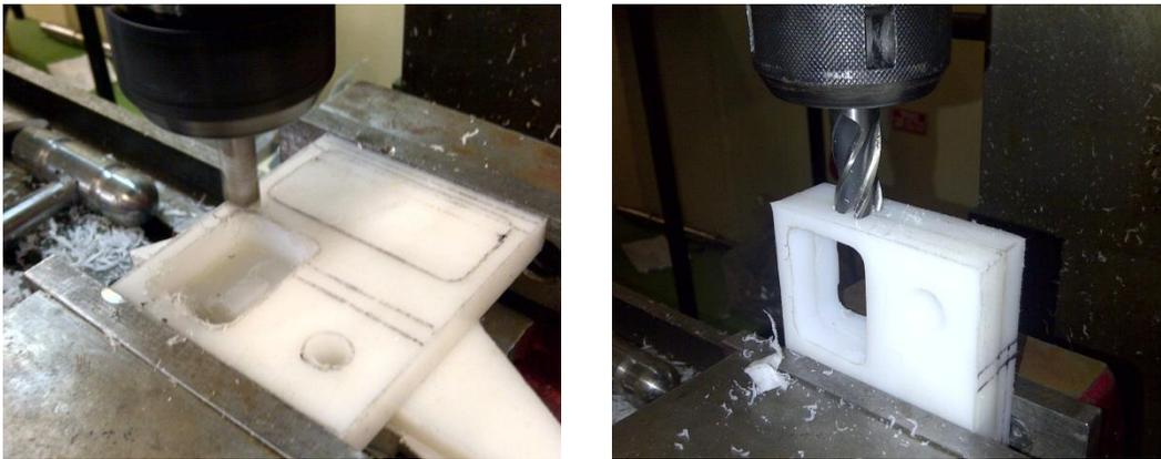
**Ilustración 9.- Fresado de Partes: Proyecto Galapagos UAV**
