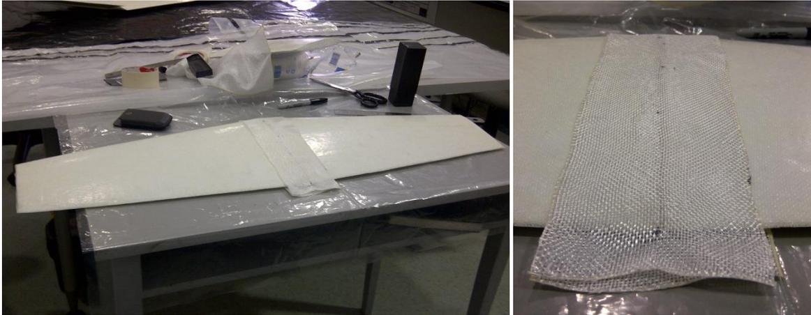
**Ilustración 188.- Adhesión de fibra en Junta entre Piezas para formar la Cola Horizontal; Proyecto Galapagos UAV**
