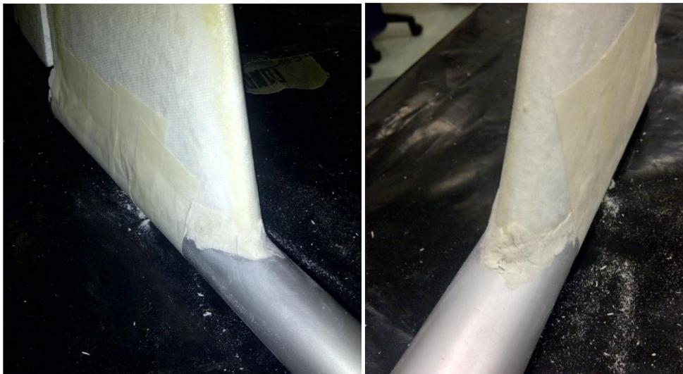
**Ilustración 210.- Resultado final de lijado de poliuretano en junta de Cola; Proyecto Galapagos UAV**
