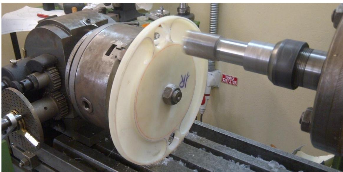
**Ilustración 85.- Taladrado y fresado de orificios de los discos estructurales; Proyecto Galapagos UAV**
