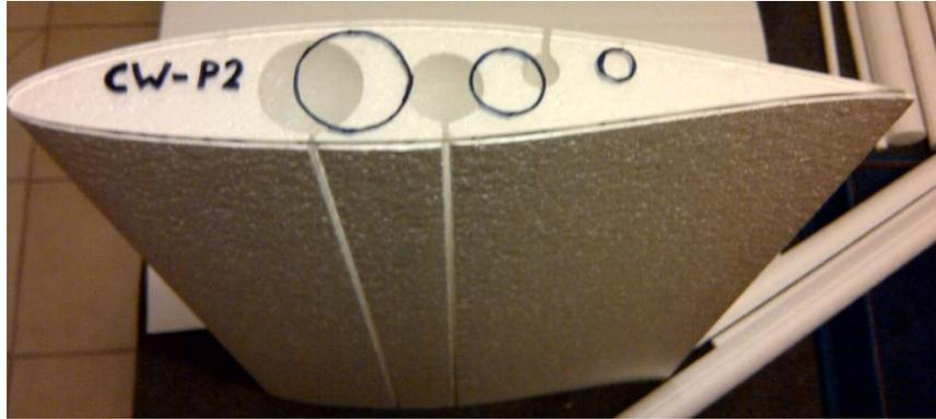
**Ilustración 149.- Comprobación de dimensiones para perfiles de cada sección; Proyecto Galapagos UAV**
