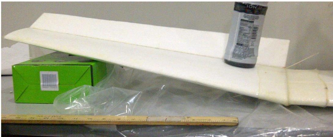
**Ilustración 177.- Proceso de Curado en Junta Estructural de Alas; Proyecto Galapagos UAV**
