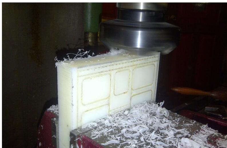
**Ilustración 19.- Rectificación de en pieza con fresadora: Proyecto Galapagos UAV**
