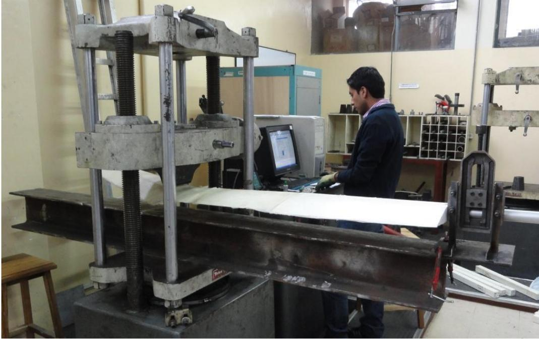
**Ilustración 57.- Ensayo de Deflexión en Ala Completa de prueba: Proyecto Galapagos UAV**
