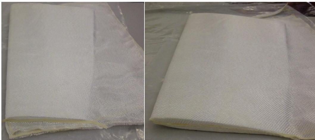
**Ilustración 183.- Pegado de Fibra de Vidrio en Piezas para Cola Horizontal; Proyecto Galapagos UAV**
