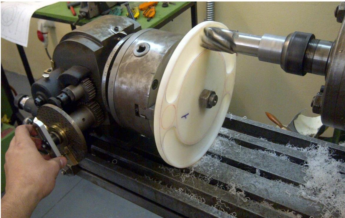
**Ilustración 82.- Vaciado de las secciones laterales de los discos estructurales; Proyecto Galapagos UAV**
