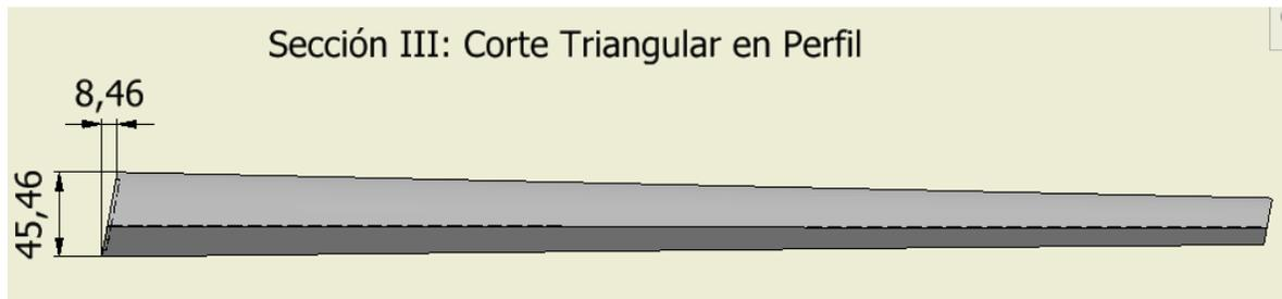
Ilustración 145.- Modelo del corte triangular de la Sección III del Ala; Proyecto Galapagos UAV
