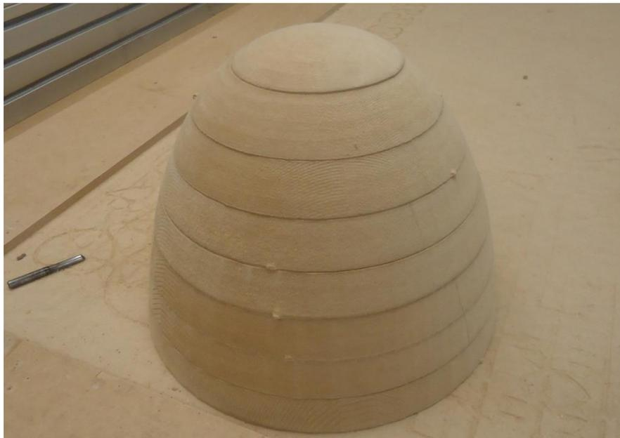
**Ilustración 224.- Molde positivo del Visor Frontal manufacturado en MDF; Proyecto Galapagos UAV**
