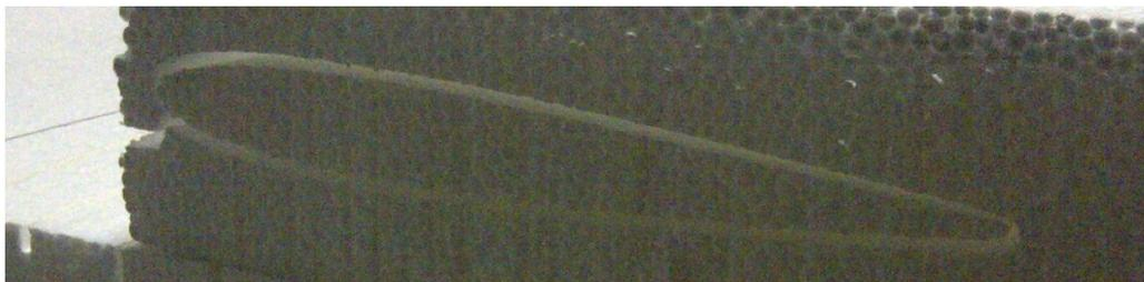
**Ilustración 182.-Corte de Pieza Derecha para Cola Horizontal; Proyecto Galapagos UAV**
