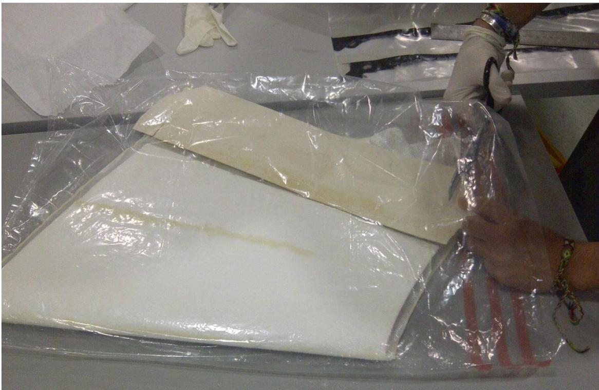
**Ilustración 198.- Colocación de Sistema de Compactación de Bordes; Proyecto Galapagos UAV**
