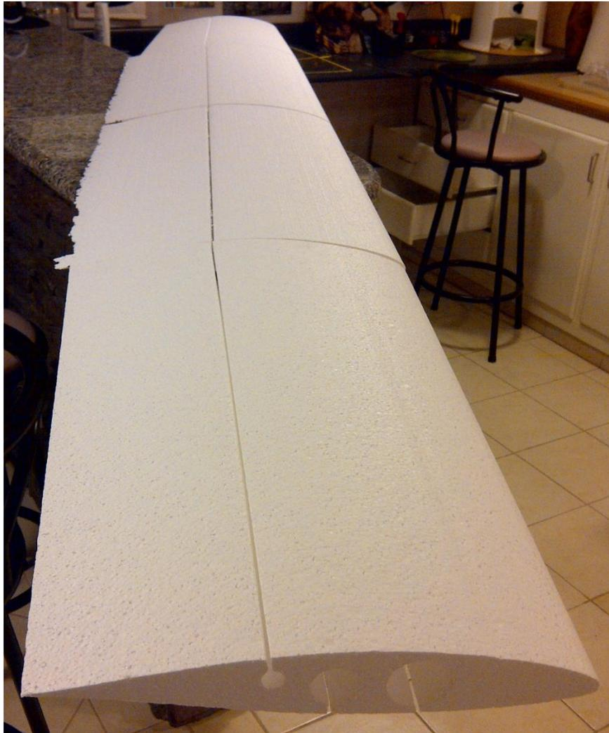
**Ilustración 150.- Ensamble Total del ala con Secciones I y II Derecha-Izquierda; Proyecto Galapagos UAV**
