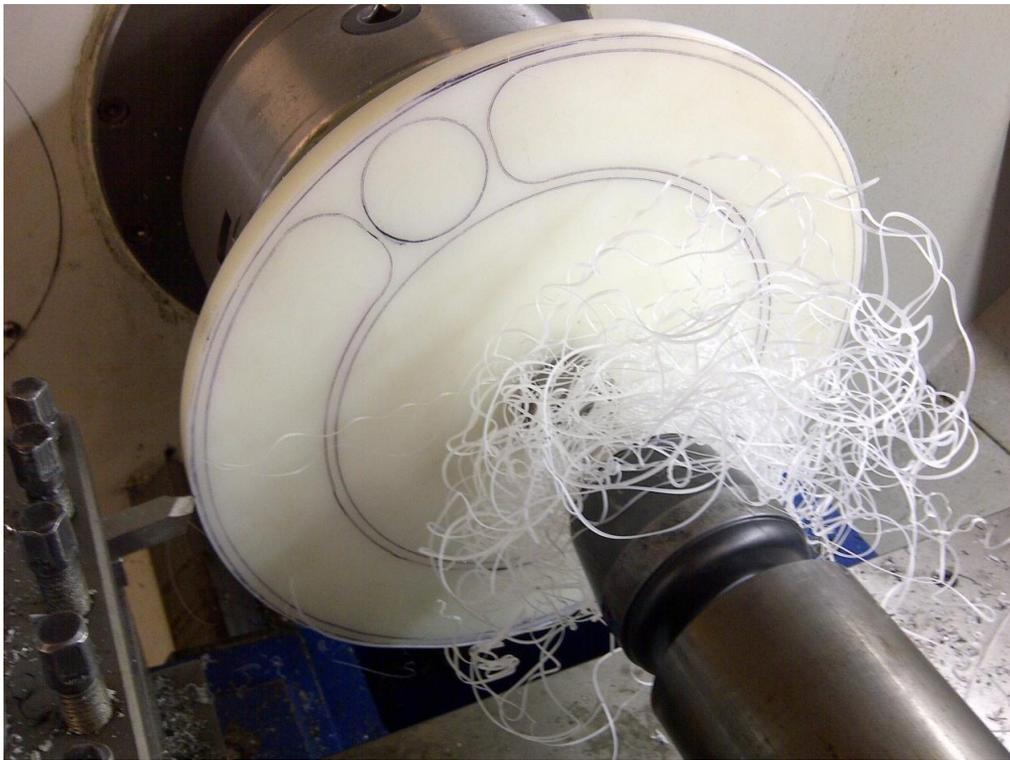
**Ilustración 77.- Proceso de Torneado de Front Discs: Proyecto Galapagos UAV**
