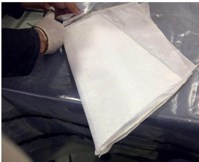
**Ilustración 197.- Corte y Pegado de Fibra de Vidrio en pieza de Cola Vertical; Proyecto Galapagos UAV**
