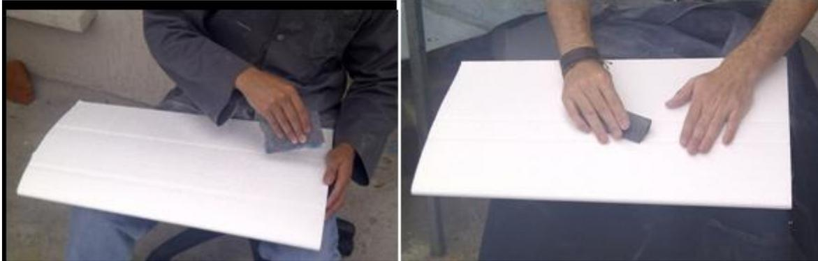
**Ilustración 152.- Proceso de lijado de secciones del ala; Proyecto Galapagos UA**
