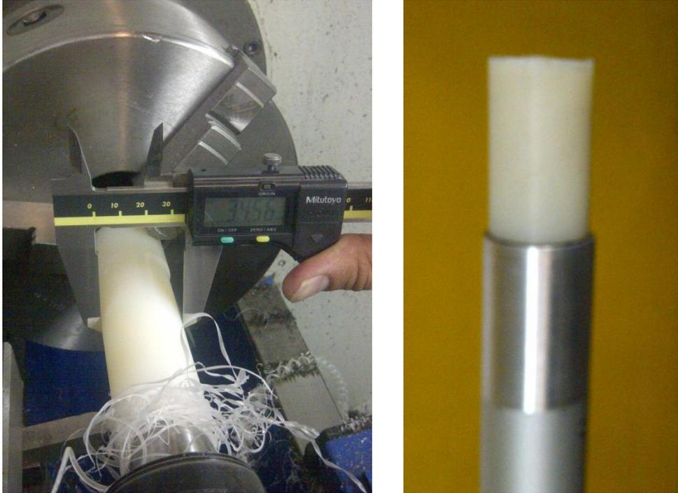
**Ilustración 228.- Mecanizado de almas para la sección de juntas de tubería; Proyecto Galapagos UAV**
