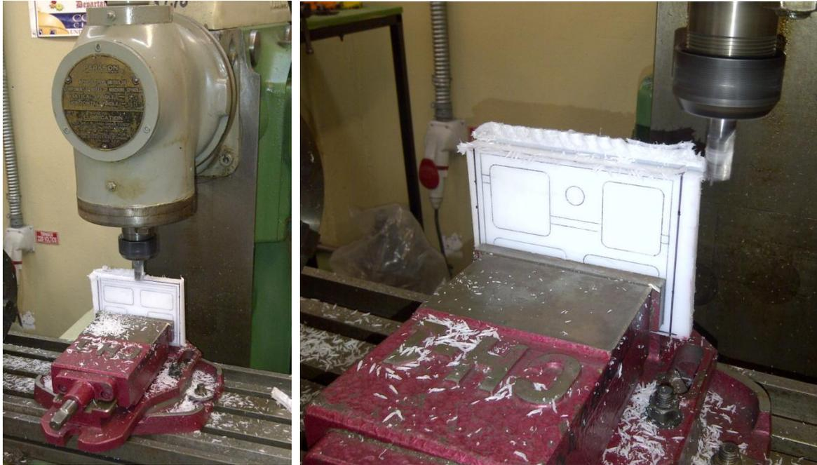
**Ilustración 120.- Rectificado de caras laterales Soporte Motor EVO-R; Proyecto Galapagos UAV**
