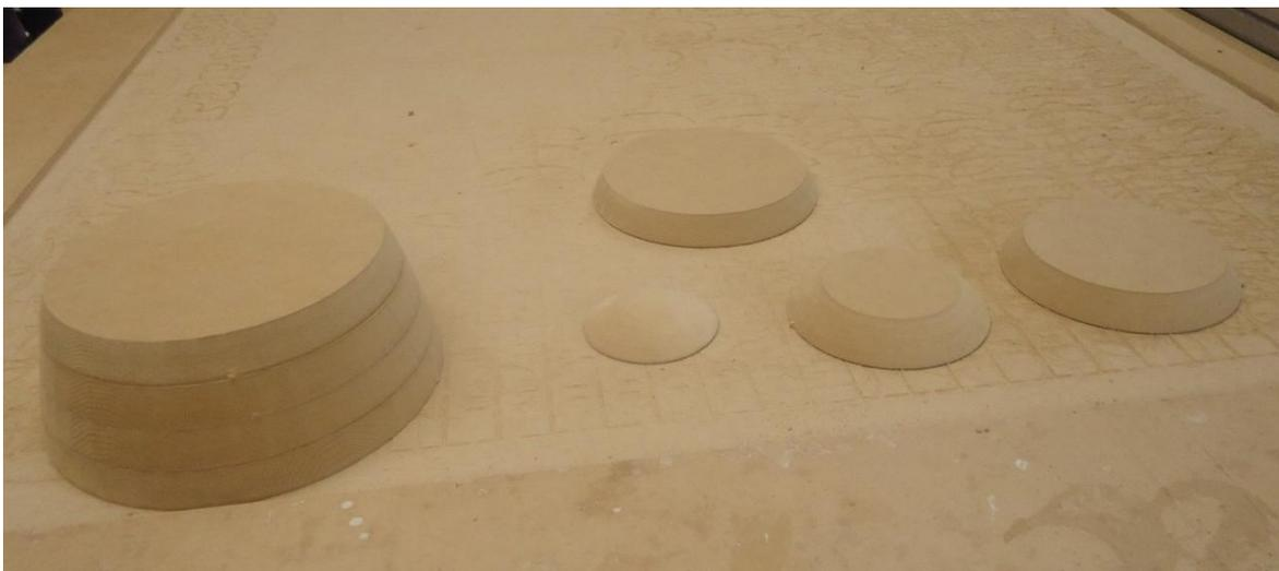
**Ilustración 223.- Manufactura en capas del molde positivo del Visor Frontal; Proyecto Galapagos UAV**
