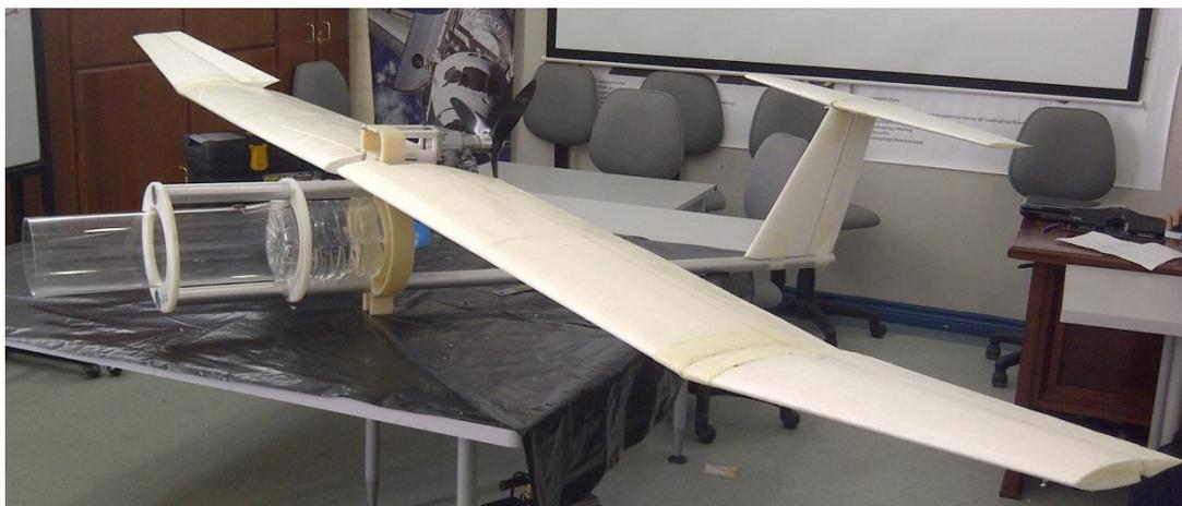
**Ilustración 69.- Tubería conectando alas, cola y piezas del prototipo: Proyecto Galapagos UAV**
