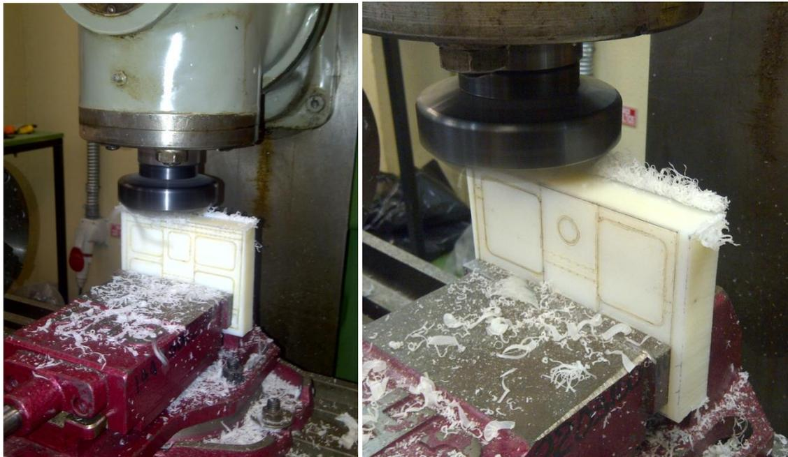
**Ilustración 121.- Rectificado de caras laterales Soporte Motor EVO-L; Proyecto Galapagos UAV**
