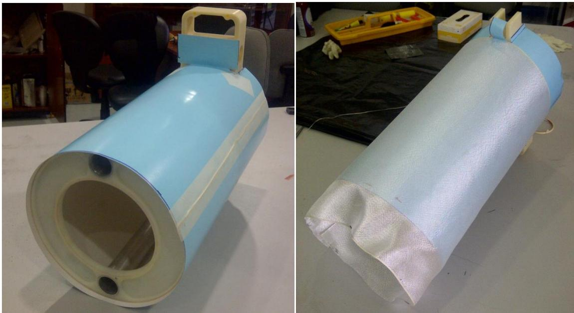
**Ilustración 218.- Molde cilíndrico para adherencia de fibra de vidrio; Proyecto Galapagos UAV**
