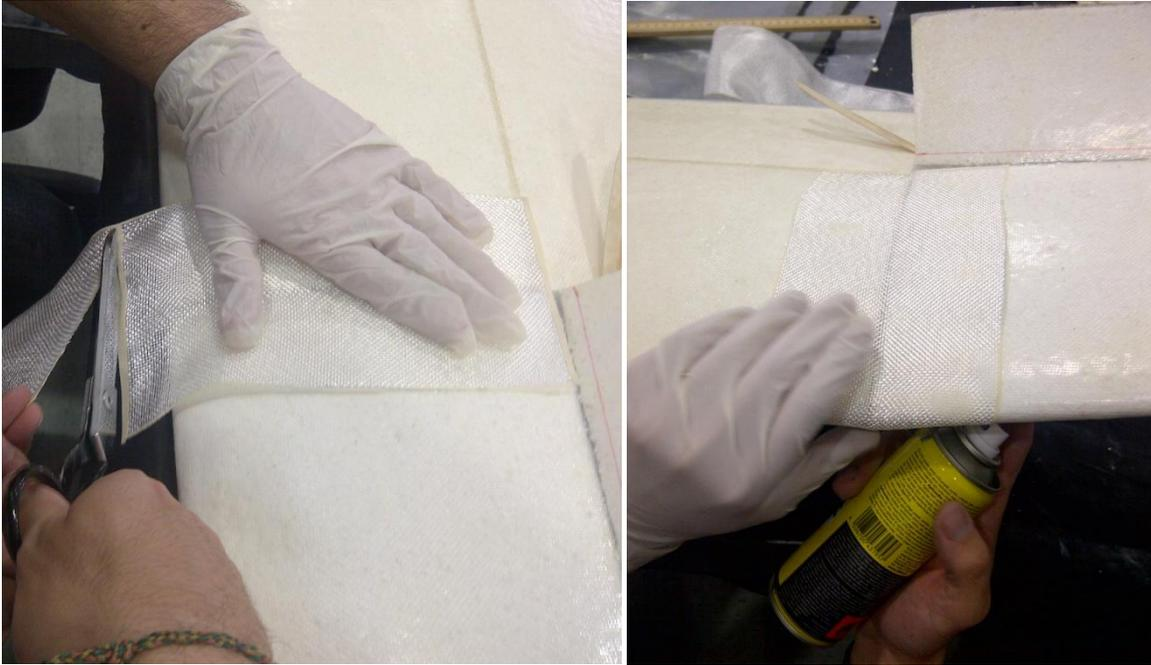
**Ilustración 175.- Adhesión de Fibra de Vidrio para Elaboración de Junta en Ala; Proyecto Galapagos UAV**
