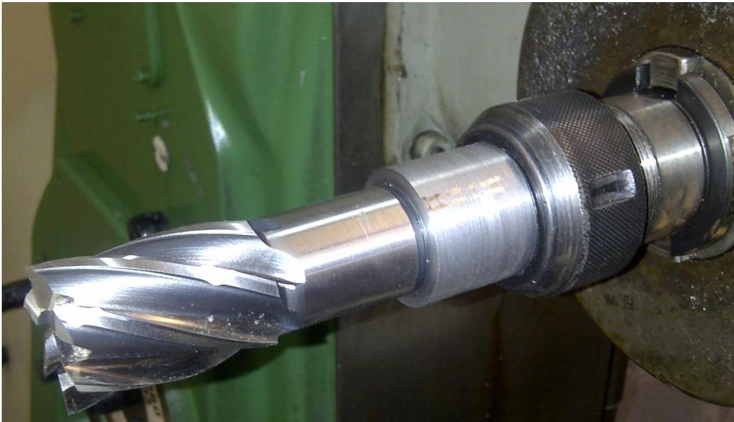
**Ilustración 79.- Fresa con acoplamiento montada en maquina herramienta fresadora: Proyecto Galapagos UAV**
