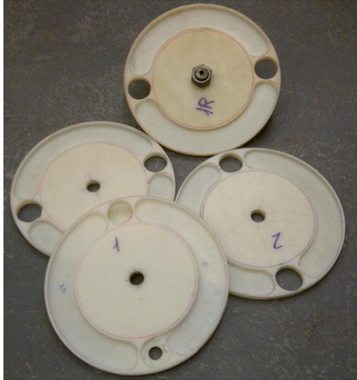
**Ilustración 87.- Discos estructurales antes del torneado interno; Proyecto Galapagos UAV**
