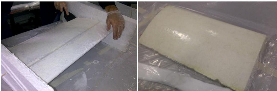
**Ilustración 36.- Resinado y Resultados Prueba II de Composites en Piezas: Proyecto Galapagos UAV**
