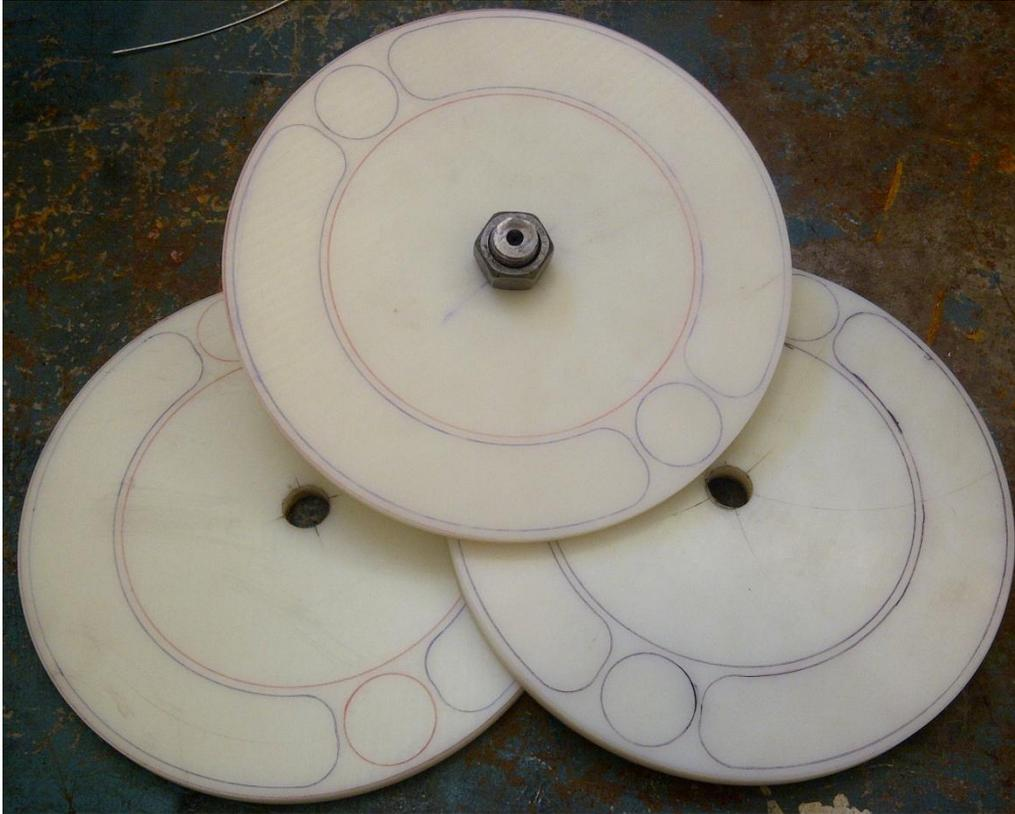
**Ilustración 78.- Front Discs después de torneado externo: Proyecto Galapagos UAV**
