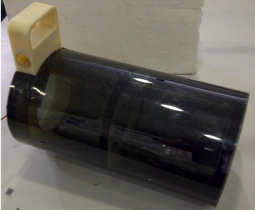
**Ilustración 221.- Fuselaje manufacturado con Lámina de Blindaje 8000; Proyecto Galapagos UAV**
