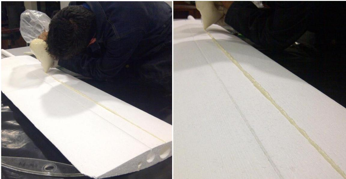
**Ilustración 156.- Sellado de zanjas longitudinales con espuma de poliuretano; Proyecto Galapagos UAV**
