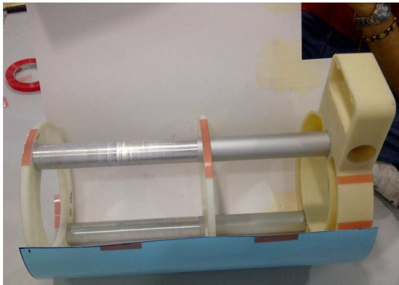
**Ilustración 217.- Acoplamiento de cartulina para generación del fuselaje; Proyecto Galapagos UAV**
