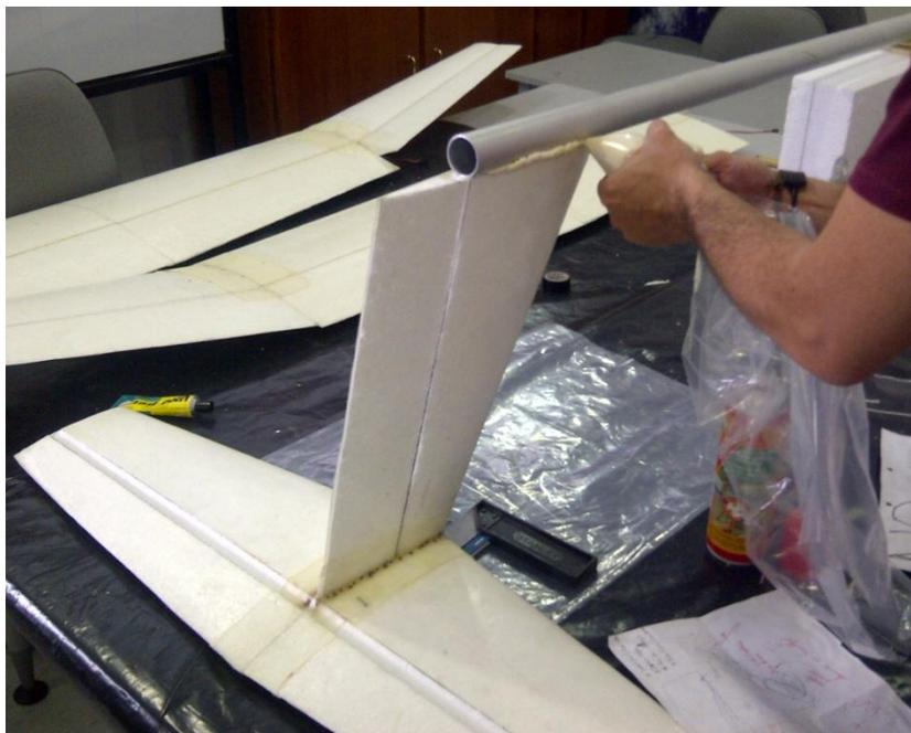
**Ilustración 68.- Tail Boom conectado con piezas de la cola: Proyecto Galapagos UAV**
