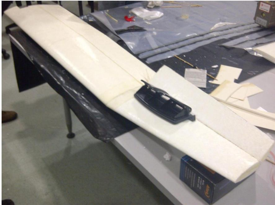
**Ilustración 176.- Proceso de Curado en Junta Estructural de Alas; Proyecto Galapagos UAV**
