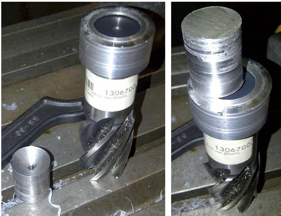
**Ilustración 96.- Fractura del primer acople manufacturado; Proyecto Galapagos UAV**
