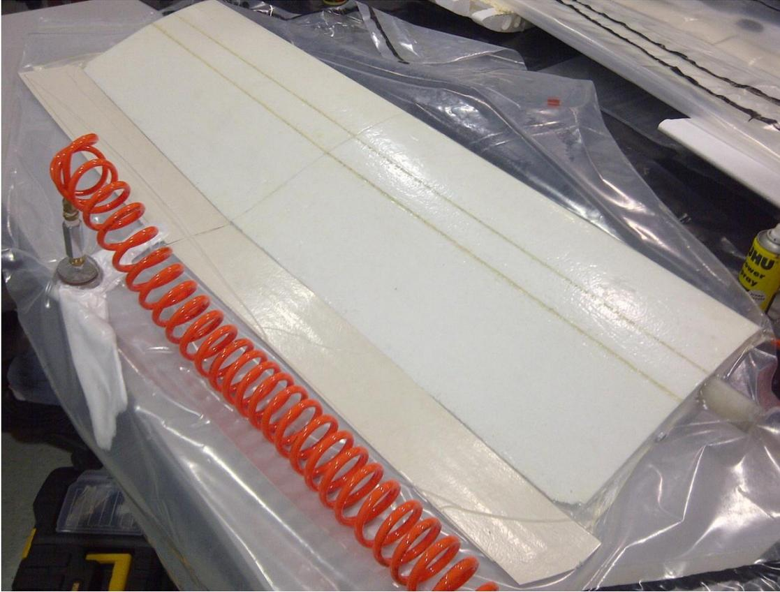
**Ilustración 160.- Proceso de Curado y Vacuum Bagging de Secciones I y II; Proyecto Galapagos UAV**
