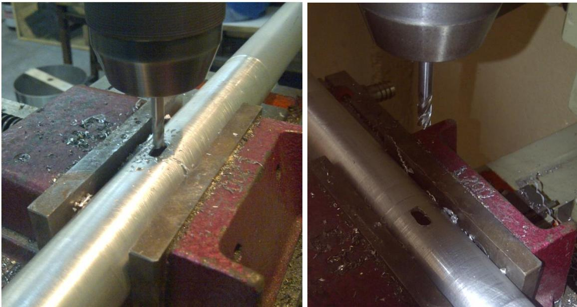
**Ilustración 239.- Elaboración de Destajes Rectangulares en Tubería Estructural; Proyecto Galapagos UAV**
