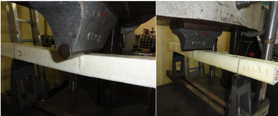
**Ilustración 46.- Ensayos de Flexión en Probetas del Material Compuesto: Proyecto Galapagos UAV**
