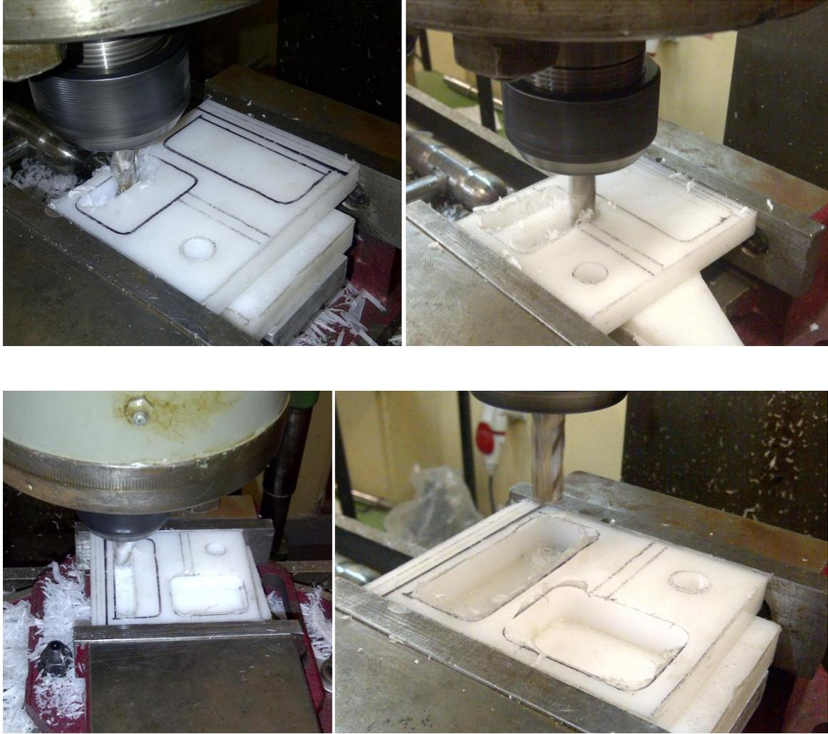
**Ilustración 112.- Vaciado de Soportes para Motor ENYA; Proyecto Galapagos UAV**
