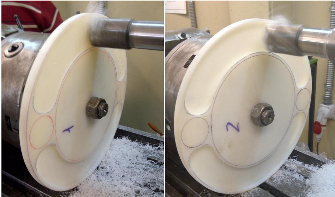
**Ilustración 83.- Vaciado de las secciones laterales de los discos estructurales; Proyecto Galapagos UAV**
