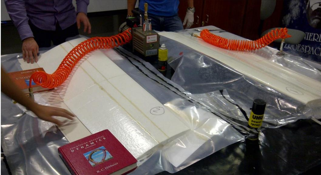
**Ilustración 162.- Proceso de Curado y Vacuum Bagging en las dos Alas; Proyecto Galapagos UAV**
