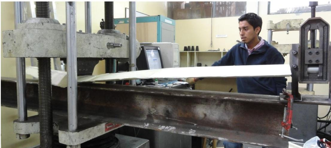
**Ilustración 59.- Ensayo de Deflexión en Ala Completa de prueba: Proyecto Galapagos UAV**
