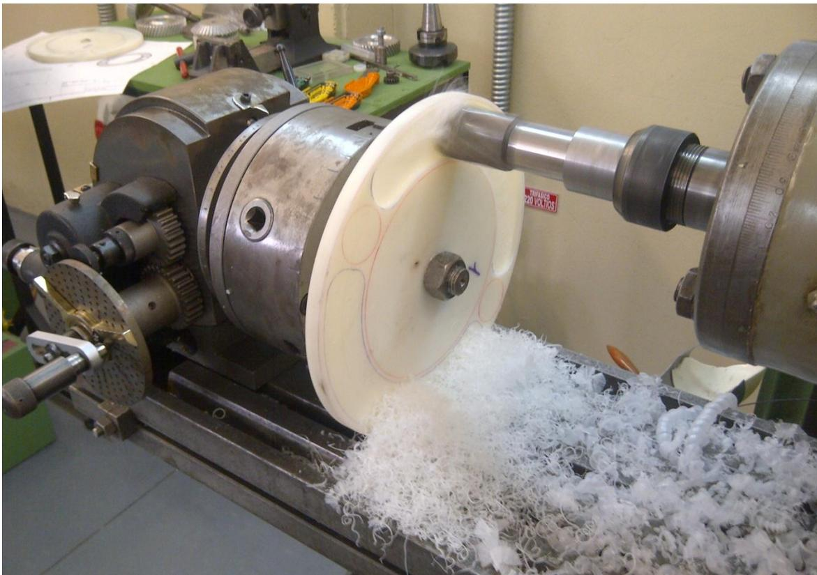
**Ilustración 81.- Vaciado de sección lateral en disco estructural; Proyecto Galapagos UAV**
