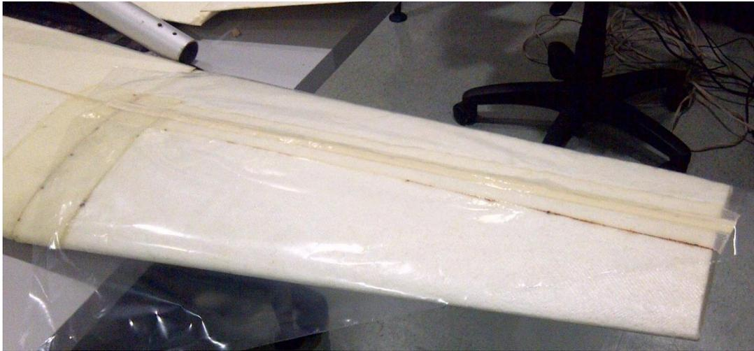
**Ilustración 243.- Resinado de Reforzamiento de Juntas para Superficies de Control; Proyecto Galapagos UAV**
