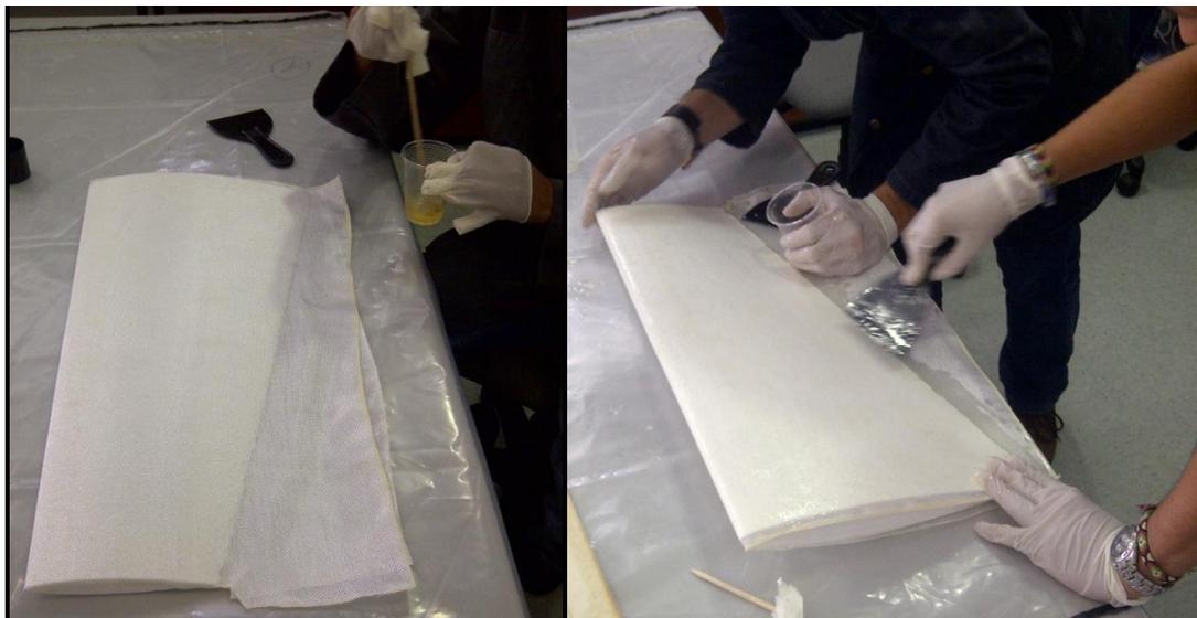
**Ilustración 165.- Proceso de resinado de las dos piezas de Sección III; Proyecto Galapagos UAV**
