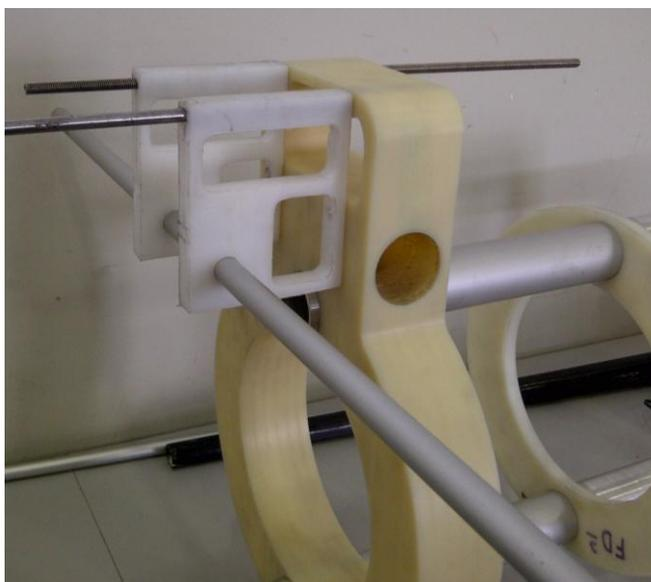
**Ilustración 115.- Soportes de Sujeción para Motor ENYA; Proyecto Galapagos UAV**
