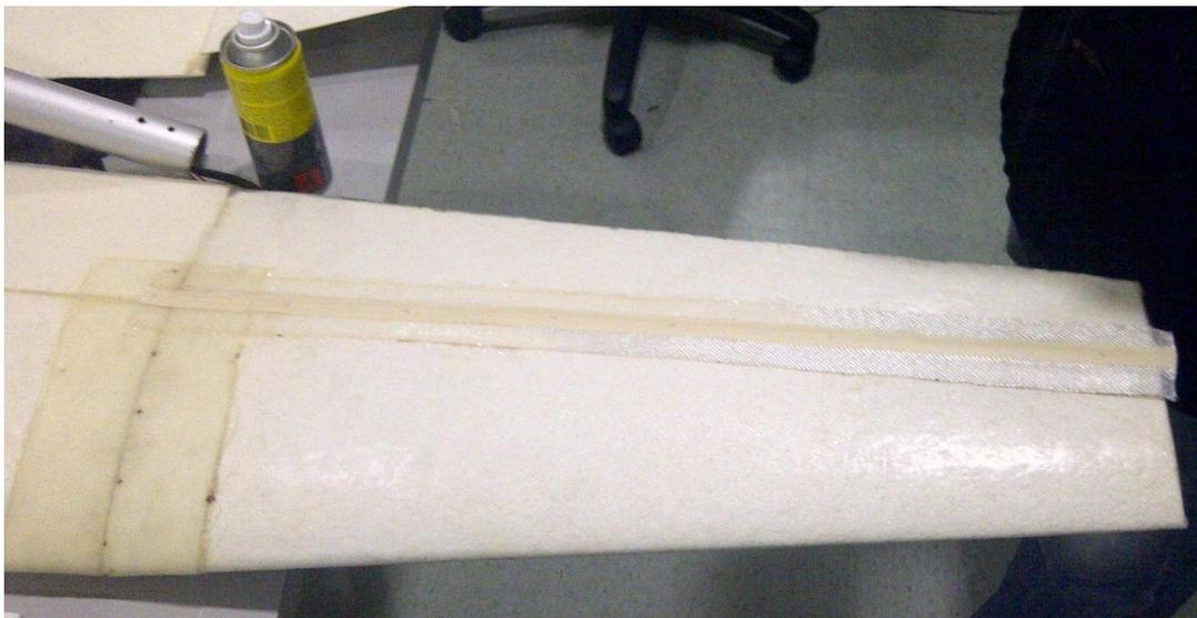
**Ilustración 244.- Reforzamiento de Juntas para Superficies de Control; Proyecto Galapagos UAV**
