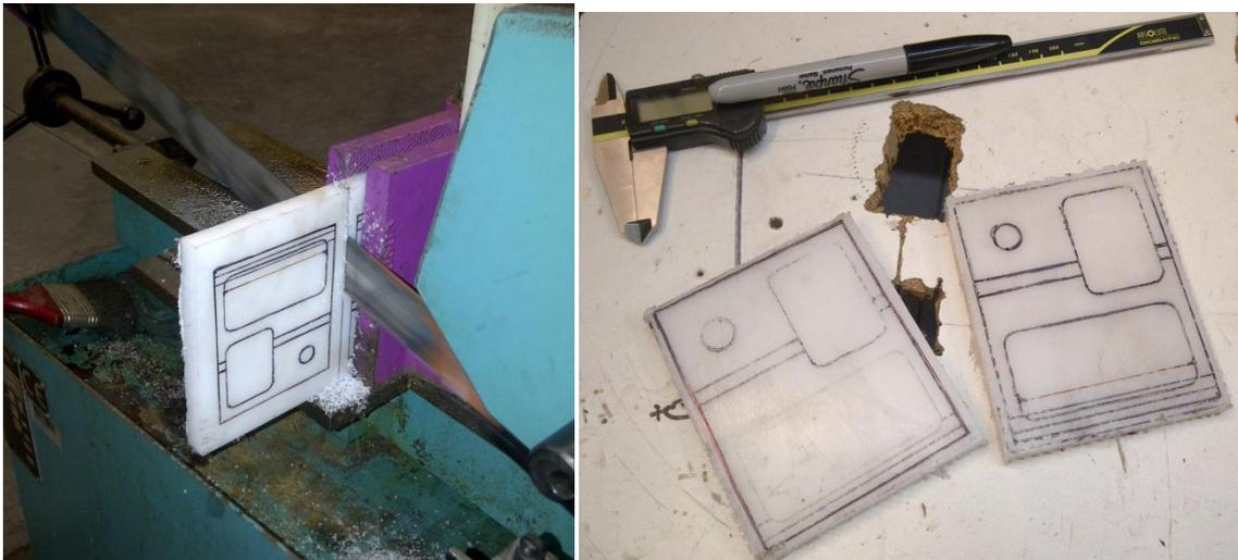
**Ilustración 108.- Separación de piezas para Soportes de Motor ENYA; Proyecto Galapagos UAV**
