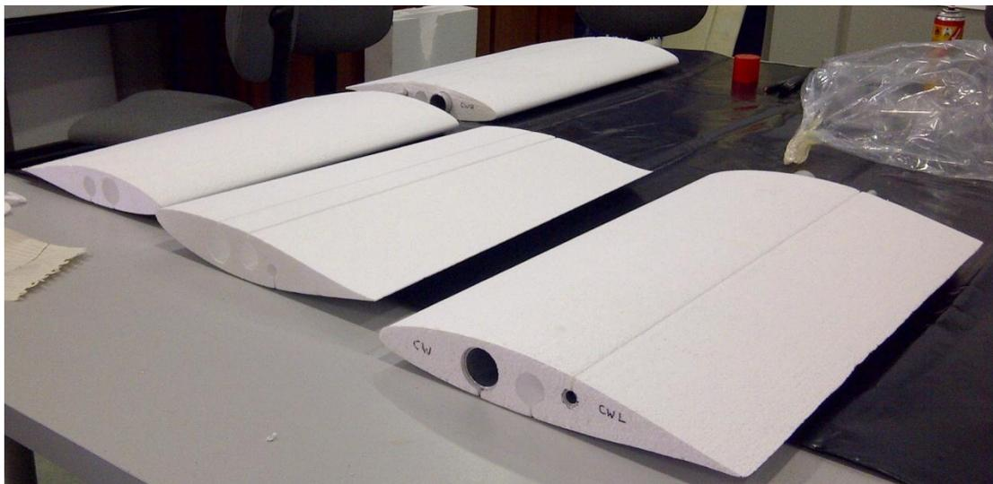
**Ilustración 153.- Piezas de secciones lijadas con superficie totalmente lisa; Proyecto Galapagos UAV**
