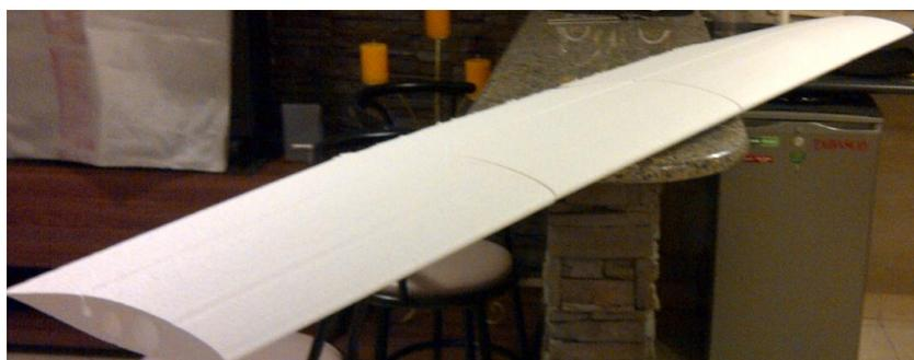
**Ilustración 151.- Ensamble Total del ala con Secciones I y II Derecha-Izquierda; Proyecto Galapagos UAV**
