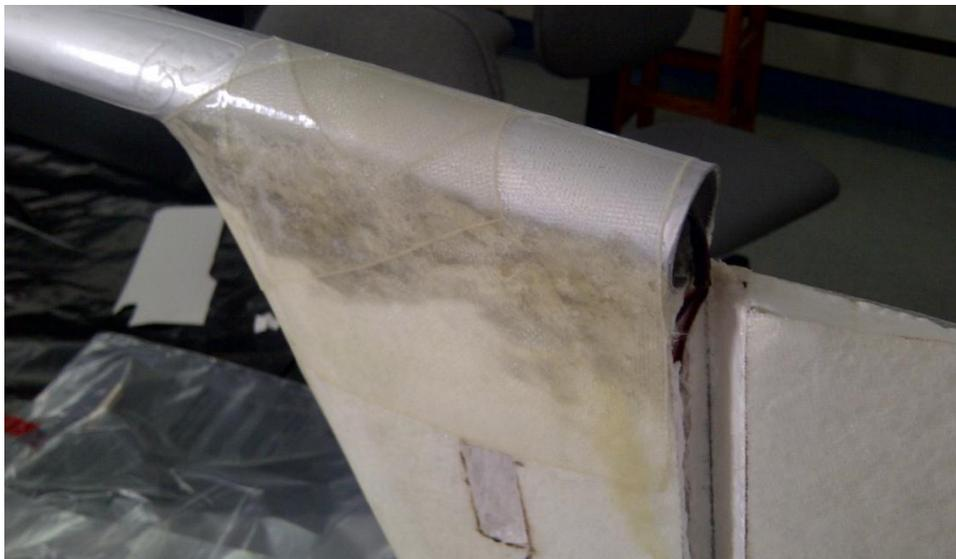
**Ilustración 212.- Resultado final de Junta de Cola y Tubería con Fibra Resinada; Proyecto Galapagos UAV**
