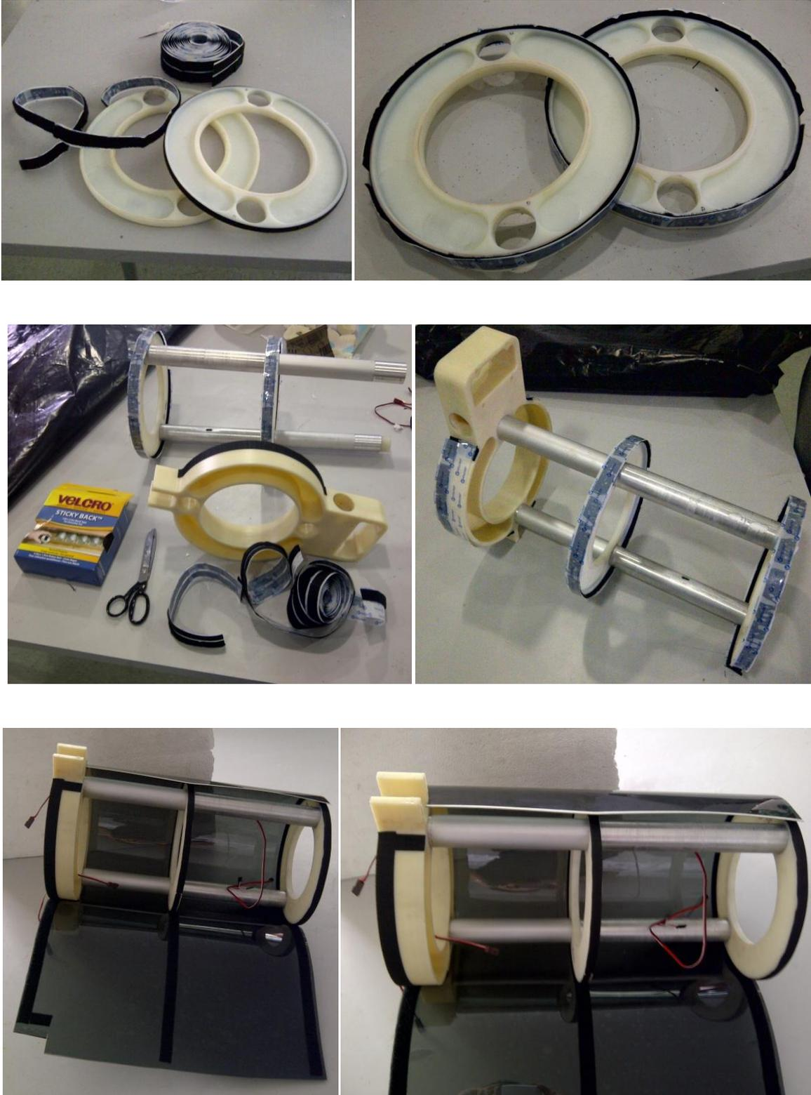
**Ilustración 237.- Proceso de Montaje de Fuselaje en Estructura del Prototipo; Proyecto Galapagos UAV**
