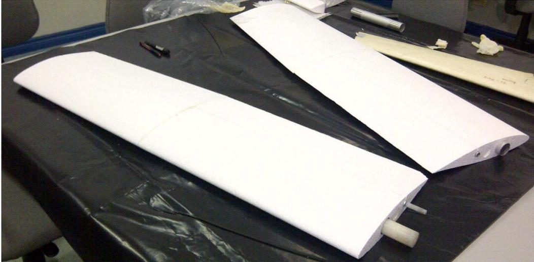
**Ilustración 155.- Adhesión de Secciones I y II para Ala Derecha e Izquierda; Proyecto Galapagos UAV**
