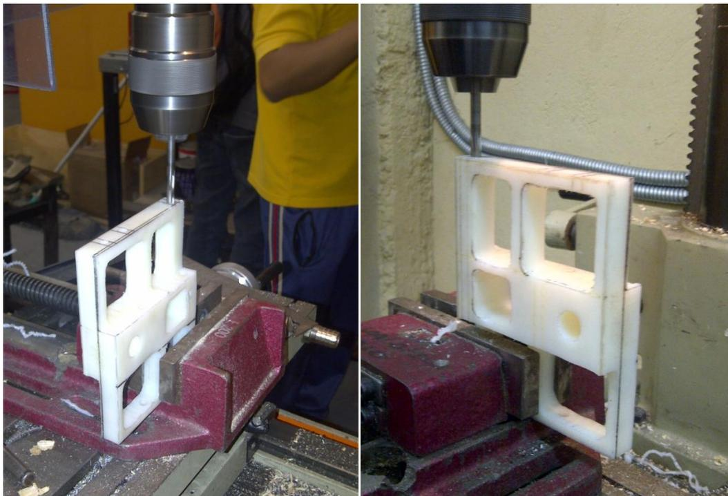
**Ilustración 127.- Taladrado de orificios de eje para Soporte Motor EVO-L; Proyecto Galapagos UAV**
