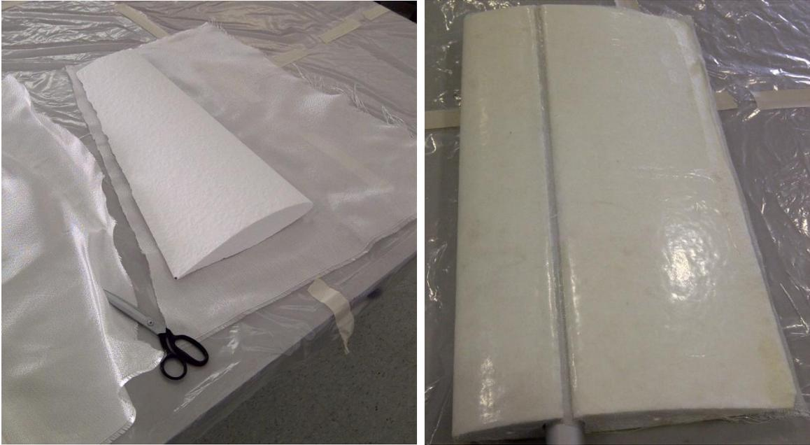
**Ilustración 25.- Corte de fibra de vidrio y ala revestida con fibra: Proyecto Galapagos UAV**
