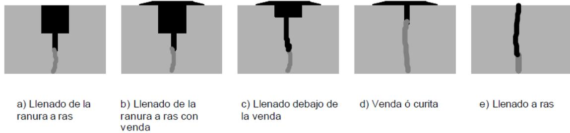
Los sellos tipo venda o curita deben de tener un espesor aproximado de 0.125 pulgadas (3 milímetros) y un ancho mínimo de 3 pulgadas (75 milímetros).
