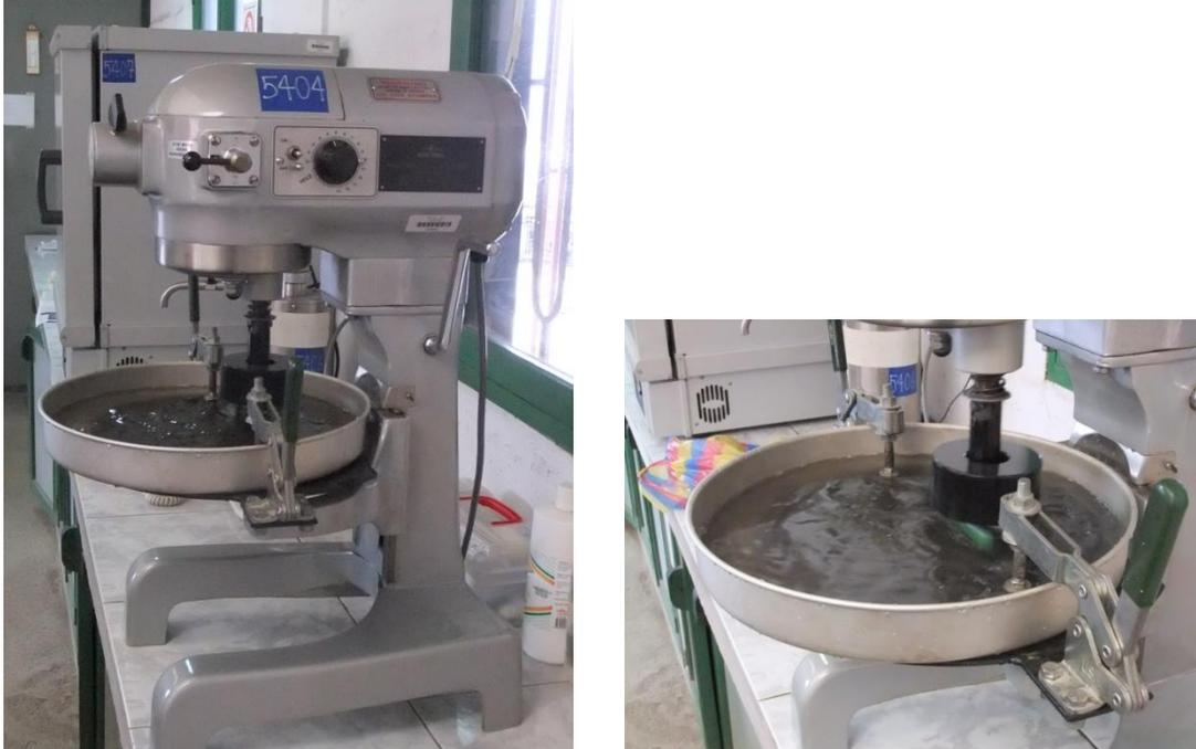
Figura 3.12 Ensayo de abrasión en húmedo (Ensayo de muestras)
