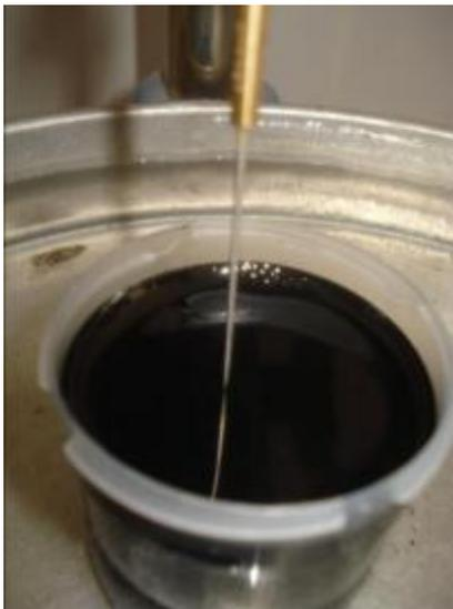
Figura 2.9 Aguja del penetrómetro haciendo un mínimo contacto con la muestra
