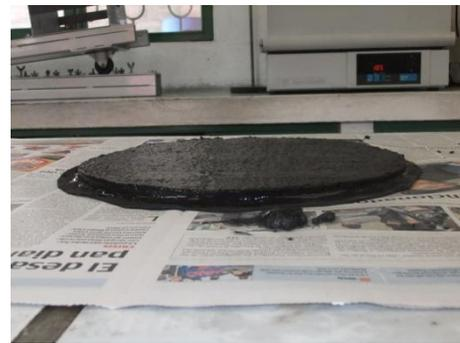
Figura 3.10 Muestra para determinar la abrasión en húmedo
