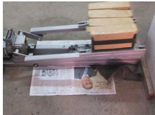
Figura 3.16 Equipo para ensayo de la rueda cargada (Fuente: <http://www.mastrad.com/lwt.htm>)
