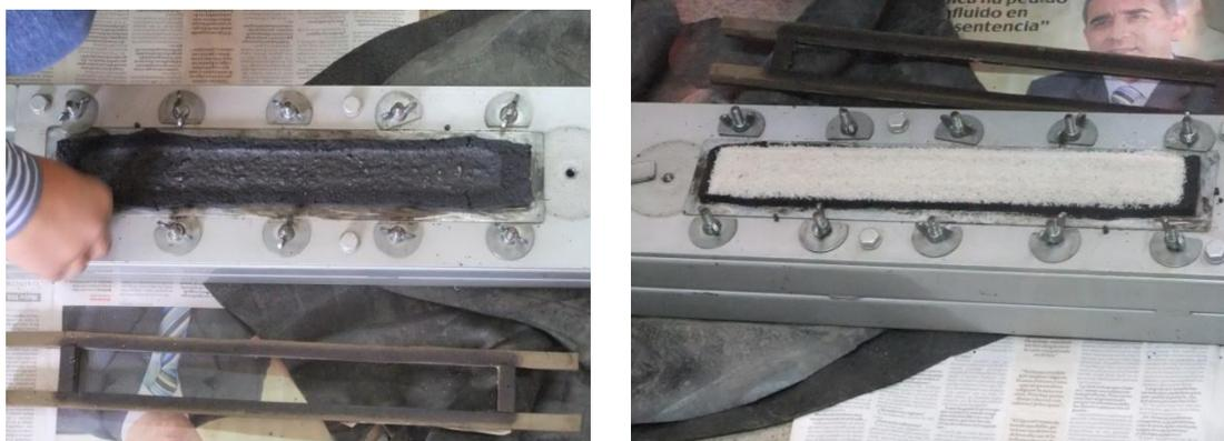
Figura 3.17 Colocación de la arena de Ottawa sobre la muestra ensayada
