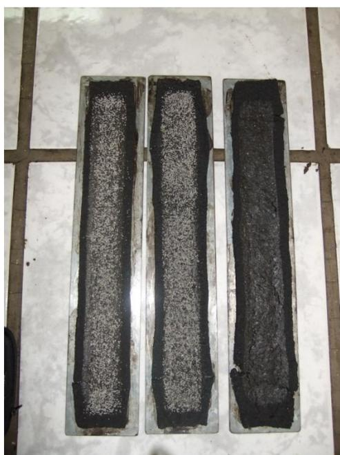
Figura 3.18 Prueba de la rueda cargada (Muestras ensayadas)
