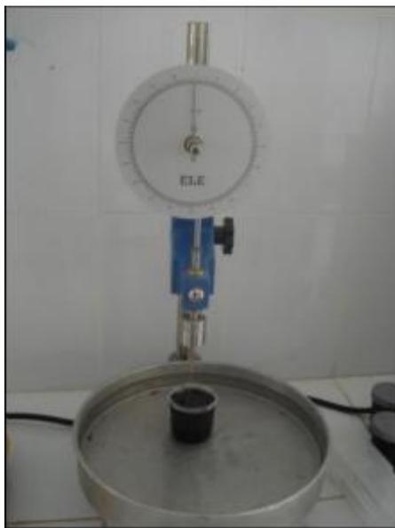
Figura 2.10 Equipo para determinar la penetración del residuo asfáltico
