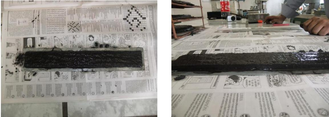
Figura 3.15 Muestras para ensayo de la rueda cargada
