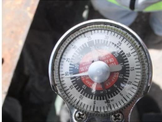
Figura 3.8 Resultado que muestra el cohesiómetro luego de ensayar la muestra
