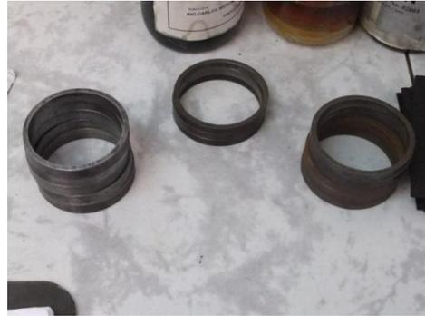
Figura 3.5 Diferentes espesores de aros metálicos para muestras de cohesión
