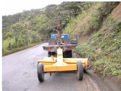
Figura 4.4 Diferentes tipos de barredoras mecánicas para limpieza de la vía.
