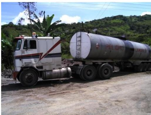
Figura 6.6 Tanquero con emulsión asfáltica
