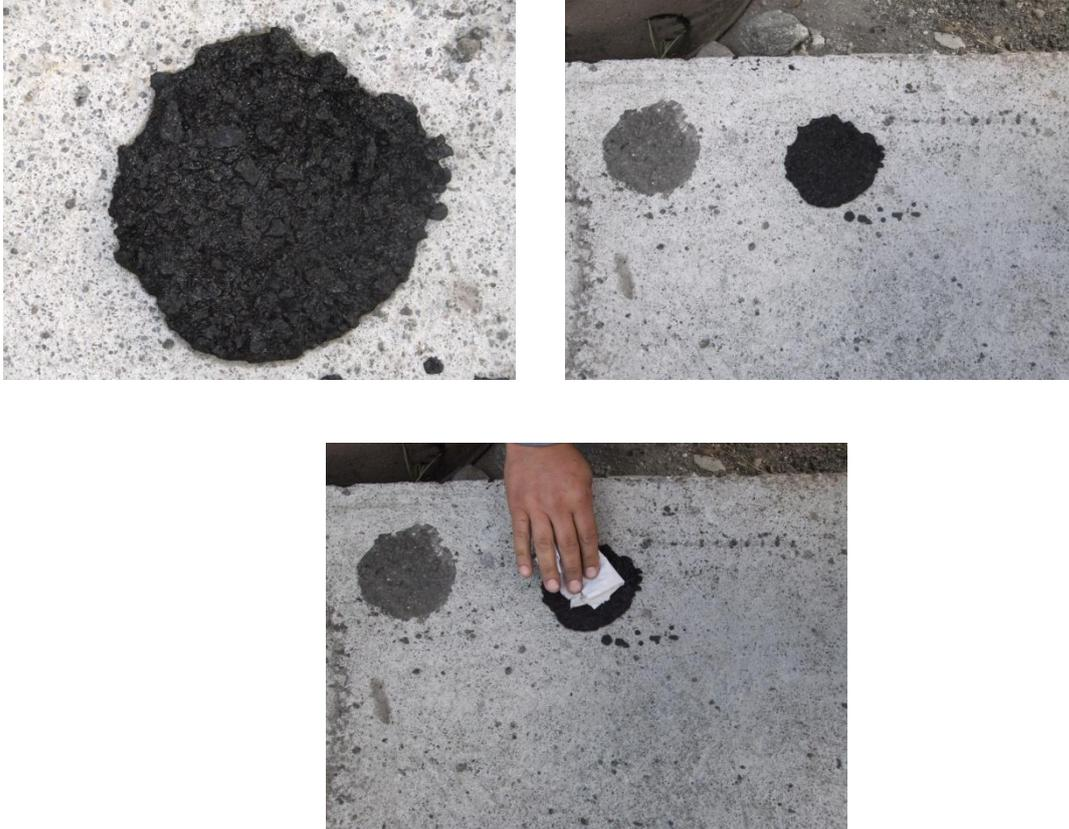
Figura 3.3 Control de liberación de agua de la mezcla.
