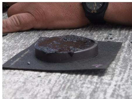
Figura 3.6 Muestras para ensayo de cohesión
