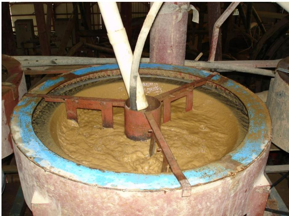
**Figura 3.10** Concentrador centrifugo utilizado en el distrito minero de Nambija, provincia de Zamora Chinchipe, Ecuador. Fotografía tomada en una salida de campo realizada en julio del 2010.
