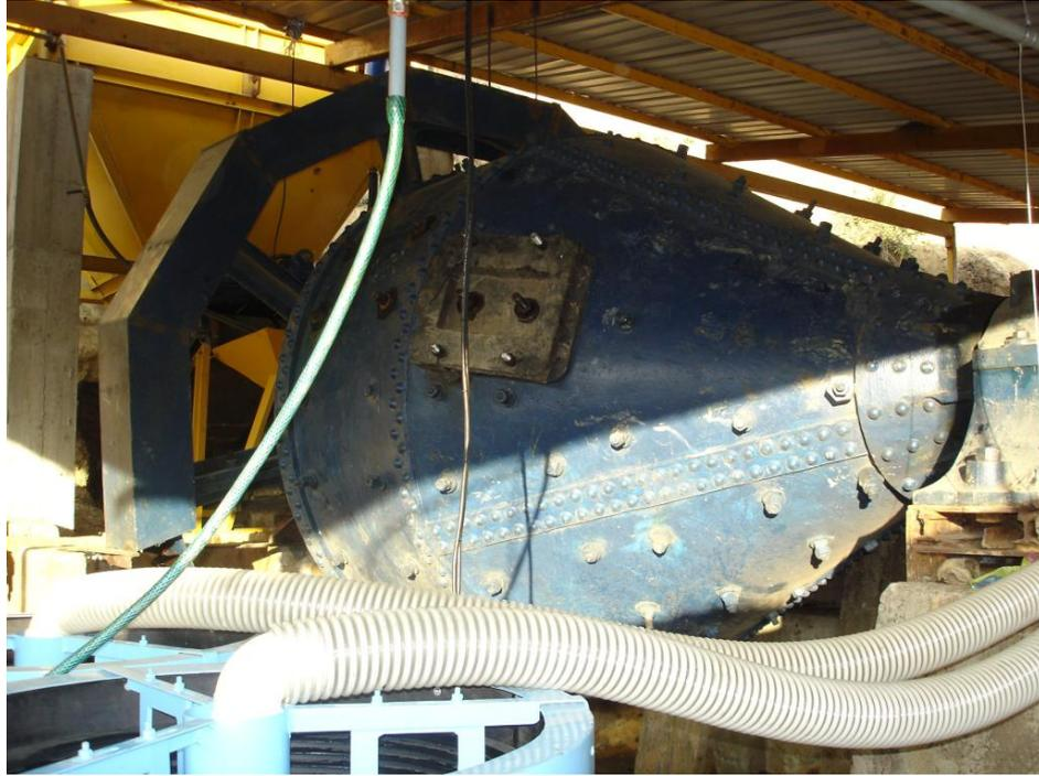
**Figura 3.6** Molino de bolas utilizado en el distrito minero de Portovelo, provincia de El Oro, Ecuador. Fotografía tomada en una salida de campo realizada en julio del 2010.
