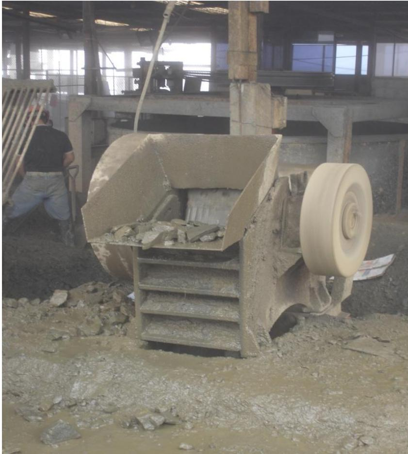
**Figura 3.5** Trituradora de mandíbulas usado en la Compañía Minera Sominur, para transportar el mineral de la mina a la planta de tratamiento. Fotografía tomada en una salida de campo realizada en julio del 2011.
