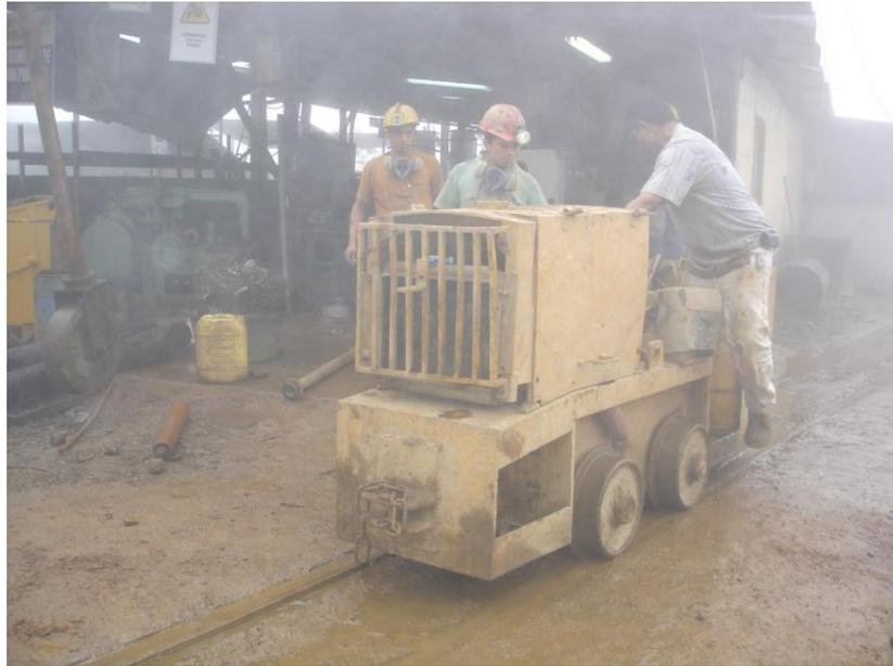
**Figura 3.4** Locomotora usada por la Compañía Minera Sominur S.A., para movilizar las vagonetas fuera de la mina. Fotografía tomada en una salida de campo realizada en julio del 2011.
