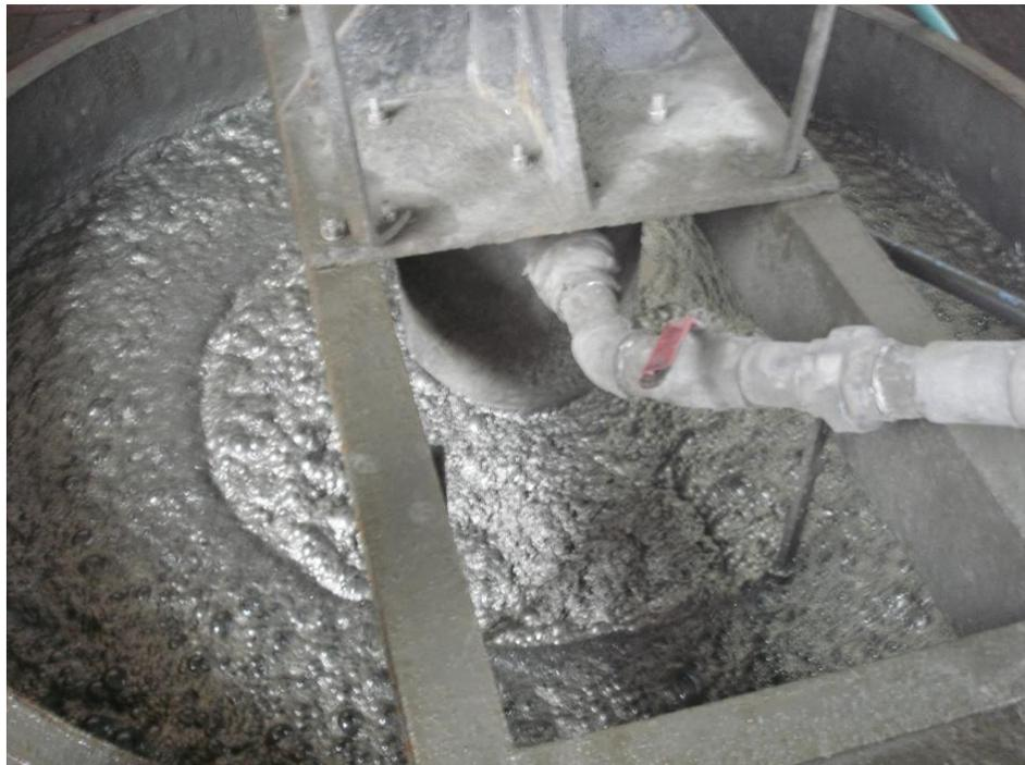
**Figura 4.3** Espuma de flotación que contiene el metal precioso, proceso usado en la empresa Sominur. Fotografía tomada en salida de campo realizada en junio 2011.
