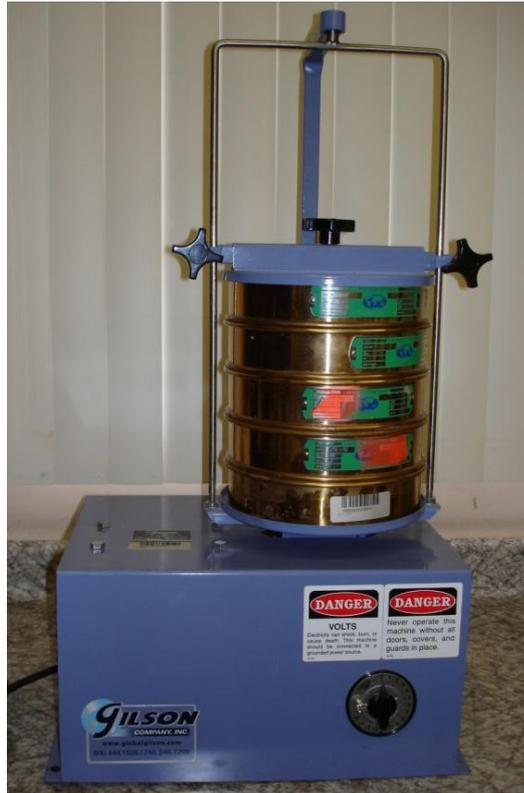
**Figura 3.9** Tamiz vibratorio. Fotografía tomada en el laboratorio de Química USFQ.
