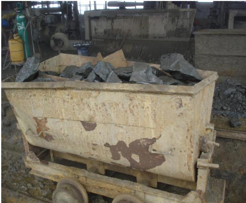
**Figura 3.3** Vagón usado por la Compañía Minera Sominur S.A., ubicada en el distrito minero Bella Rica, provincia del Azuay, Ecuador, para transportar el mineral de la mina a la planta de tratamiento. Fotografía tomada en una salida de campo realizada en julio del 2011.
