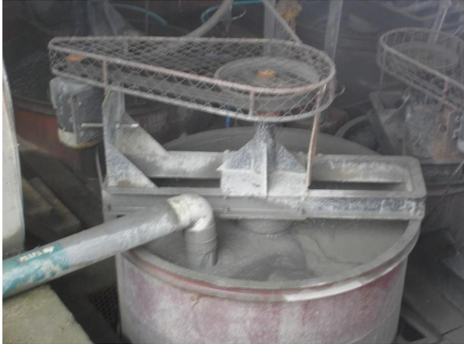
**Figura 4.2** Tanque de flotación usado en la empresa Sominur. Fotografía tomada en salida de campo realizada en junio 2011.
