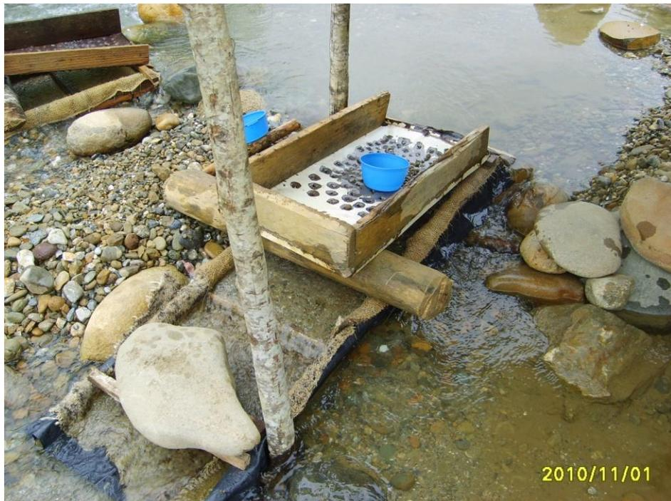
**Figura 3.7** Tamizado rudimentario a las riberas del río Amarillo en la zona de Zaruma. Fotografía tomada en una salida de campo realizada en noviembre del 2010.
