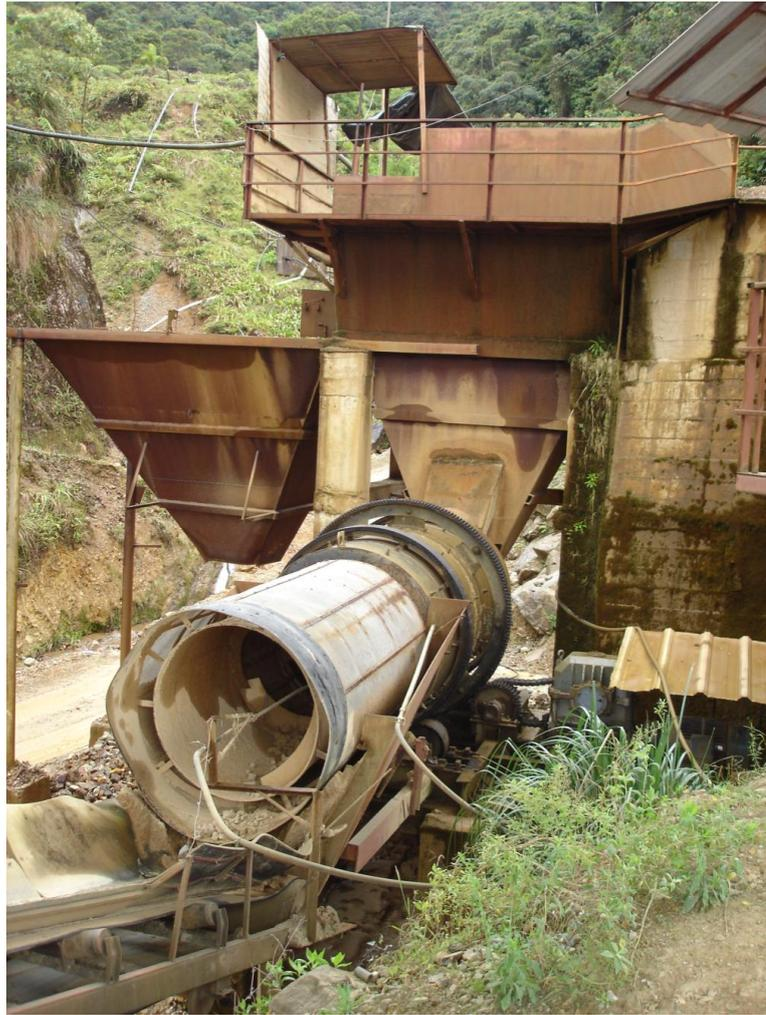
**Figura 3.8** Trommel usando para separar el material grueso del fino en el distrito minero de Guayzimi, provincia de Zamora Chinchipe, Ecuador. Fotografía tomada en una salida de campo realizada en julio del 2010.
