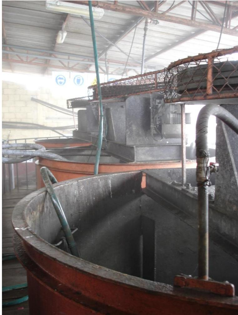
**Figura 3.11** Tanques de cianuración usados para la disolución de oro por la empresa Sominur. Fotografía tomado en una salida de campo realizada en junio del 2011.
