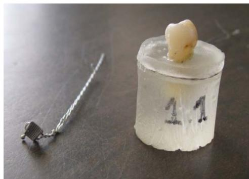
**Ilustración 43. Muestra del bracket al ser despegado de la superficie vestibular de la corona por la maquina.**
