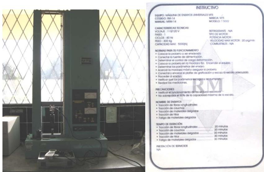
Ilustración 40. A) Máquina de ensayos universales MTS modelo T-5002, B) Especificaciones de la máquina.
