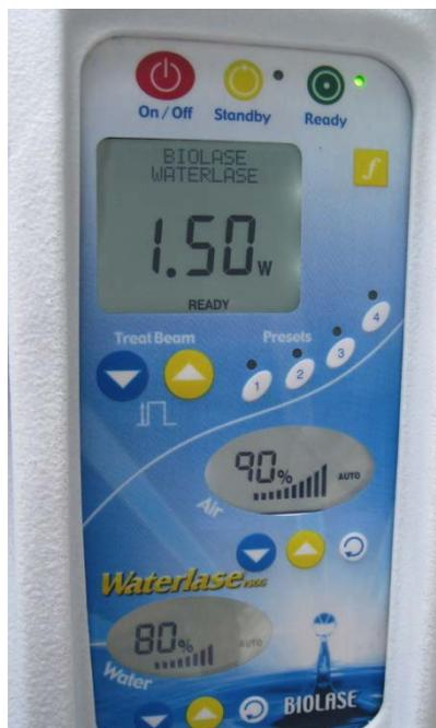
Ilustración 27. Láser Er,Cr:YSGG (Waterlase, Biolase Technology Inc, Germany) con una potencia de 1,5 w, 90% de aire y 80% de agua.
