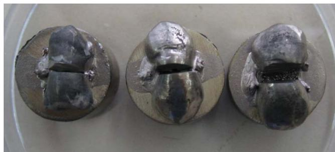
**Ilustración 33. Muestras después del baño de oro y paladio.**
