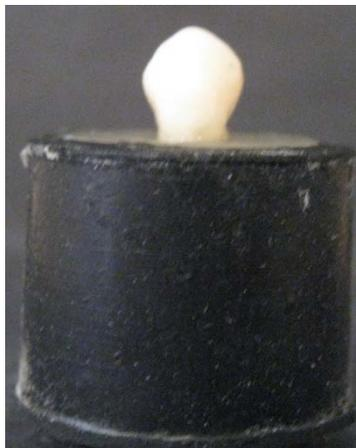
**Ilustración 20.** Diente sumergido en elacrílico hasta la línea amelocementaria.
