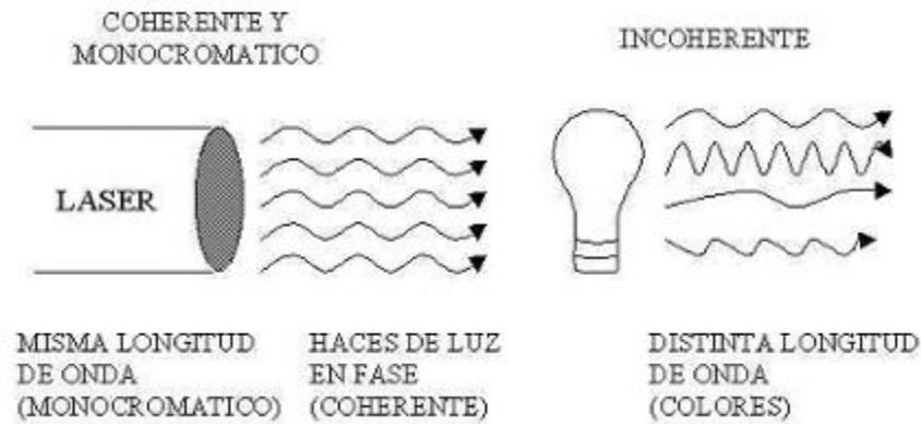
Ilustración 3. Monocromaticidad y coherencia del rayo láser <sup>23</sup>.
