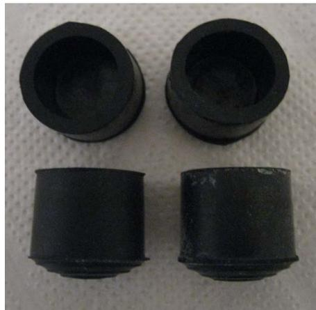
**Ilustración 19.** Dispositivo de goma utilizado como molde para los pedestales deacrílico de las muestras
