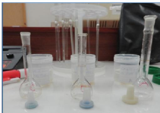
A través de pipetas de vidrio se sacó del grupo 1: 1A, 1B y 1C, la cantidad de 1 ml de saliva artificial en una disolución de 25 ml de agua destilada, para realizar el análisis de calcio mediante el espectrofotómetro.
