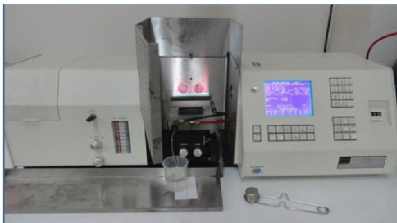
Los átomos al excitarse absorben la radiación, la cual fue cuantificada por el detector fotomultiplicador que genera una corriente eléctrica. La radiación absorbida está en relación con la concentración del elemento químico que se desea cuantificar mediante la ley de Lambert-Beer:
