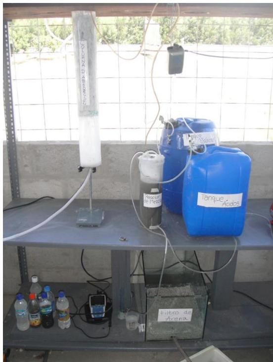
Foto 1. Sistema de tratamiento de aguas residuales a escala piloto
