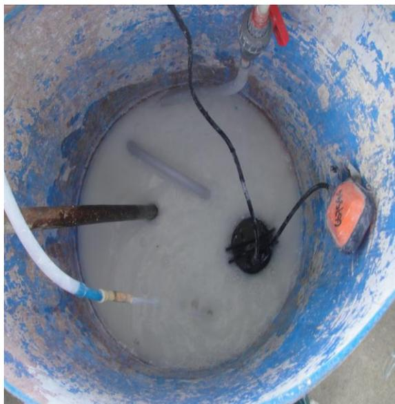
Foto 2. Lechada de cal y bomba sumergible
