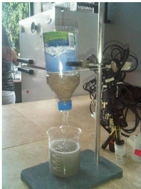
**Figura 5 Filtración del efluente tratado a escala laboratorio, determinación del volumen de lodos generados en el proceso**
