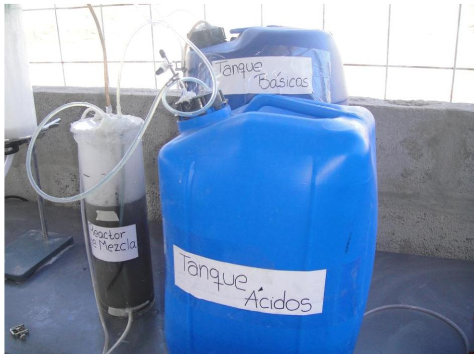
Foto 4. Tanques de almacenamiento de ácidos y básicos, reactor mezcla.
