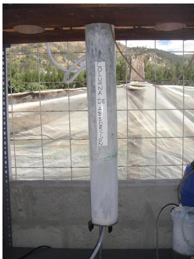
Foto 6. Columna de absorción de sulfuros
