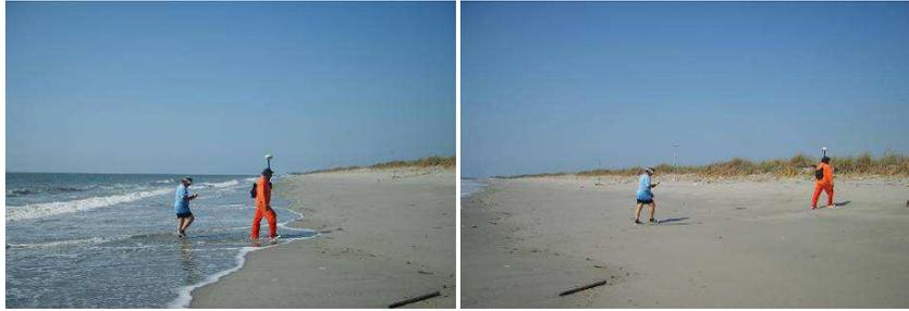
**FOTOS 9 y 10.- Levantamiento de perfiles de playa en la zona Intermareal y detrás de la berma con la utilización del sistema DGPS en modo RTK.**
