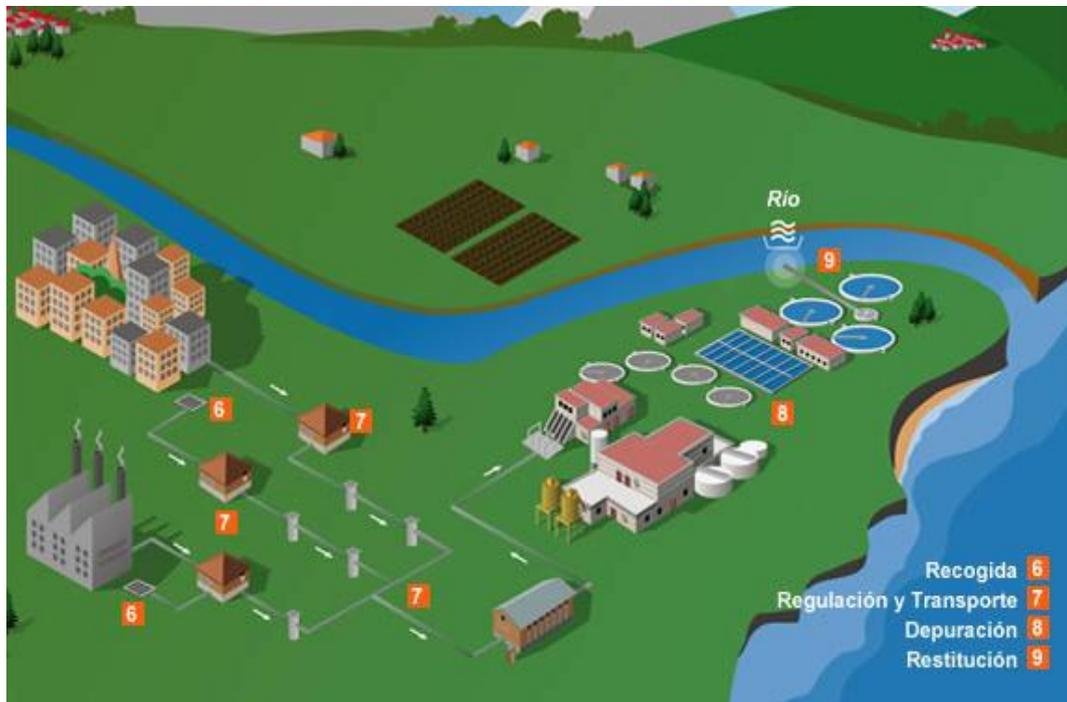
Fig. 14: Sistema de Alcantarillado<sup>3</sup>
