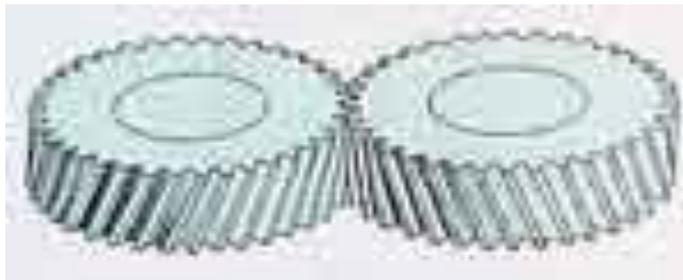
Los engranes helicoidales, tienen dientes curvos cortados en ángulo con respecto a su eje de rotación, su curva se asemeja a la rosca de un tornillo, la superficie de contacto, entre los dientes es mayor que en los engranes de dientes rectos. Con este tipo de engranes, la potencia se transmite más suave y silenciosa.
