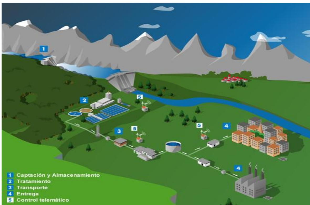
Fig. 12 Sistema de Agua Potable<sup>2</sup>
