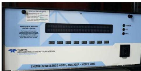
**Analizador de NO<sub>x</sub> (Dióxido de nitrógeno):** El analizador 200E API Teledyne está certificado por la EPA Norteamericana con el método de referencia para la medición de NO<sub>x</sub> (RFNA-1194-099)
