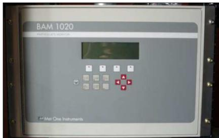
**Analizador material particulado:** El BAM 1020 consiste en tres componentes básicos, el detector/adquisidor, la bomba y la toma de muestras. Cada uno de estos componentes son independientes y pueden ser fácilmente desmontados para mantenimiento o reemplazo. El BAM 1020 está certificado por la EPA Norteamericana como método equivalente para la medición de partículas PM<sub>10</sub> (EQPM-0798-122).
