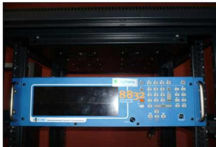
**Datalogger ESC 8832 para uso de calidad del aire:** este es un dispositivo sofisticado y diseñado exclusivamente para adquisición, gestión y manejo de señales entregadas por los analizadores de gases, así como para tareas de validación y programación.
