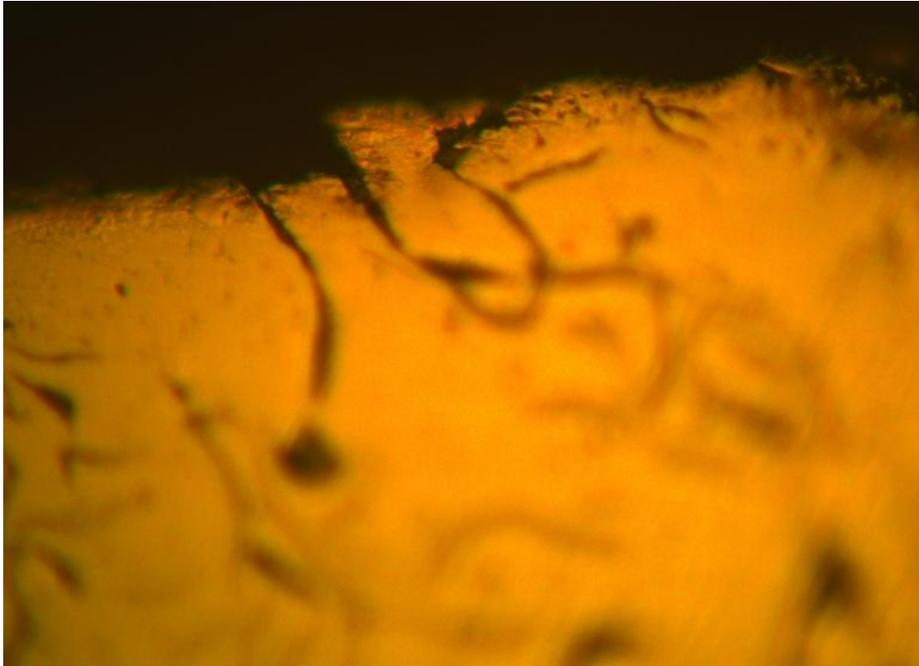
**Figura 4.21** Metalografía arista longitudinal material Fundición de hierro con aleación de Níquel, 1 hora de boronizado (850°C) 500x
