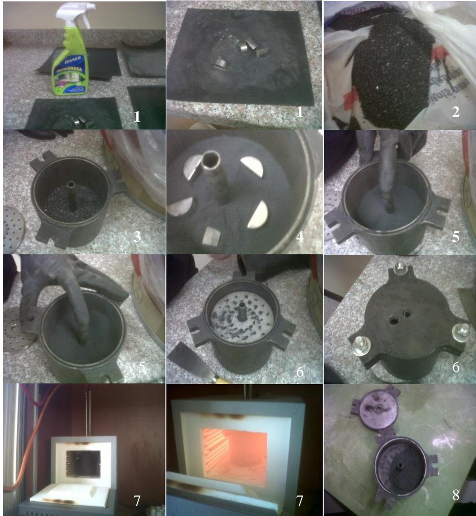
**Figura 3.16** Procedimiento para la preparación de boronizado
