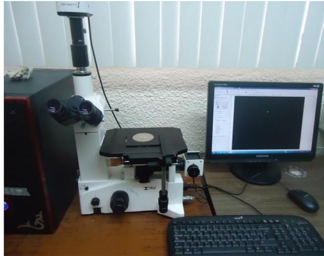
**Figura 3.23** Microscopio Metalográfico
