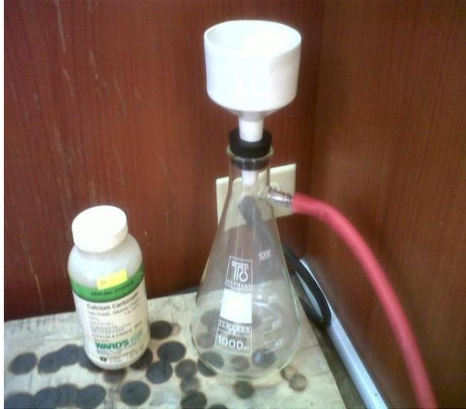
**Figura 3.9** Sistema de absorción para salida de gases
