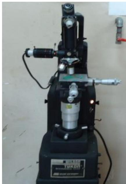
**Figura 3.18** Microdurómetro Tukon
