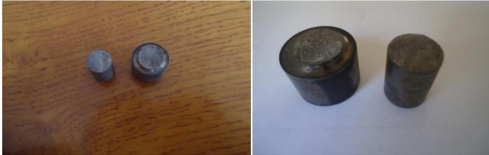
**Figura 5.6** Pin roto de AISI AO1- 5 horas de boronizado, temple y revenido
