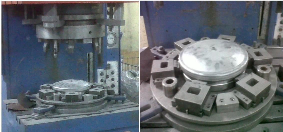
**Figura 5.2** Máquina troqueladora Umco para ollas de presión
