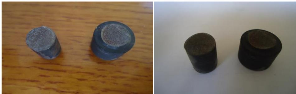
**Figura 5.5** Pin roto de AISI AO1- 5 horas de boronizado y temple
