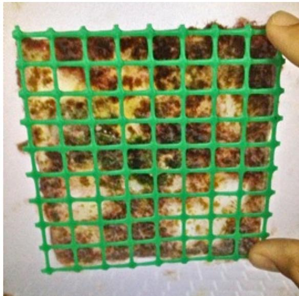
**Figura 2.** Foto de una placa blanca con la malla verde sobrepuesta. El uso de esta malla permite estimar, mediante el conteo de las intersecciones, la abundancia de organismos que crecen en la placa sustrato.
