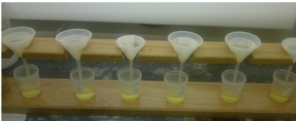
Figura No 3.4 Filtración y almacenamiento de muestras digeridas
