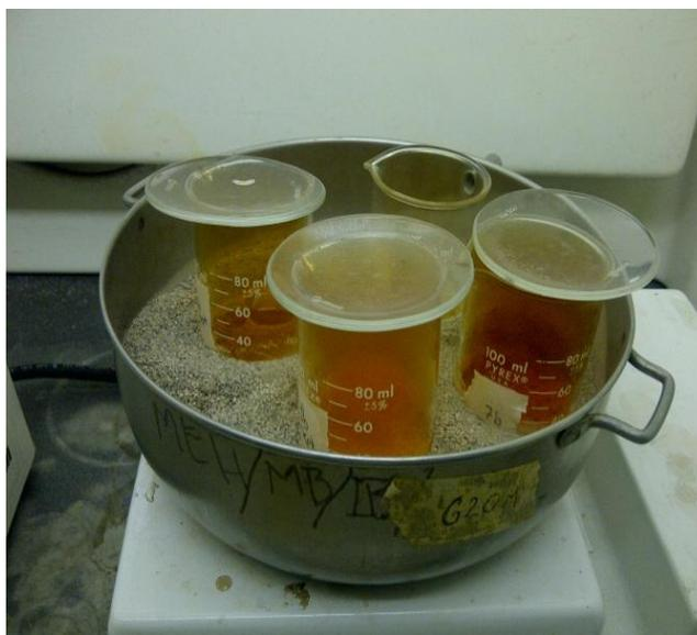
Figura No 3.1 Aparición de humos de óxidos de nitrógeno
