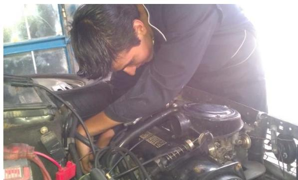
**Foto 5 Retiro de Cables y Bujías**
