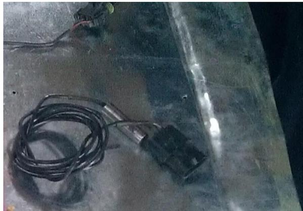
Foto 3 Sensor de Posición de Cigüeñal
