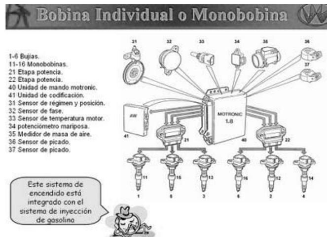
7 Esquema Sistema Monobobina
