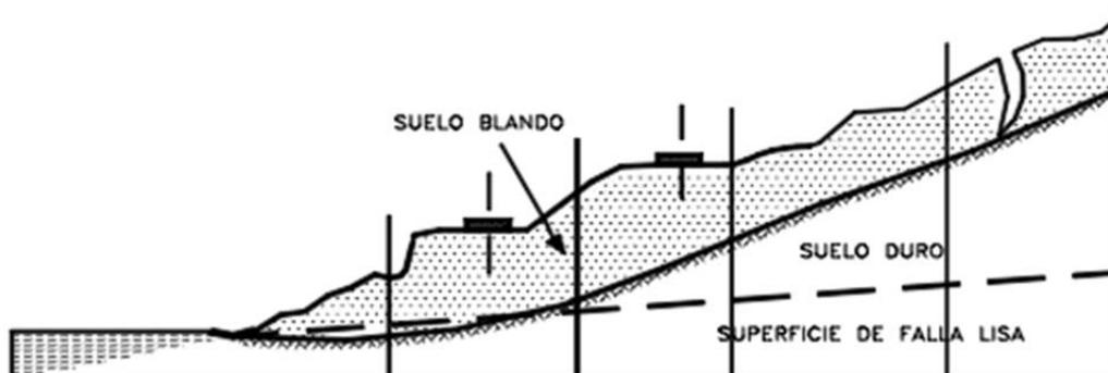
Ilustración 16, Deslizamientos de translación
