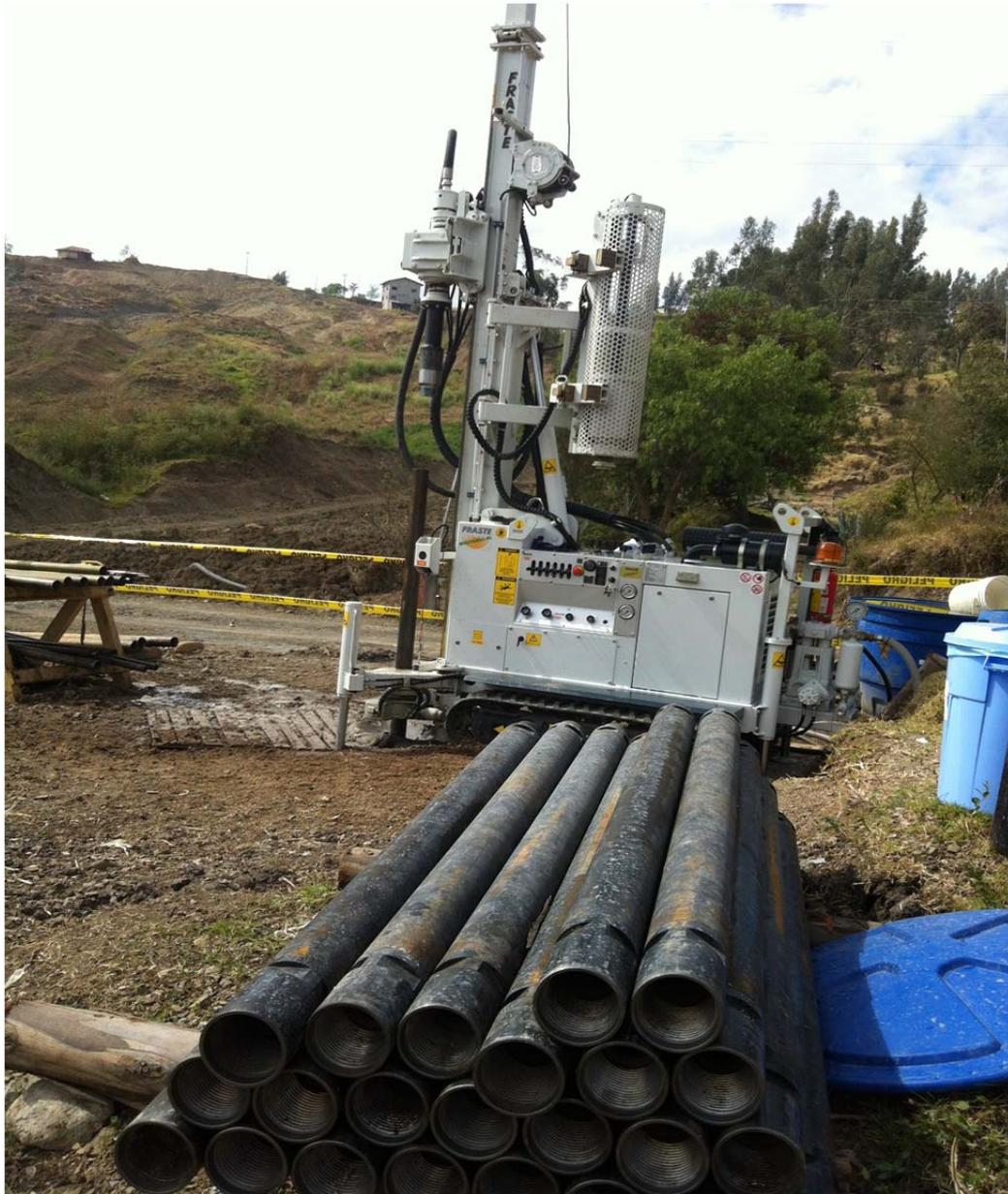
Ilustración 39, Maquina perforación y ensayo SPT
