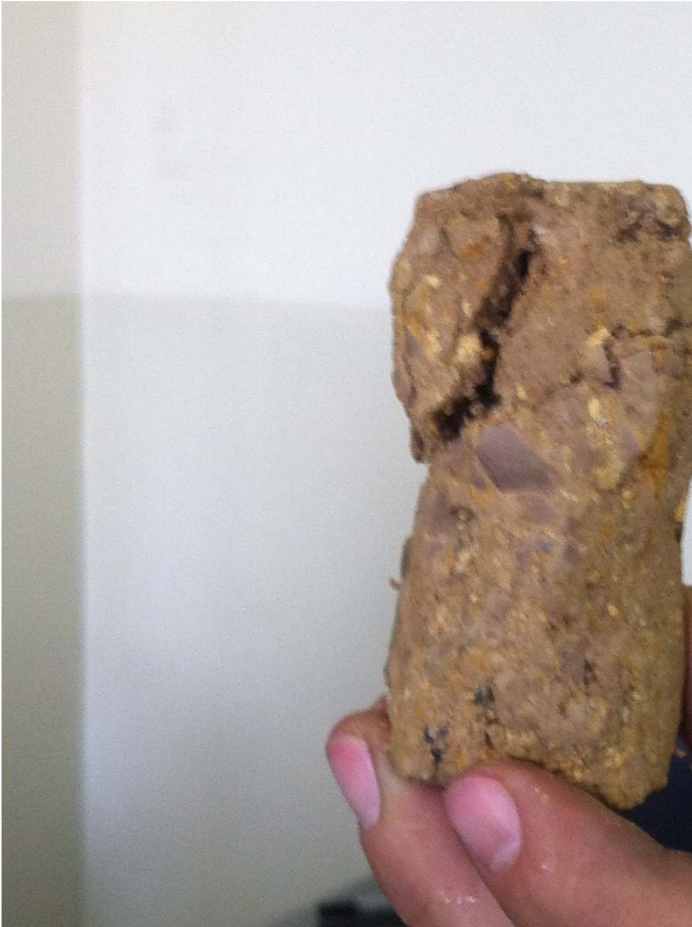
Ilustración 52, Espécimen de ensayo triaxial fracturado
