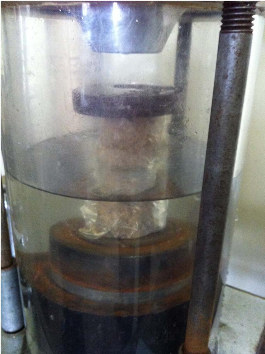
Ilustración 51, Apertura de válvulas de agua en ensayo triaxial
