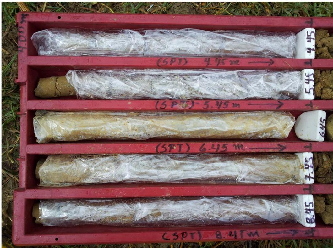
Ilustración 43, Muestreo perforaciones (muestras humedad) NULTI
