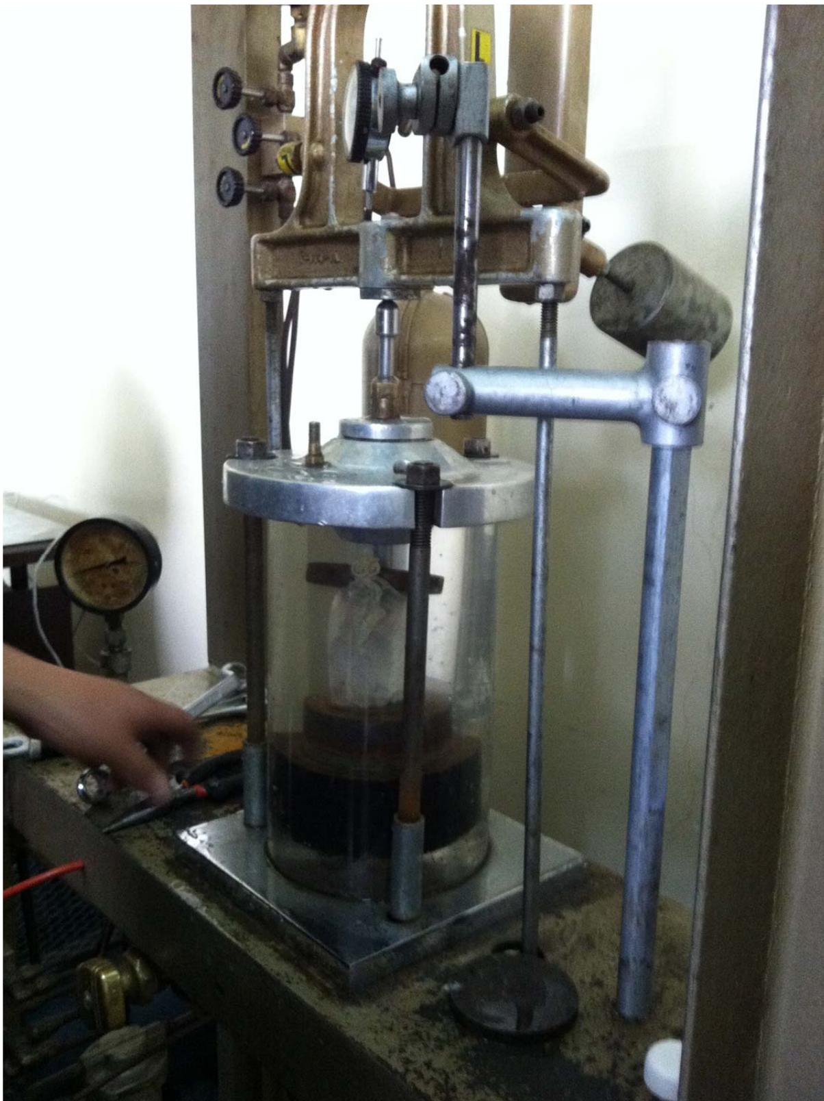
Ilustración 49, Probeta 1 sometida a presión hidrostática del agua
