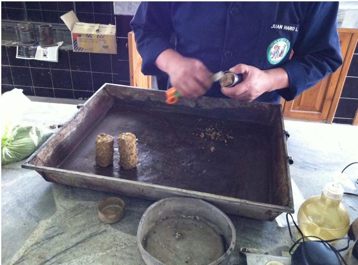
Ilustración 47, Tallado de probetas cilíndricas para ensayo triaxial
