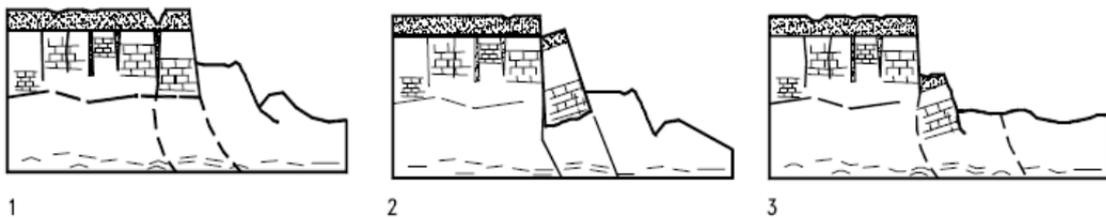
Ilustración 23, Deslizamientos retrogresivos
