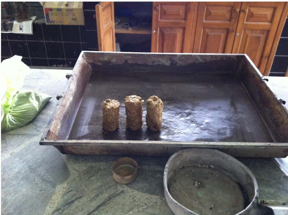
Ilustración 48, Probetas cilíndricas para ensayo triaxial
