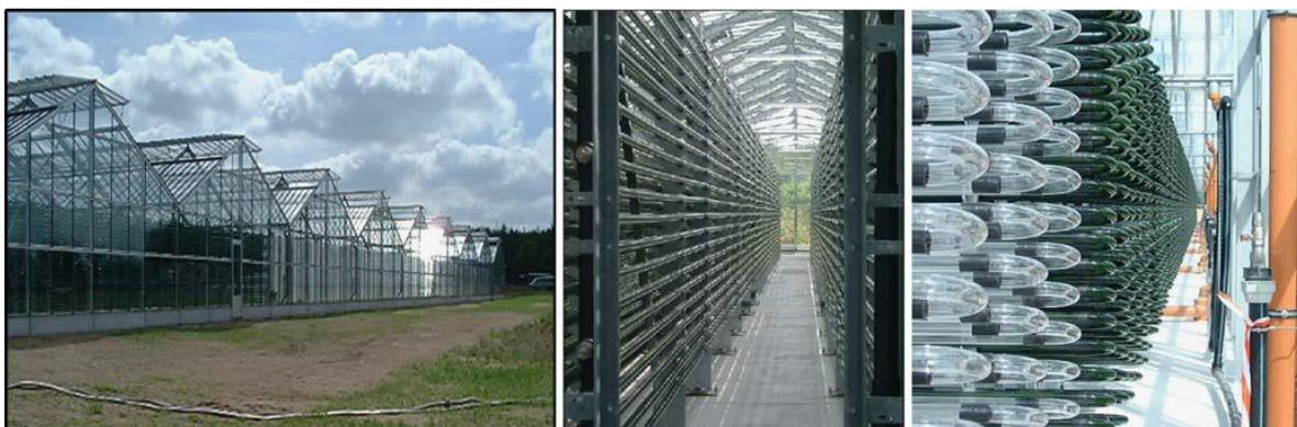
**Figura 4.** Sistema de biorreactor cerrado. El fotobiorreactor cerrado más largo del mundo en Klötze, Alemania, 700 m<sup>3</sup> están distribuidos en 500 km de tubos y producen hasta 100 toneladas de microalgas por año. Fuente: Schenk y colaboradores (Schenk, y otros, 2008).
