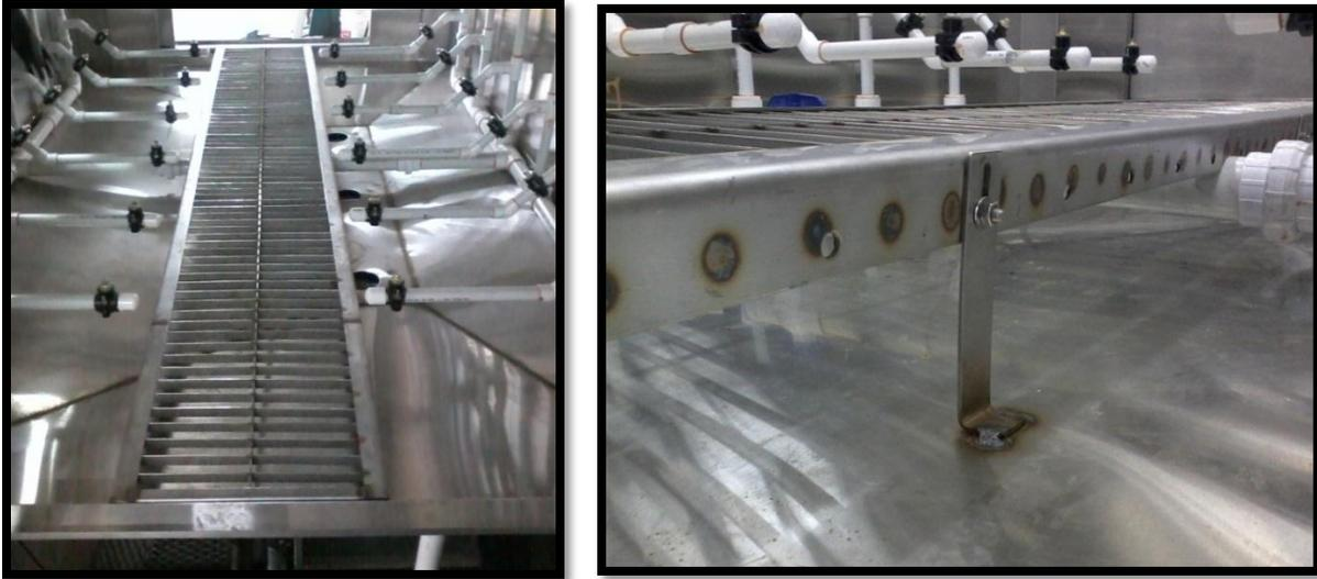
Figura 4.15: Caminadora dentro de la cámara de lavado y tensores para corregir el desnivel del sumidero.
