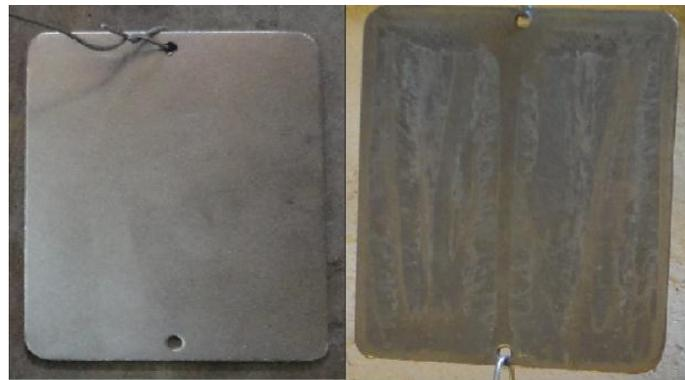
Figura 1.2: Cambio de color y textura durante la prueba de aplicación de fosfato de zinc de forma manual en la planta AICO
