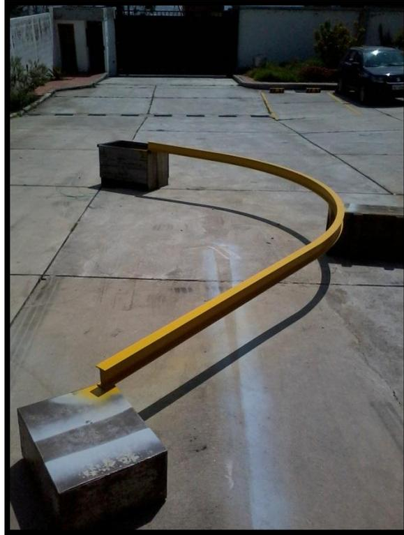
Figura 4.16: Viga transportadora tipo IPE100 con su proceso de barolado.
