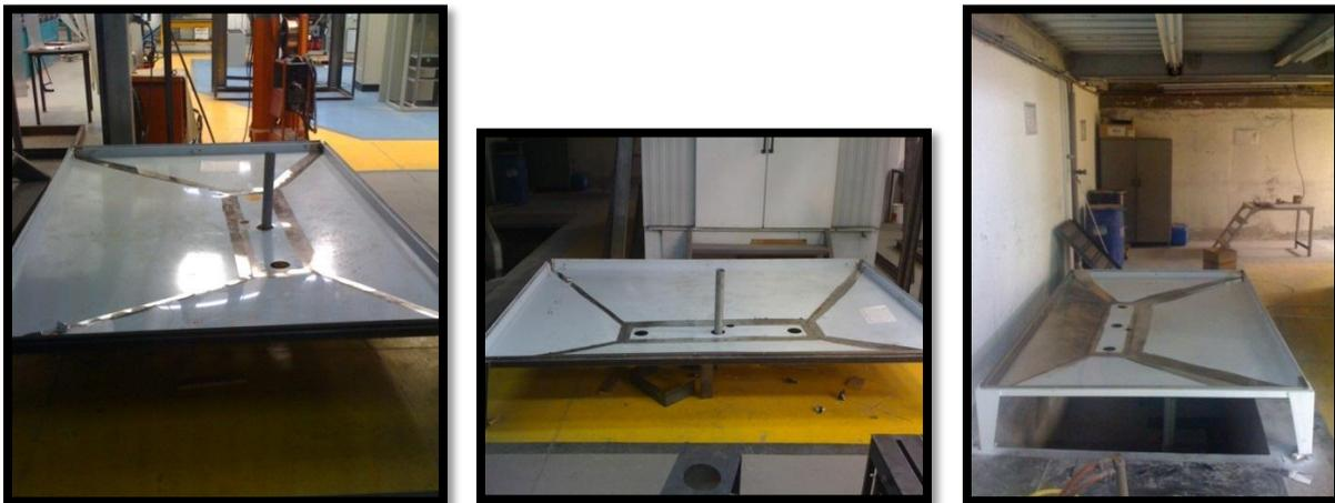
Figura 4.8: Sumidero soldado afuera y colocado luego en la base cabina.
