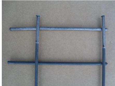
Figura 1.1: Cambio de color y textura en la aplicación de fosfato de zinc en un metal
