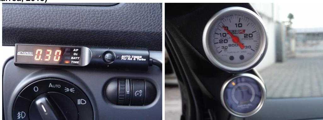
**Ilustración 10: Turbo Timer - Boost - Indicador relación mezcla**
