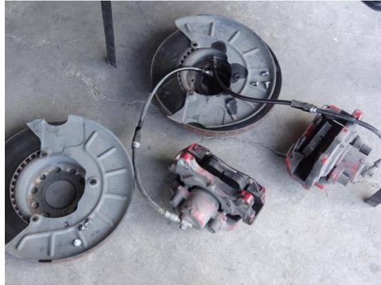
**Ilustración 39: Mordazas, discos y cañerías desmontadas**
