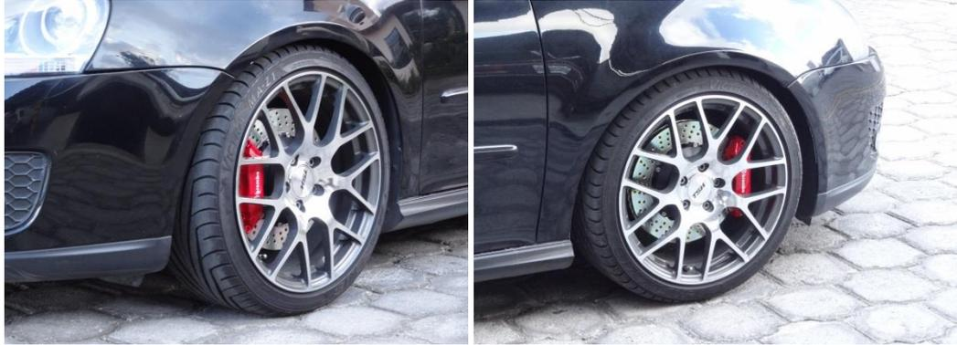
**Ilustración 43: Frenos Brembo instalados**
