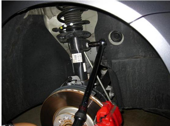
**Ilustración 34: Remoción amortiguador delantero**
