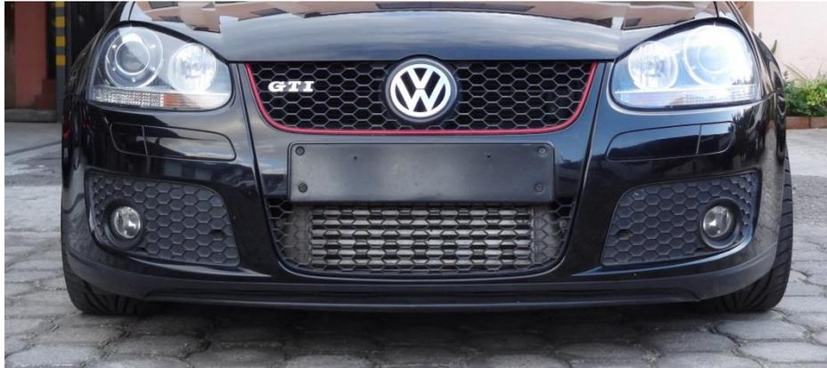
**Ilustración 15: Intercooler Garrett instalado**
