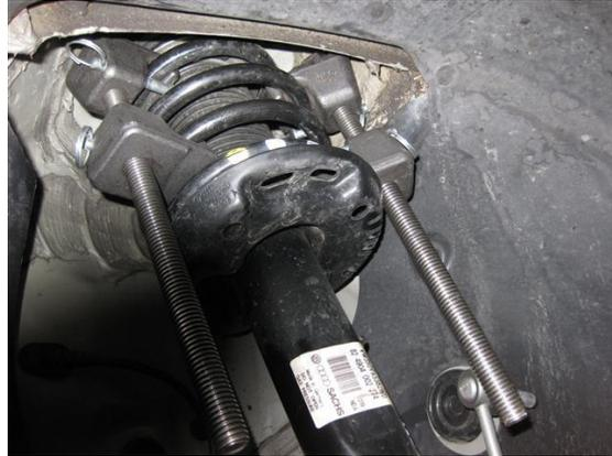
**Ilustración 33: Compresor de espirales**
