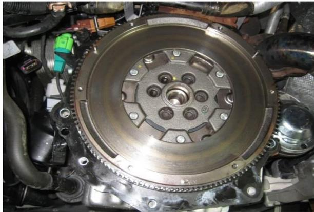
**Ilustración 22: Volante de inercia de aluminio SPEC**
