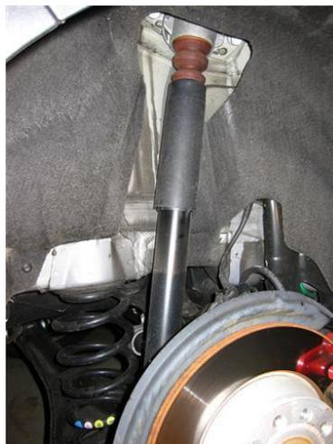
**Ilustración 31: Remoción amortiguador posterior**
