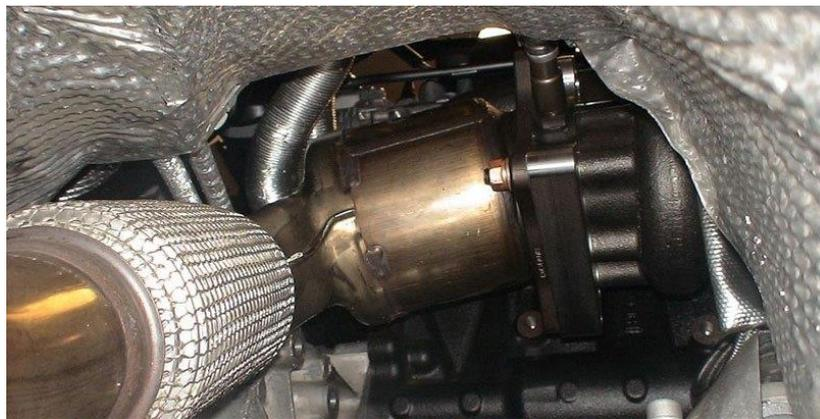
**Ilustración 6: Tubo de escape y turbina**
