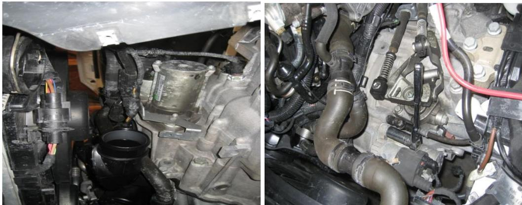
**Ilustración 19: Remoción motor arranque y cableado principal**
