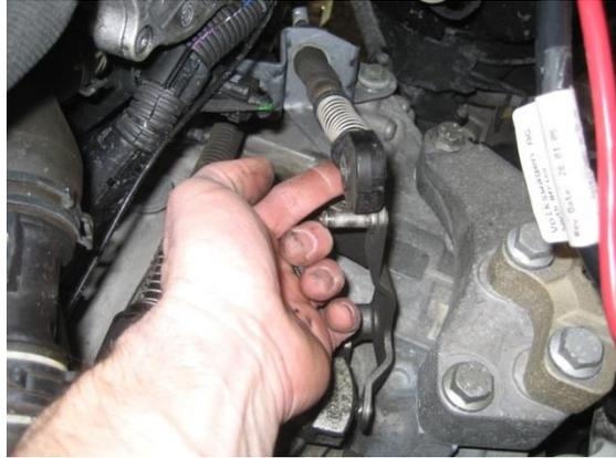
**Ilustración 20: Remoción cables de transmisión-palanca de cambios**
