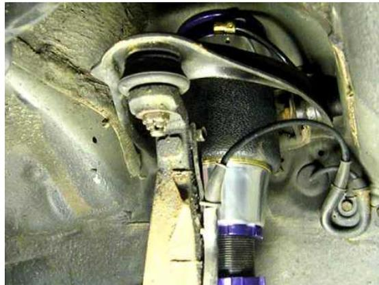
**Ilustración 32: Suspensión D2 posterior instalada**
