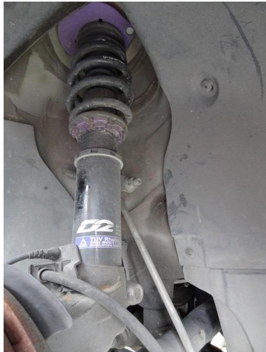
**Ilustración 36: Suspensión D2 delantera instalada**
