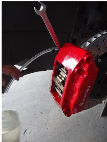
**Ilustración 42: Purgado del sistema de frenos**
