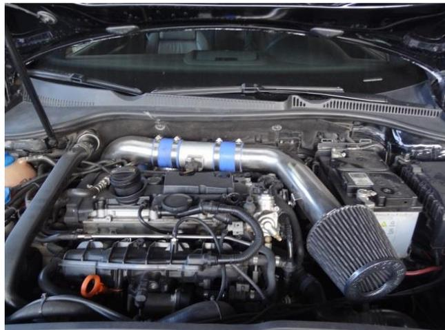
**Ilustración 9: Turbo Garrett instalado**
