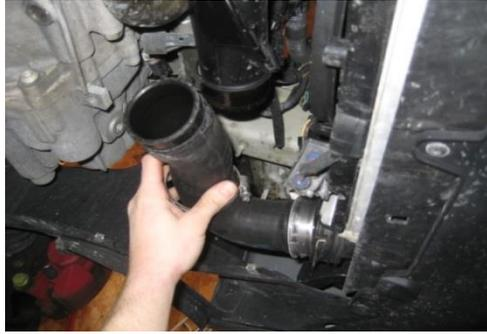
**Ilustración 18: Remoción tuberías del intercooler**
