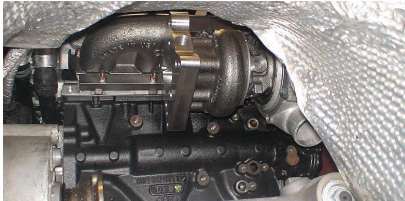
**Ilustración 7: Protector de calor**
