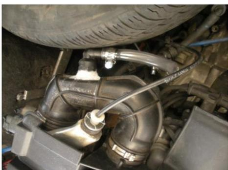
La cañería de salida del gas (hidrógeno) debe ir conectada al múltiple de admisión.
