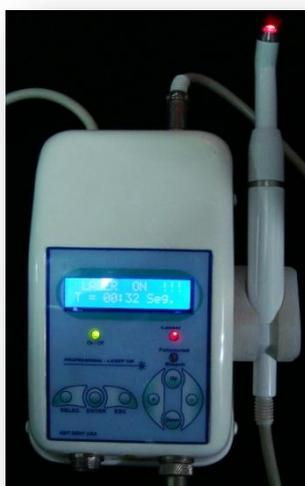
Gráfico 9. LÁSER DIODO DE BAJA POTENCIA DE GaAlAs
