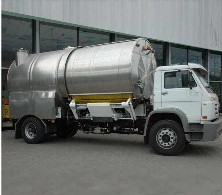
**FIGURA 3.2.4-5:** Camión lava contenedores carga lateral (LCL-163)
