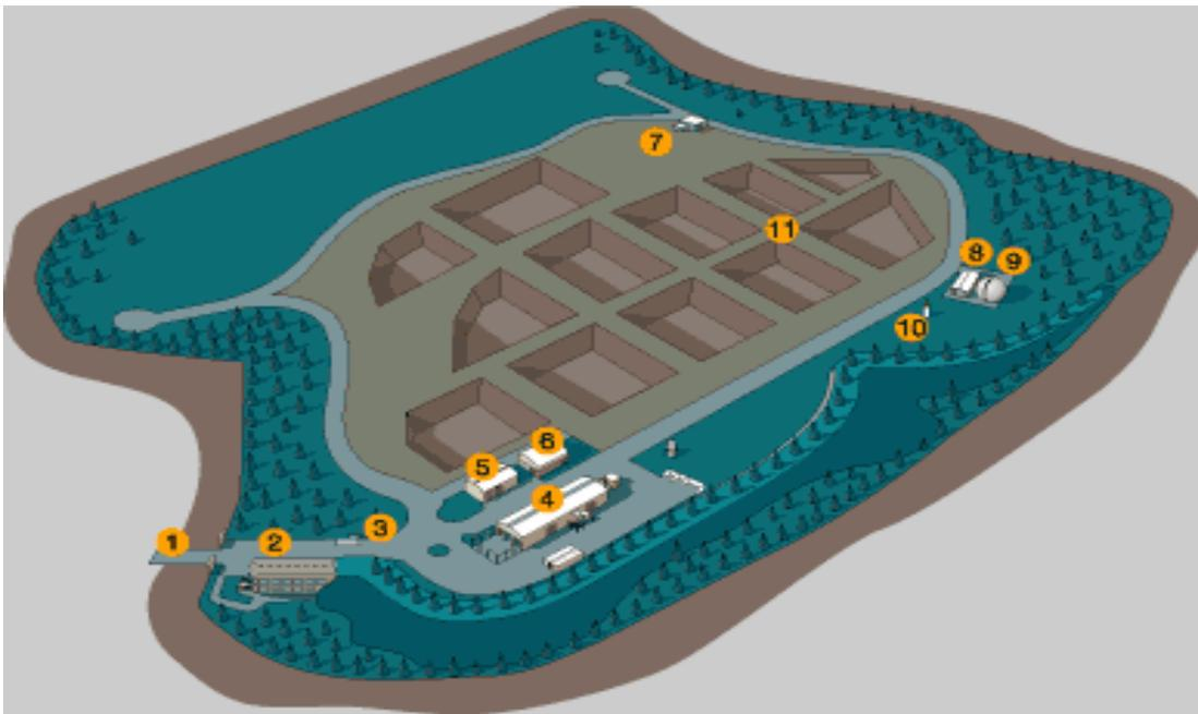
**Figura 4.3.1-1:** vertido en zanjas o celdas.
