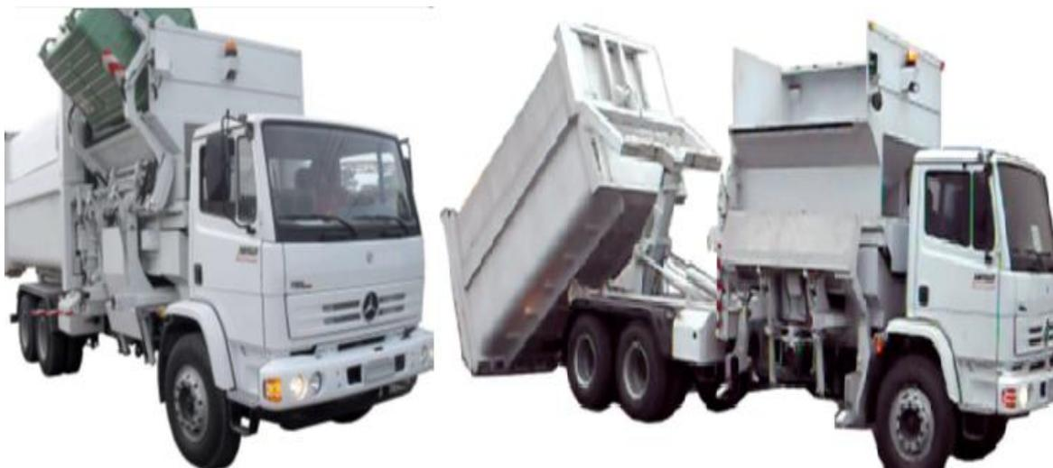
**FIGURA 3.2.4-1:** camión compactador con caja desmontable.
