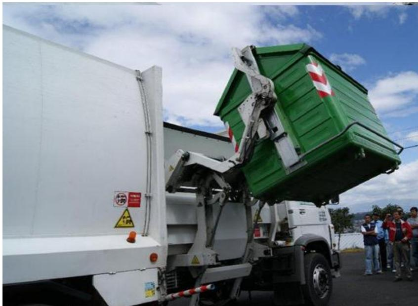
**FIGURA 3.2-1:** Vehículo recolector con carga lateral.
