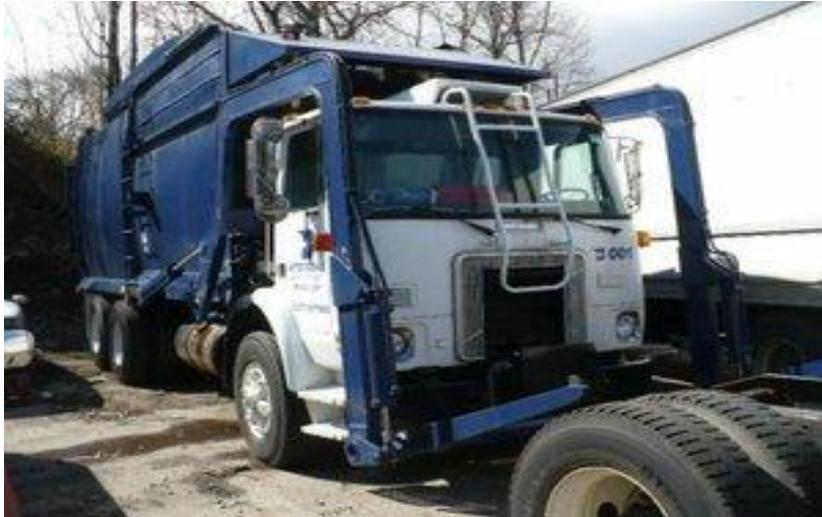
**FIGURA 3.2-3:** Vehículo recolector con carga frontal.
