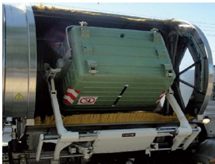
**FIGURA 3.2.4-4:** Sistema de lavado de contenedor.
