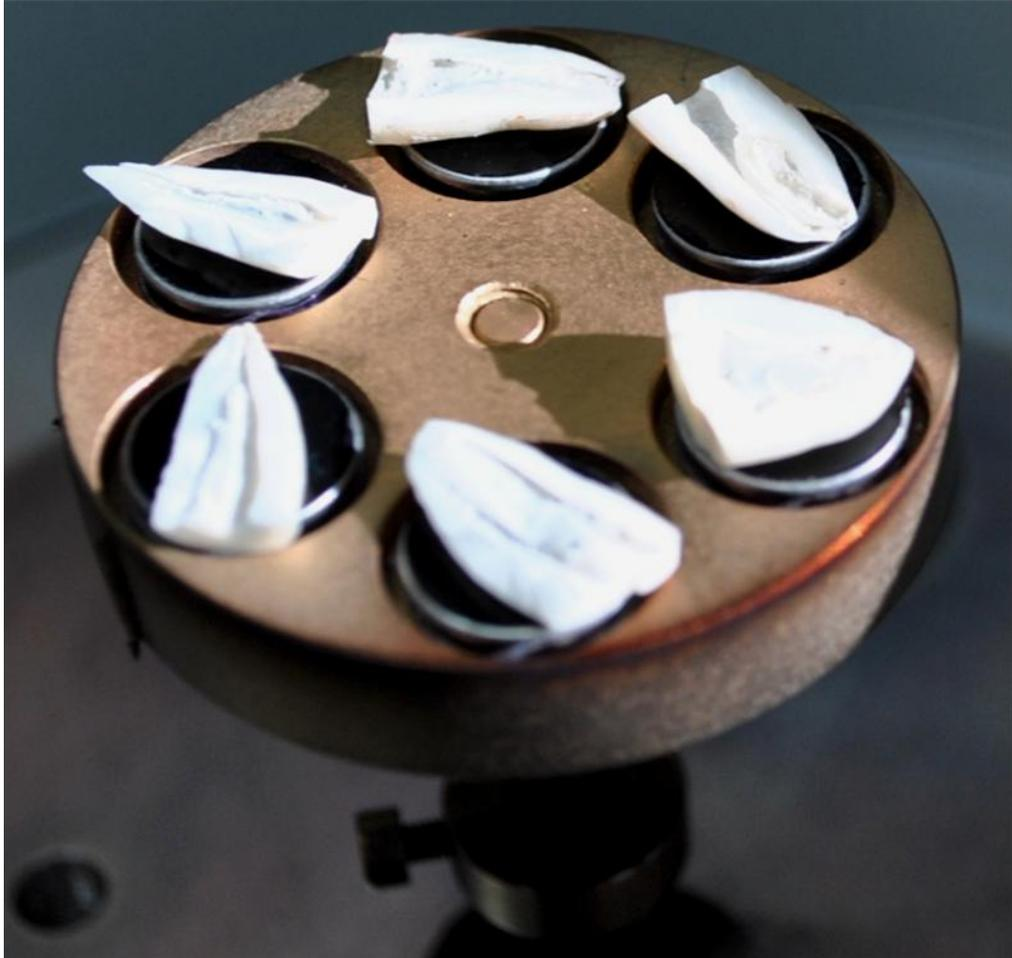
Fotografía 22: Hemisecciones dentales colocadas en la platina del microscopio electrónico de barrido para poder tomar las imágenes de los tercios apical, medio y coronal de cada hemisección.
