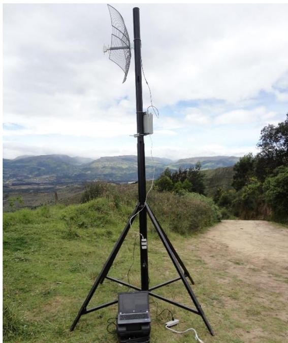
**Figura 5. 39: Fotografía del receptor para la prueba a larga distancia a 35Kms**
