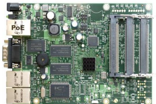
**Figura 3. 2: RouterBoard 433AH de Mikrotik**
