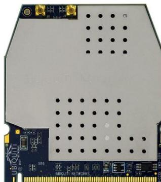
**Figura 3. 3: Tarjeta mini-PCI XR9 de Ubiquiti**
