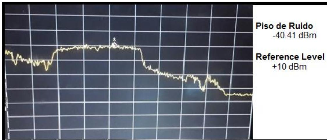
**Figura 5. 14: Espectro de la señal más interferencia y ruido**
