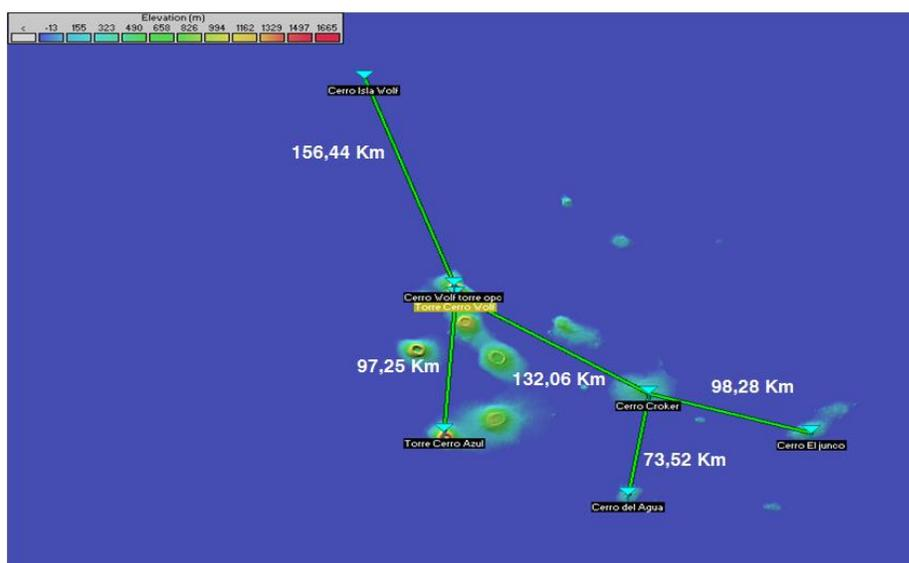
**Figura 2. 2: Estructura del Backbone**
