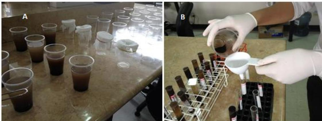
**Figura 16. Procesamiento de muestras de suelo. (A) Muestras en proceso de sedimentación tras realizar 2 lavados. (B) Llenado de tubos de ensayo con las muestras sedimentadas y mezcladas con Solución Sheather.**
