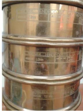
**Figura 12 Tamices utilizados para obtener el tamaño de arena deseado.**
