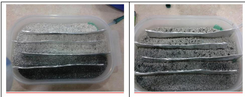
**Figura 35 A la izquierda tenemos el reactor PFR después de haber pasado por el tratamiento del agua sintética de 35mg/L. A la derecha tenemos el mismo reactor PFR después del tratamiento del agua residual de teñido de una curtiembre.**
