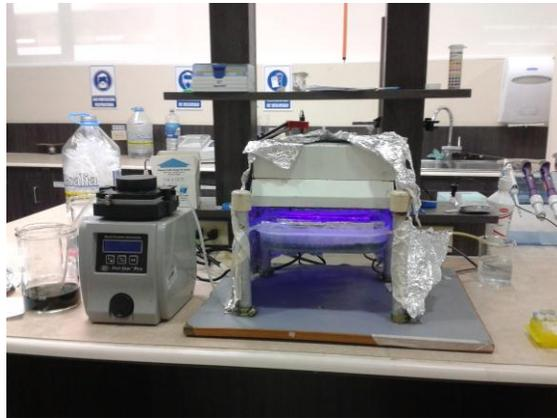
**Figura 15 : Reactor PFR para la fotocatalisis con TiO<sub>2</sub> fijado.**
