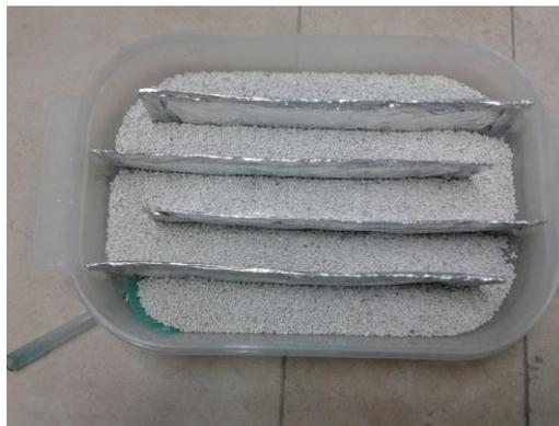
**Figura 17 : Reactor PFR con el TiO<sub>2</sub> fijado en el lecho de arena.**
