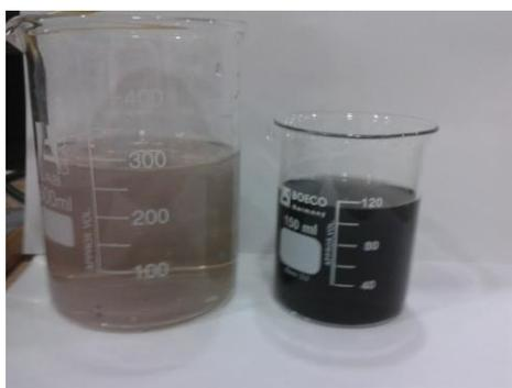
**Figura 34 Al lado izquierdo se muestra el agua tratada y al lado derecho se muestra el agua residual del teñido de la curtiembre**
