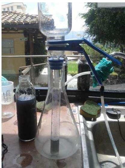
**Figura 32 Filtración al vacío de las aguas residuales de la fase de teñido de una curtiembre.**
