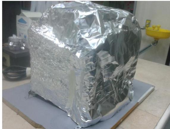
Reactor Batch cubierto de aluminio para evitar la salida de la luz UV
