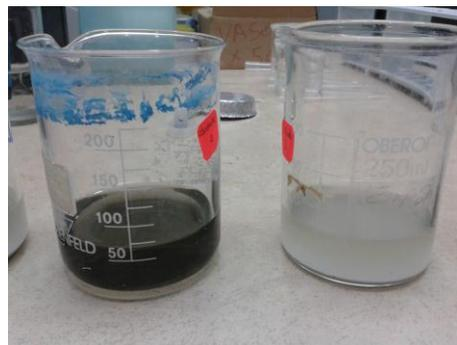
A la izquierda medida de sulfatos en la solución de colorante. A la derecha medida de sulfatos en las aguas residuales del teñido
