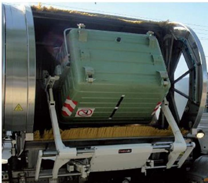
**Ilustración 76. Operación de recogida y limpieza de contenedor. (THEMAC Tecnologías Para el Ambiente)**
