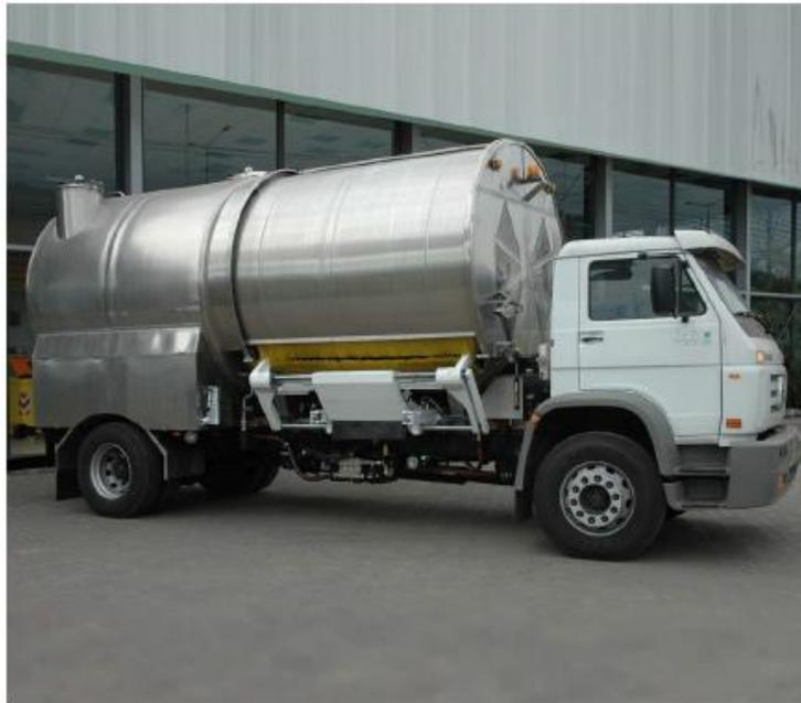
**Ilustración 78. Camión con sistema de lavado instalado. (THEMAC Tecnologías Para el Ambiente)**
