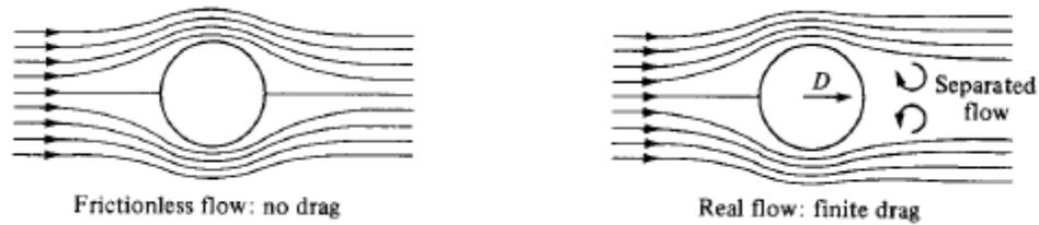
Figura 2. 2 Líneas de flujo sin fricción y con fricción (Anderson, *Fundamentals of Aerodynamics*, 2001)
