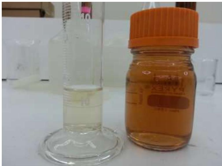
*Figura 9: Cambio de color por clarificación con solución de Carrez*
