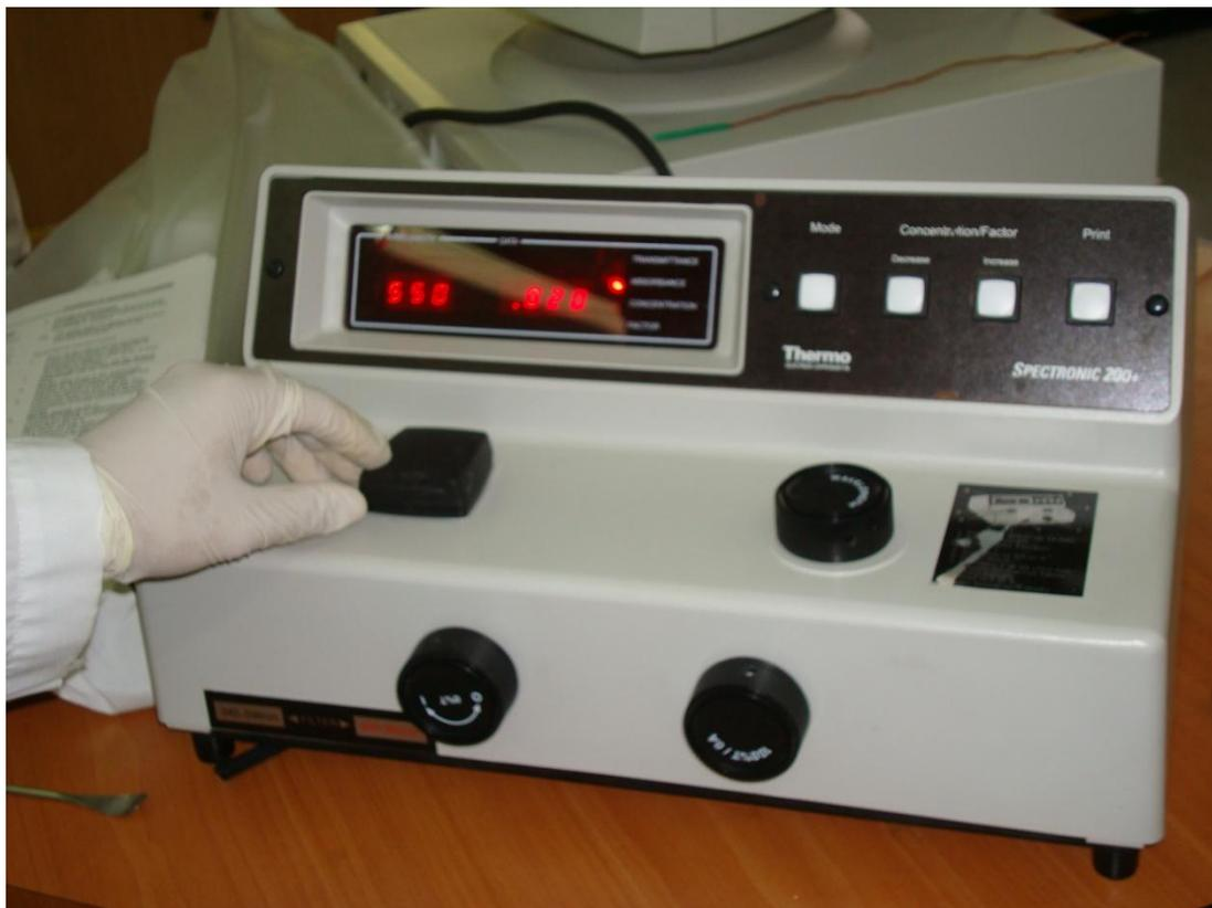
Figura 3.3: Medición de absorbancia en espectrofotómetro
