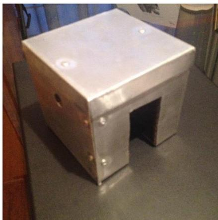
*Figura 31.- Caja de aluminio para evitar flujos de aire externos y facilitar el control de temperatura de la lámpara de mercurio.*
