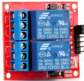
Figura 12.-Módulo de dos relés 12V, 10A. (Extreme, 2014)
