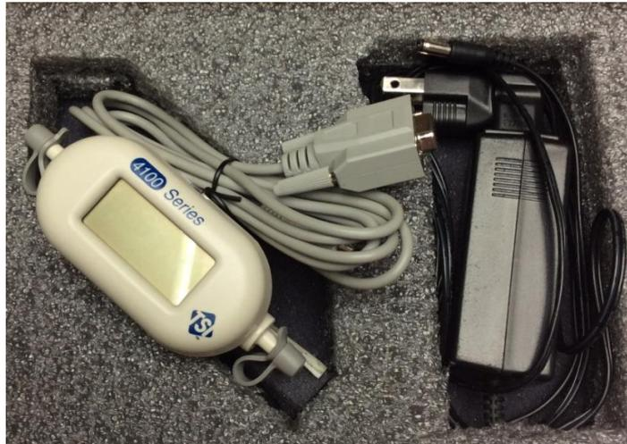
*Figura 52.-Flujómetro 4100 de la marca TSI*
