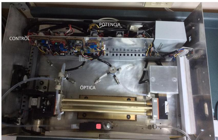
Figura 32.-Ubicación del sistema Óptico, Control y Potencia.
