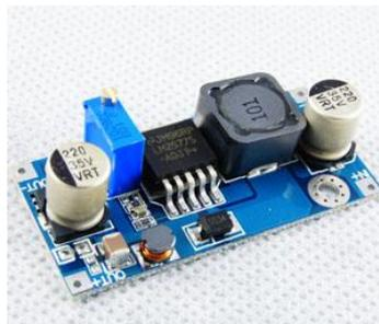
*Figura 17.- Convertidor DC-DC de 5V a 40V de 3A.*
