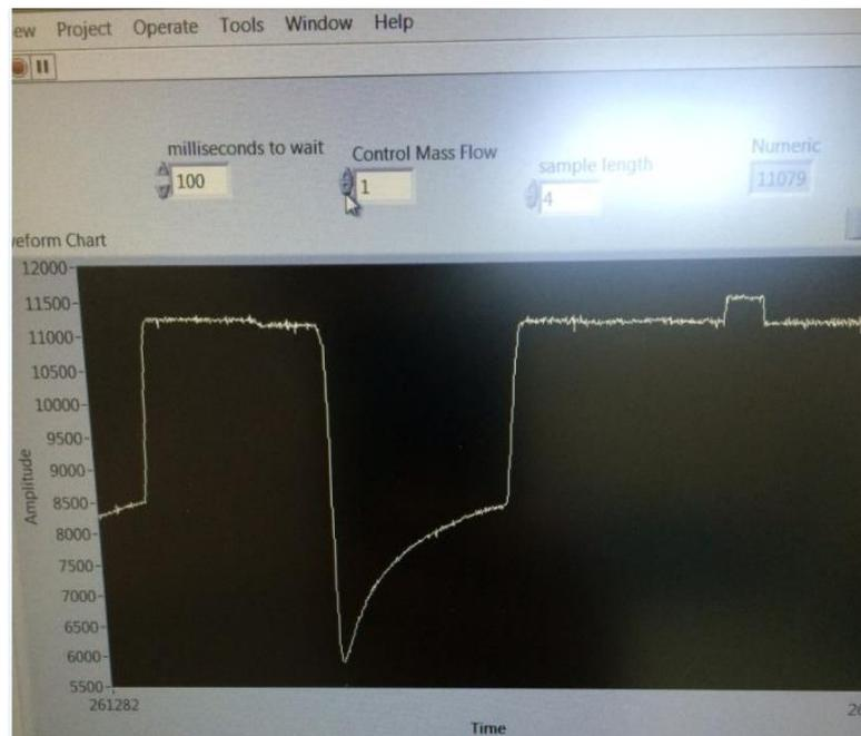
Figura 54.- Gráfico de las cuentas detectadas por el sensor de ozono cuando existe aire y ozono
