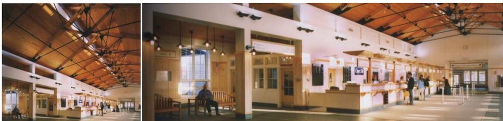
La arquitectura fue diseñada de acuerdo con los principios del desarrollo sostenible: energía solar pasiva, y ventilación natural. Una claraboya aporta circulación de aire, por efecto chimenes, al tiempo se instaló un suelo oscuro de pizarra para absorber el calor durante el día y liberarlo durante la noche.
