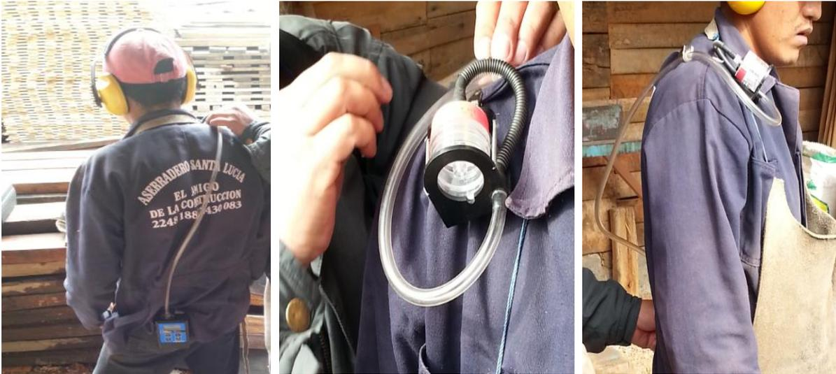
**Figura 18:** Procedimiento de colocación de bomba de aspiración en trabajador para toma de muestra en aserradero “Santa Lucía”
