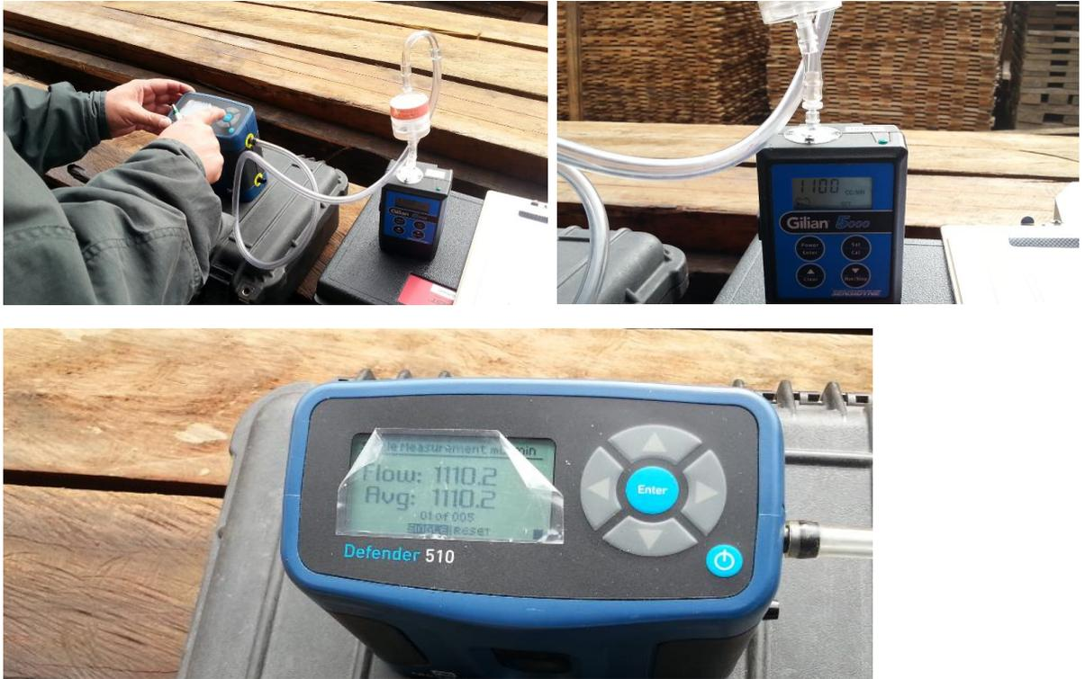
**Figura 19:** Proceso de calibración de la bomba antes de la medición para toma de muestra en aserradero “Santa Lucía” (seteado en 1110 cm<sup>3</sup>/min).
