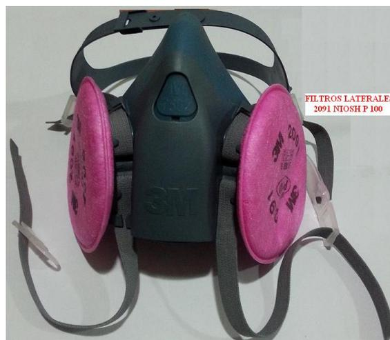
**Figura 26:** Colocación de filtros laterales
