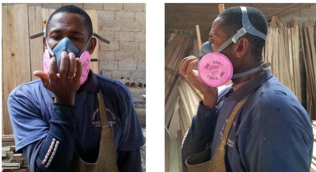
**Figura 27:** Prueba de ajuste con presión positiva
