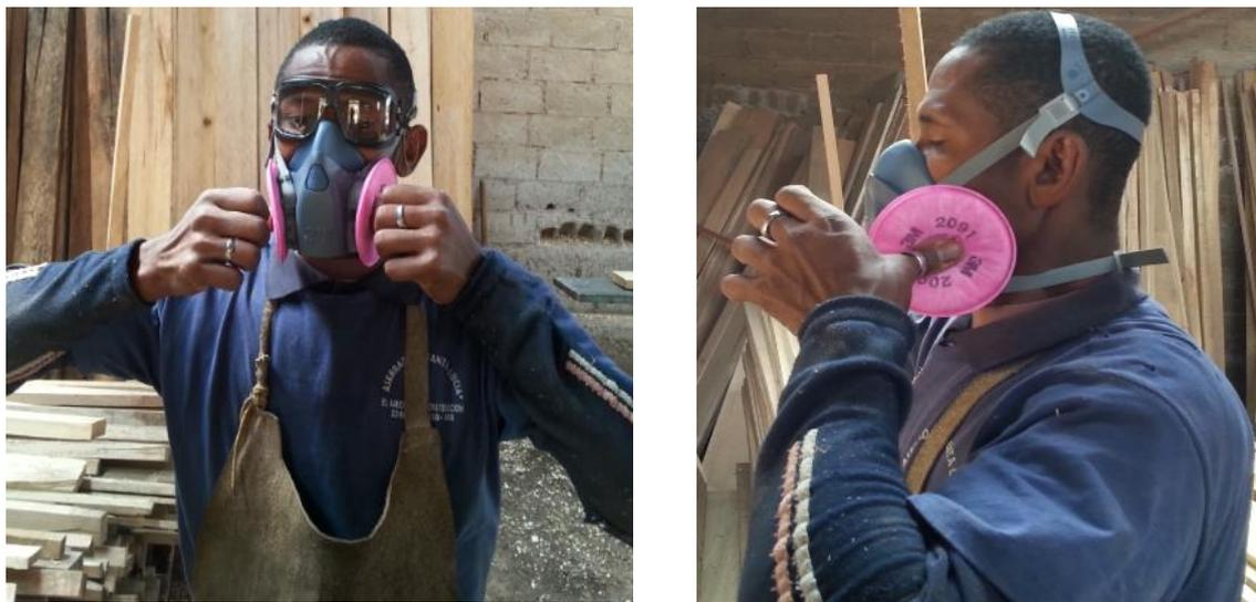
**Figura 28:** Prueba de ajuste con presión negativa
