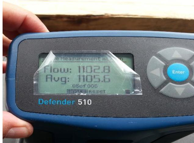
**Figura 20:** Proceso de comprobación del caudal inicial de la bomba de aspiración después de la toma de muestra
