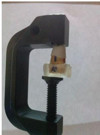
**Figura 15** Posicionamiento de especímenes para realizar las mediciones
