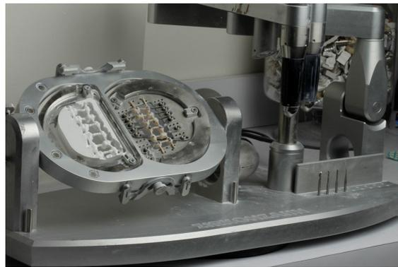
**Figura 11** Sistema pantográfico(Zirconzahn)
