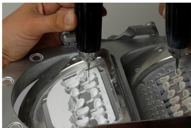
**Figura 12** Fresado de cofias en pantógrafo
