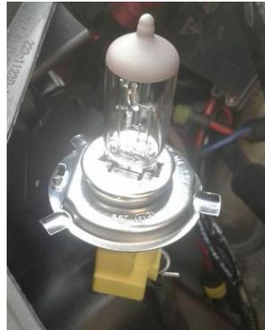
Fig. 4.3 Halógeno 12V 100/90W
