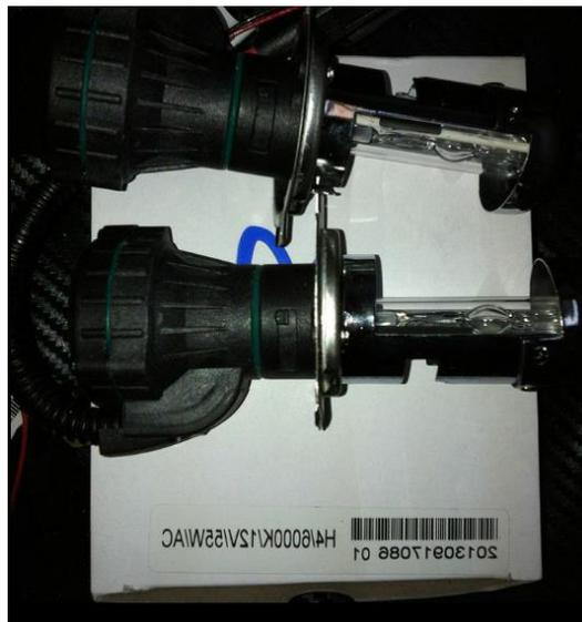
Fig. 4.4 Focos de Xenón 12V 55W
