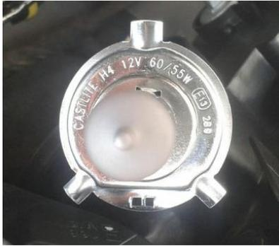
Fig. 4.2 Halógeno 12V 60/55W
