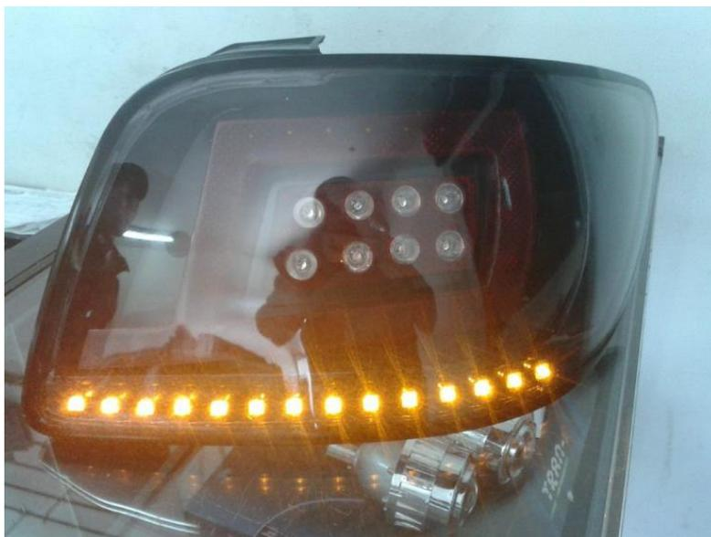
Fig. 3.9 LEDs Direccionales
