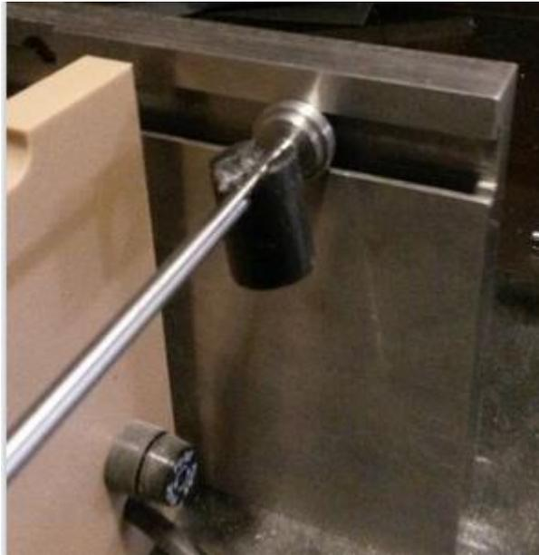
Figura 11a Conexión ejes y riel
