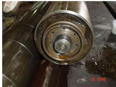
Figura 2.25 Eje y Housing de ESP
