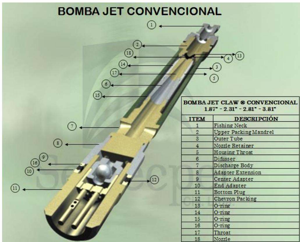
Figura 2.4 Componentes de una Bomba Jet Convencional
