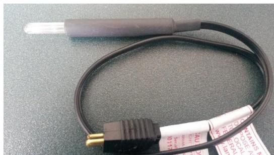
*Figura 4. Lámpara de Mercurio de 185nm*
