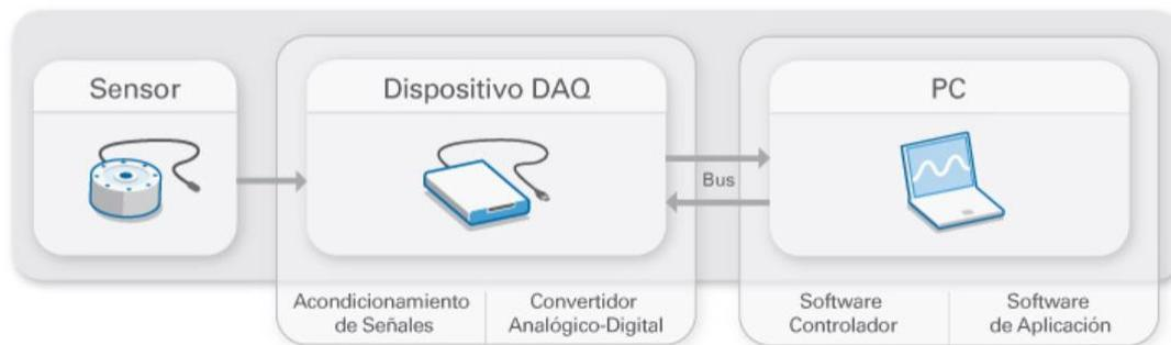
Figura 21. Adquisición de Datos
