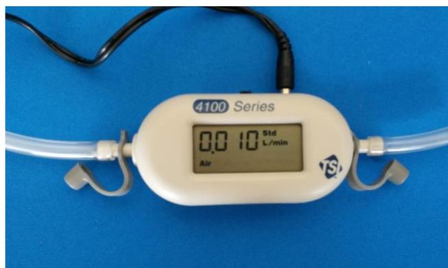
Figura 65. Medidor de Flujo Externo TSI 4100
