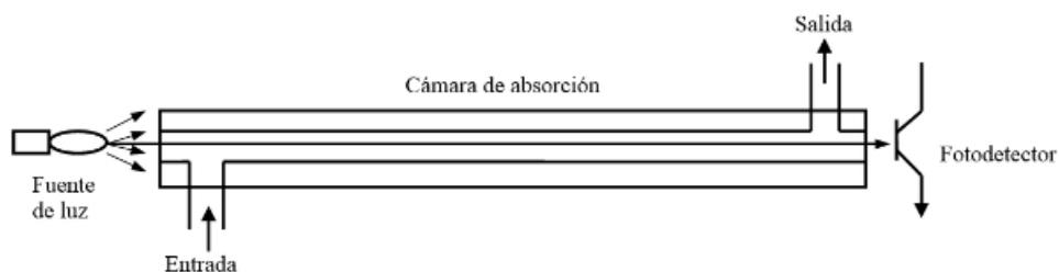
Figura 1. Esquema de Medición de Ozono
