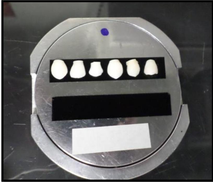
Fig. 6 Carga de muestras en cinta de carbono
