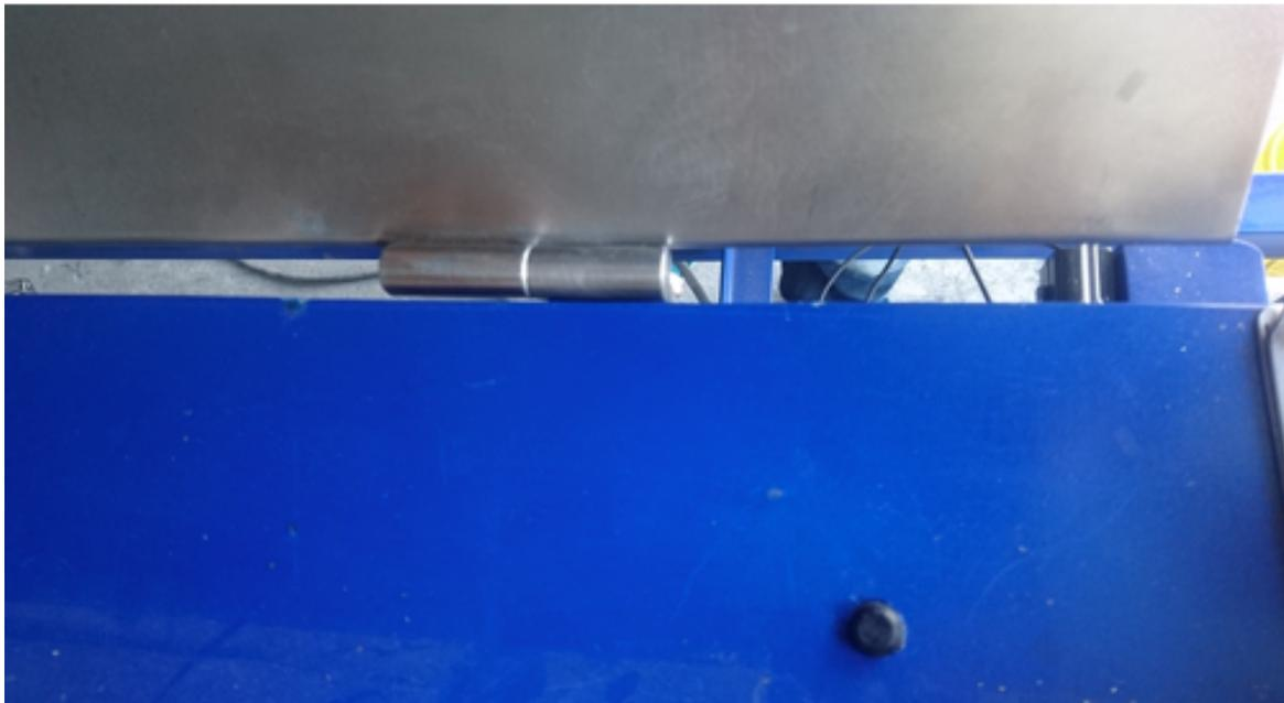
Figura 78: Adición de cauchos automotrices en el sistema de volteo
