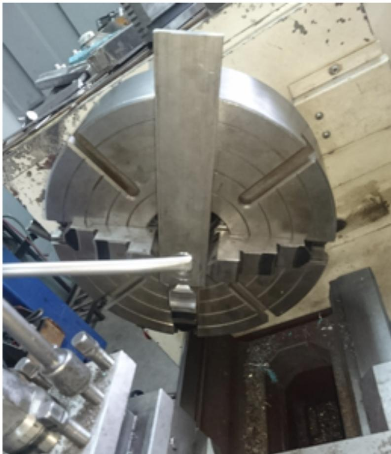
Figura 68: Rectificado de platinas en torno
