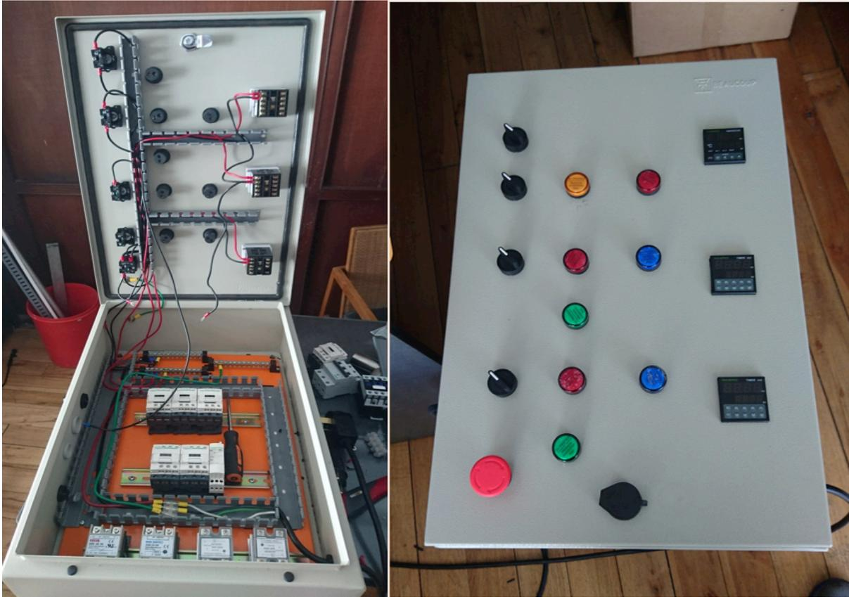
Figura 63: Fabricación del gabinete de control (estación lavado)
