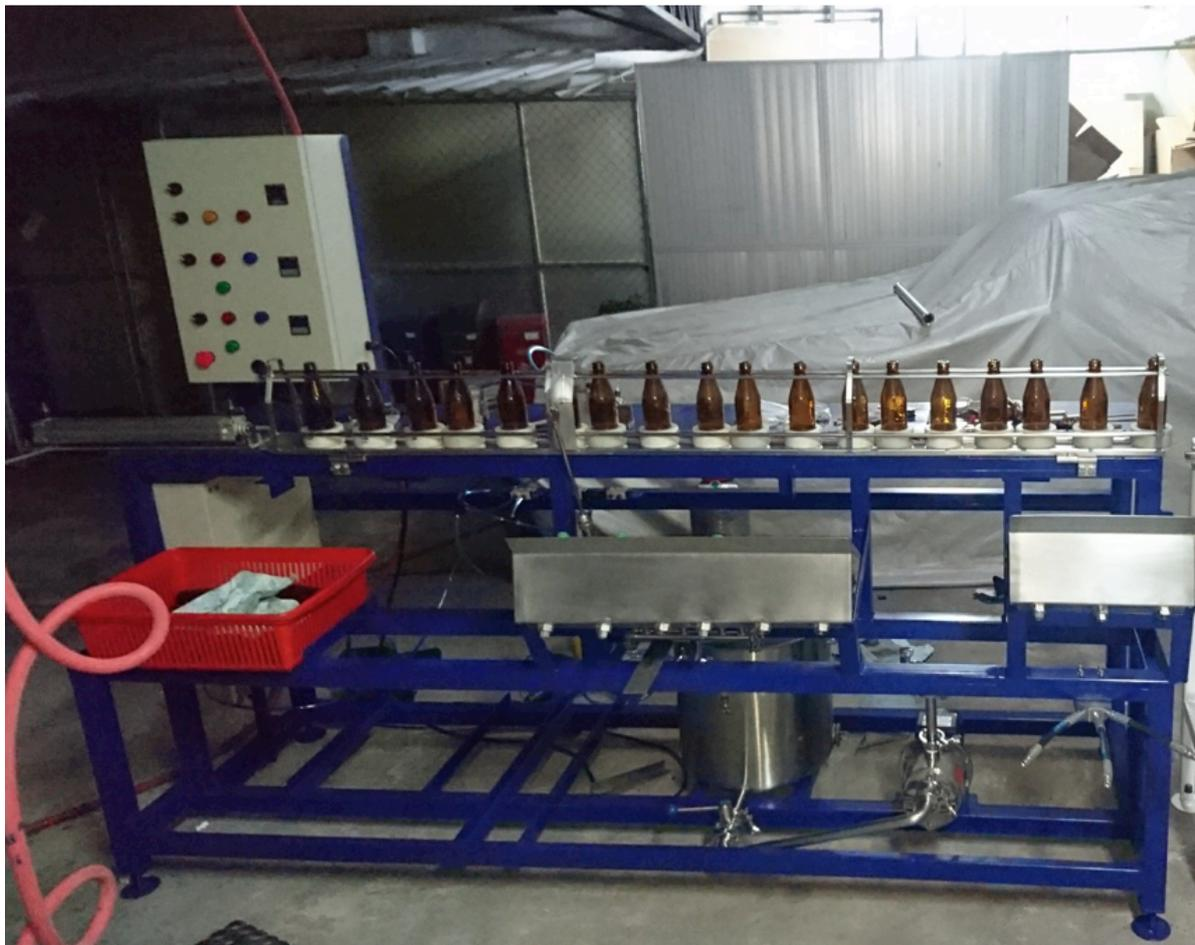
Figura 64: Ensamble de estación de lavado
