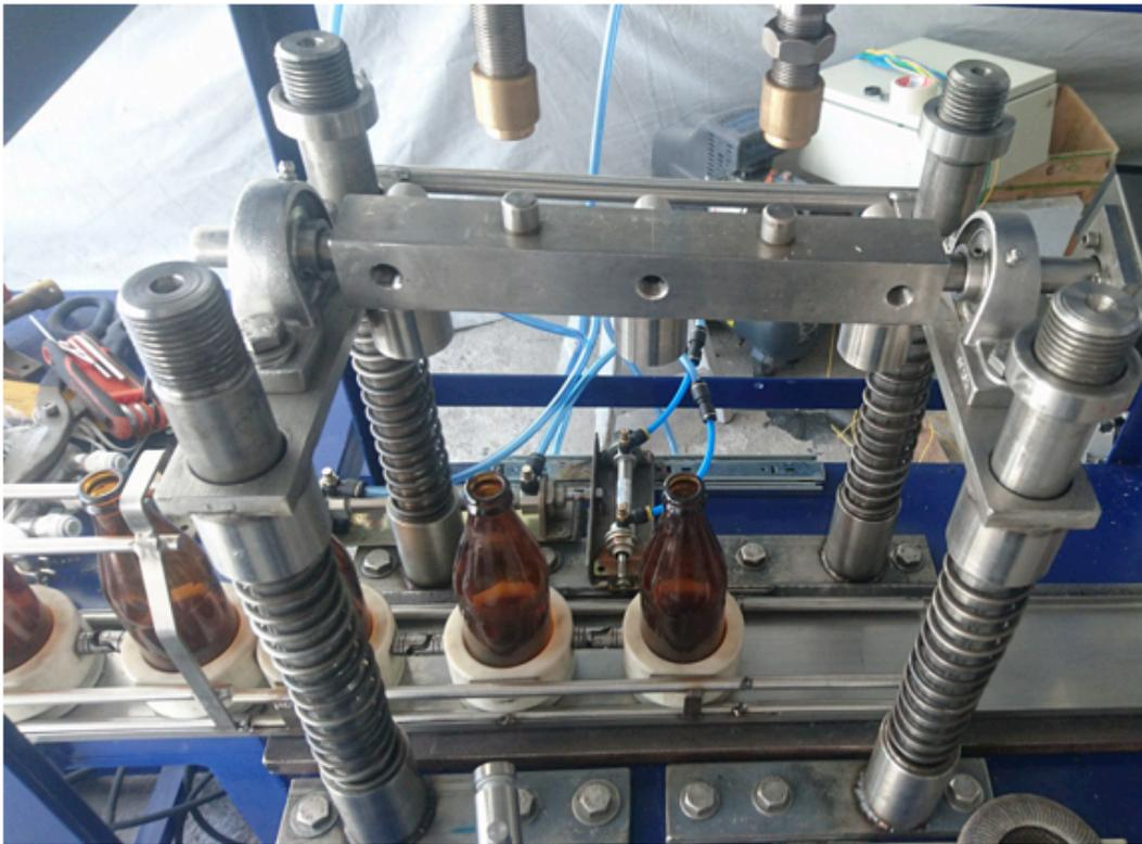
Figura 76: Estación de embotellado
