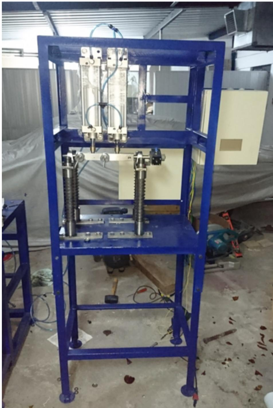
Figura 73: Estación de embotellado y tapado(conjunto)
