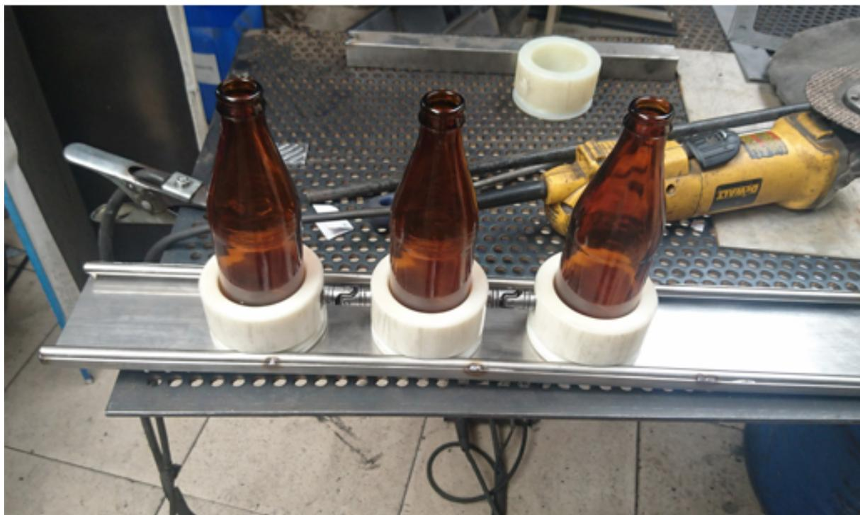
Figura 58: Ensamble de vagones portabotellas
