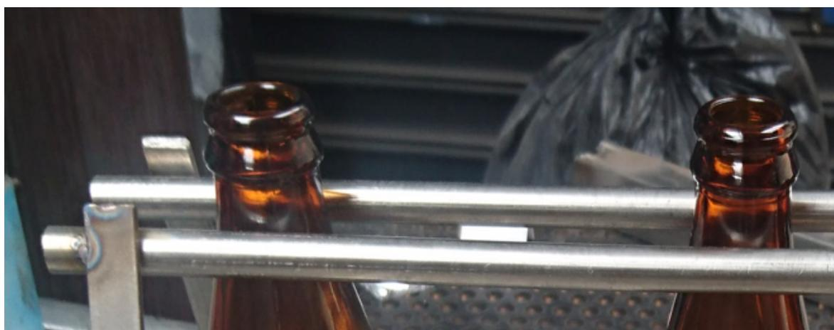
Figura 77: Modificación de abertura del riel de embotellado
