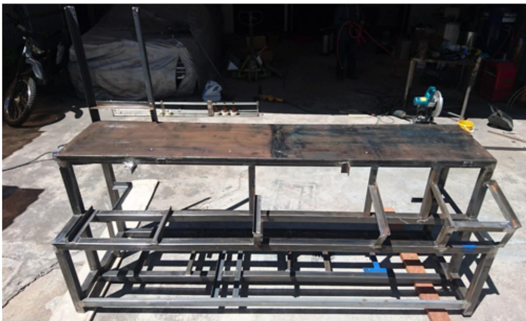
Figura 56: Ensamble de estructura de lavado
