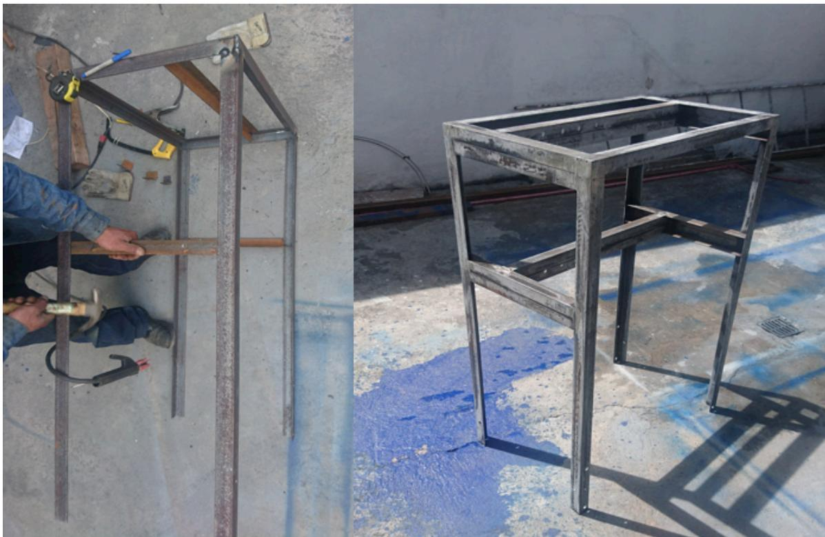
Figura 65: Construcción de estructura de embotellado
