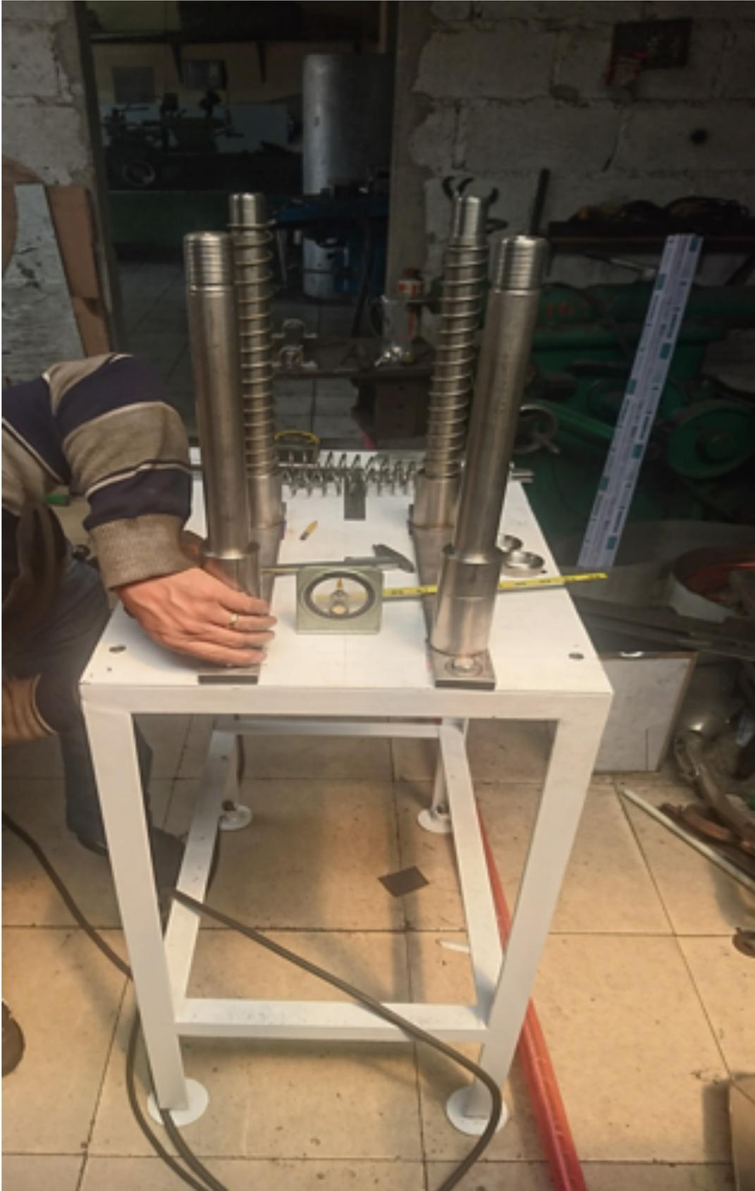
Figura 70: Centrado de sistema de embotellado y tapado
