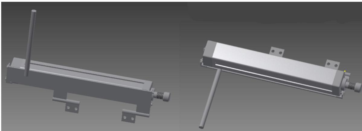
Figura 22: Pistón de recorrido modelado en CAD
