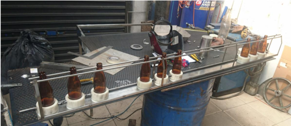
Figura 59: Construcción del riel de lavado
