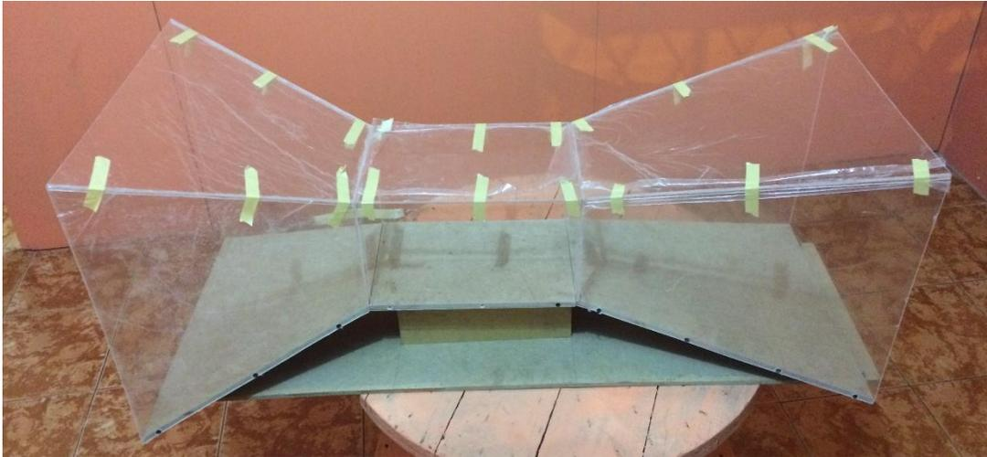
*Foto N. 9 Sección de contracción, prueba y difusor*
