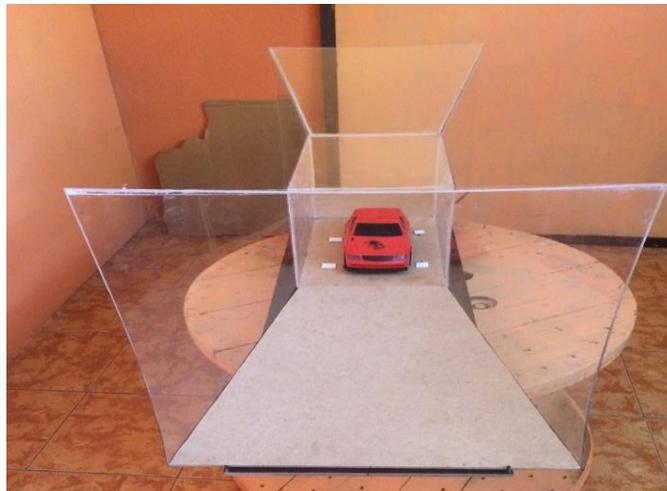
*Foto N. 12 Túnel viento construido*
