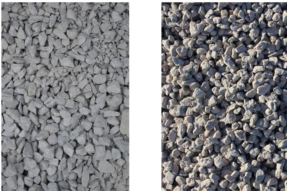
*Figura # 5: Apreciación visual de los dos tipos de agregados grueso utilizados, a la izquierda agregado Holcim, a la derecha agregado “El Guabo”*
