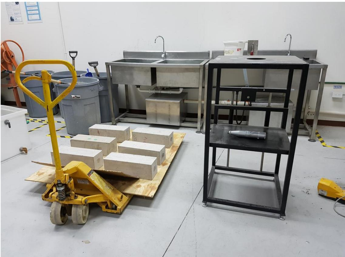
*Figura # 10: Vigas de 150 x 150 x 450 mm para los ensayos no destructivos*
