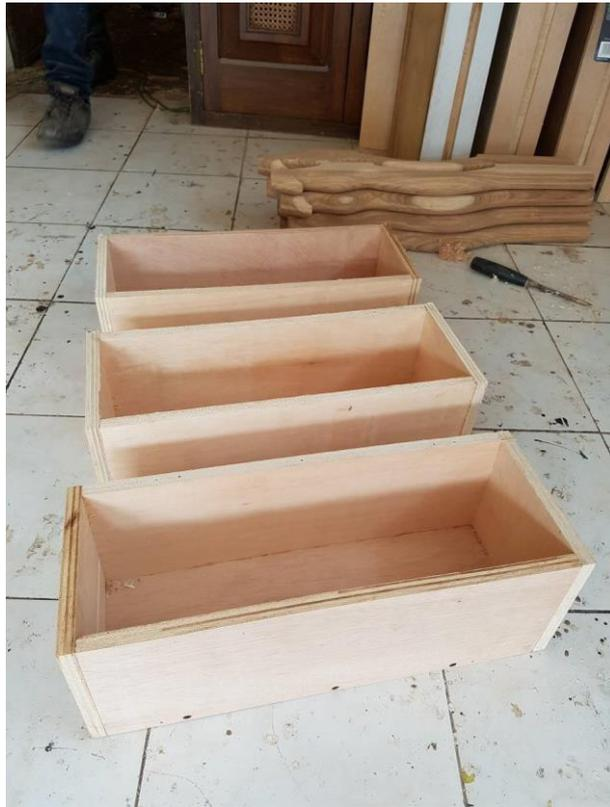
*Figura # 9: Moldes de madera de 150 x 150 x 450 mm para la elaboración de las vigas de hormigón*
