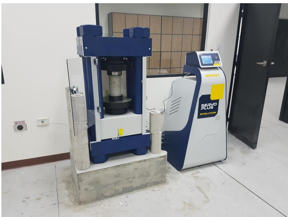
*Figura # 11: Determinación de la resistencia a la compresión de cilindros de 100 x 200 mm de acuerdo a ASTM C39*
