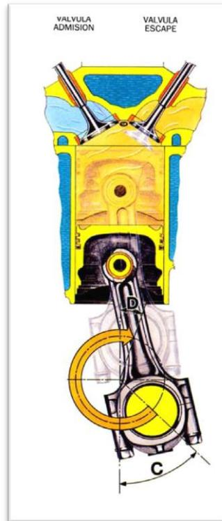
Figura 13 Inicio y final de la fase de escape / Fuente: Manual Fiat Termodinámica
