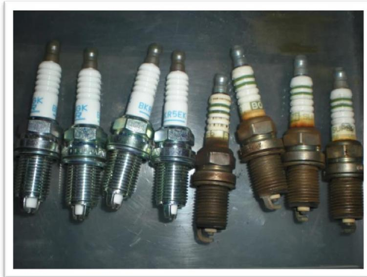
*Figura 62 Cambio de bujías / Fuente: [www.todomotores.cl](http://www.todomotores.cl)*
