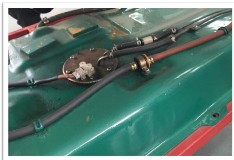
*Figura 51 Instalación eléctrica Bomba de gasolina / Fuente: Propia del autor*
