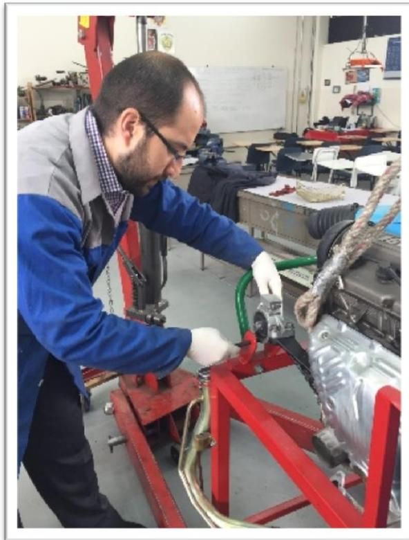
*Figura 41 Instalación de bases del motor en el caballete / Fuente: Propia del autor*
