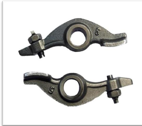
Figura 6 Balancines del motor / Fuente: [www.actualidadmotor.com](http://www.actualidadmotor.com)
