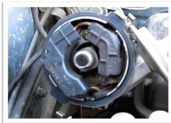
*Figura 25 Módulo de encendido instalado / Fuente: [www.todomotores.cl](http://www.todomotores.cl)*
