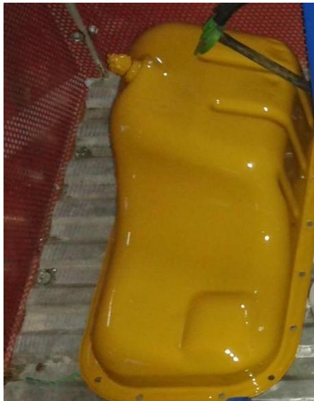
*Figura 29 Cárter del motor / Fuente: Propia del autor*
