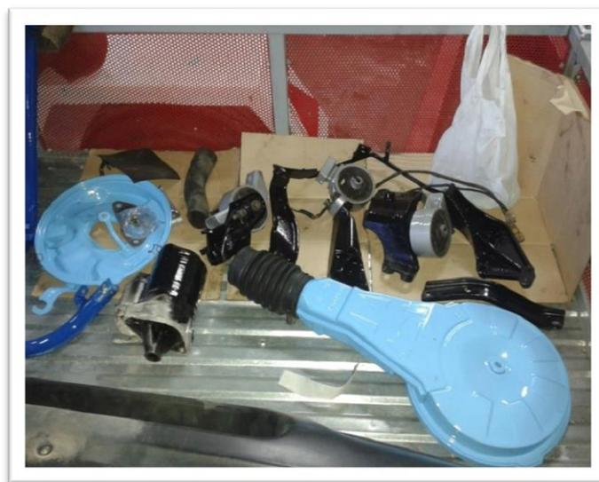
*Figura 40 Filtro de aire y bases del motor pintados / Fuente: Propia del autor*
