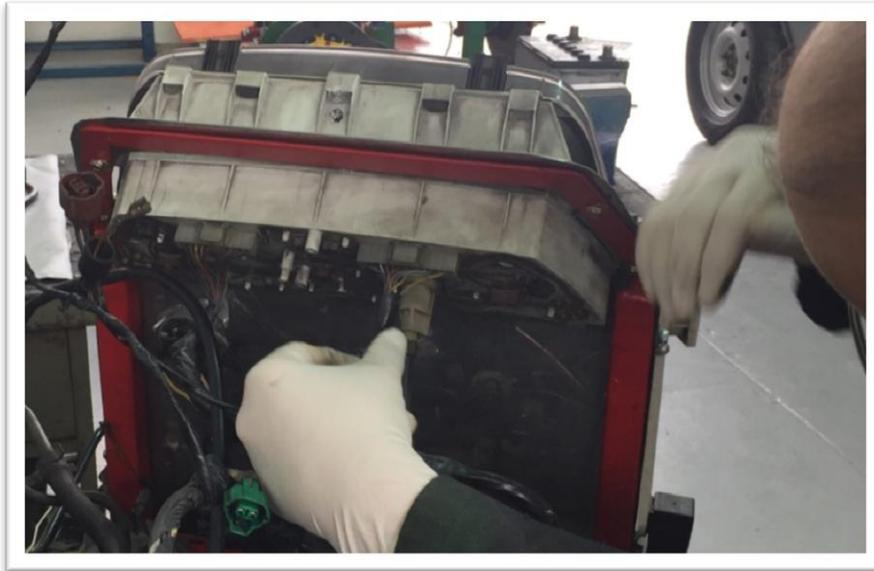
*Figura 48 Instalación del tablero de instrumentos / Fuente: Propia del autor*
