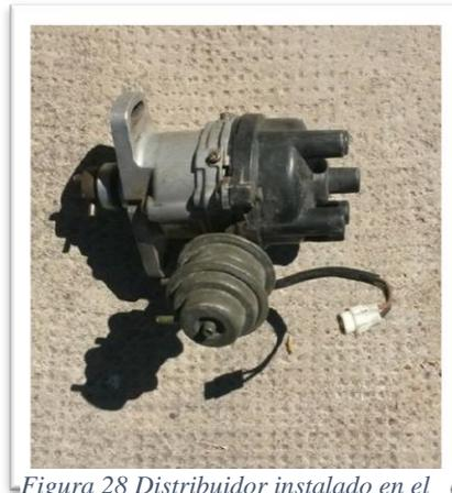
Figura 28 Distribuidor instalado en el banco de pruebas / Fuente: [www.todomotores.cl](http://www.todomotores.cl)
