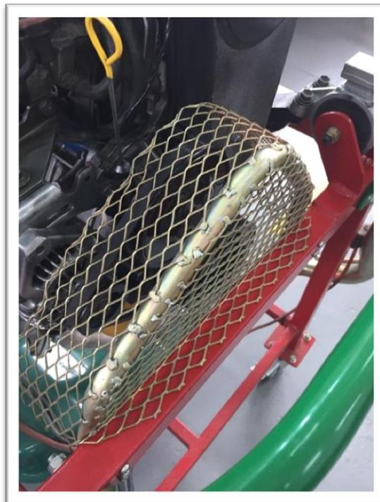
*Figura 53 Malla de protección de banda vista lateral / Fuente: Propia del autor*
