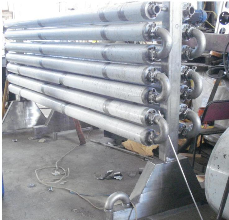
Figura 4.21: Intercambiador de calor
