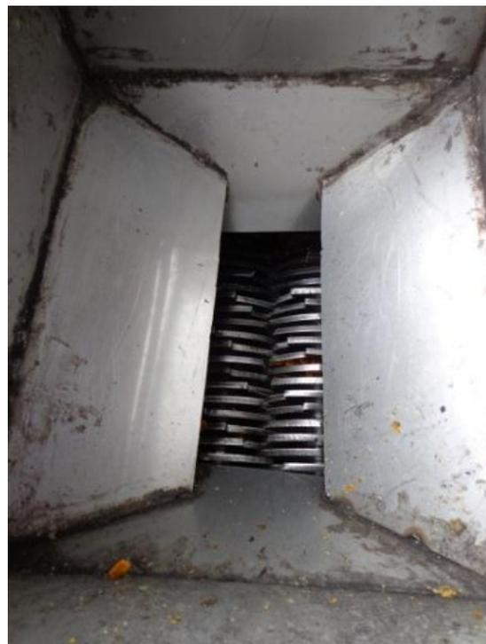
**Figura 4.4: (a) Equipo completo de reducción de tamaño (b) triturador**
