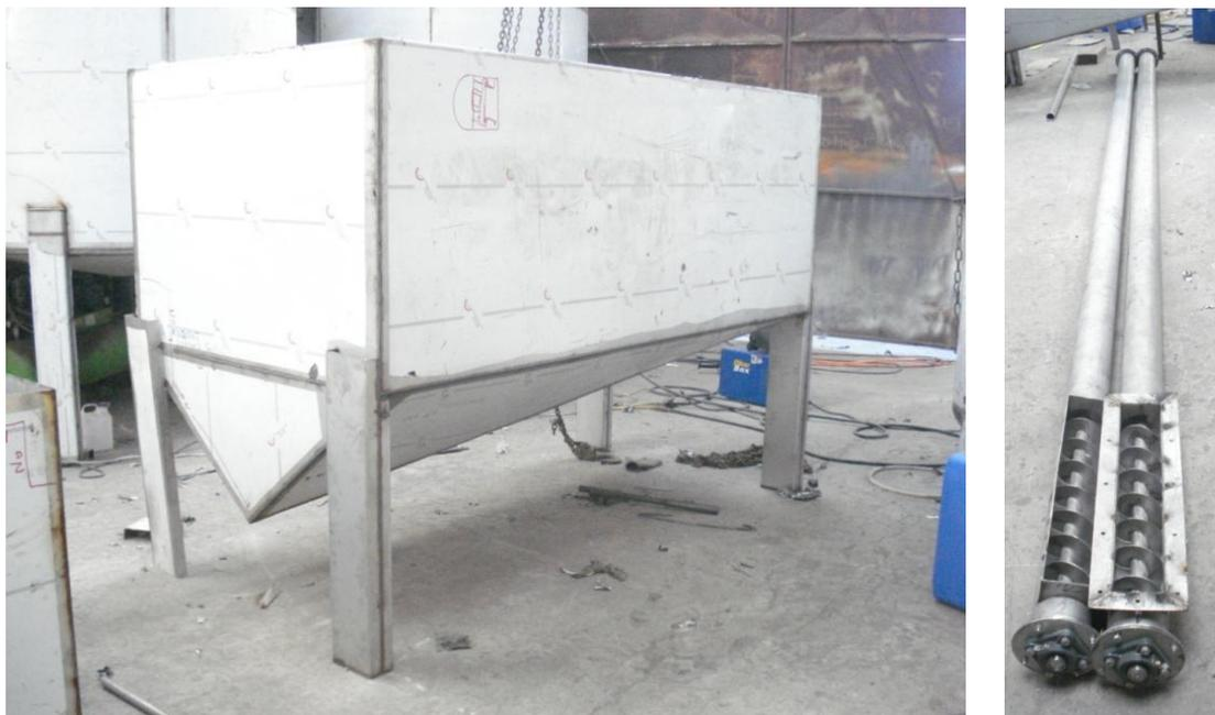
**Figura 4.3: (a) Tanque de almacenamiento de fruta y estércol. (b) Tornillo sinfín de transporte**
