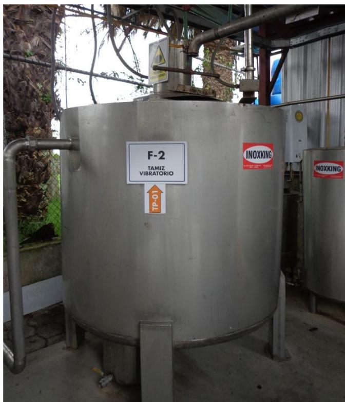
**Figura 4.9: Tamiz vibratorio con tanque**
