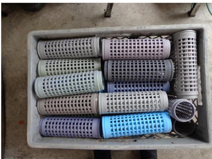
Figura 4.2: Relleno del biodigestor
