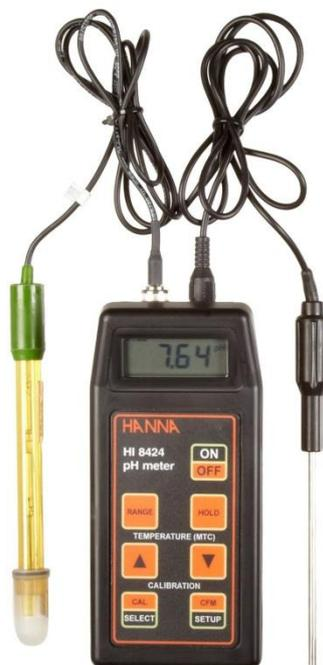
Figura 3.2: Medidor de pH
