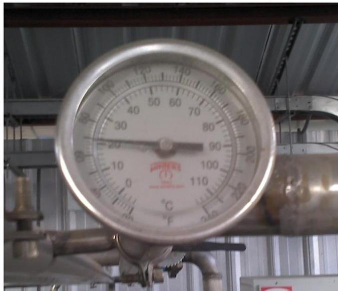
**Figura 4.23: Medidor de temperatura analógico**
