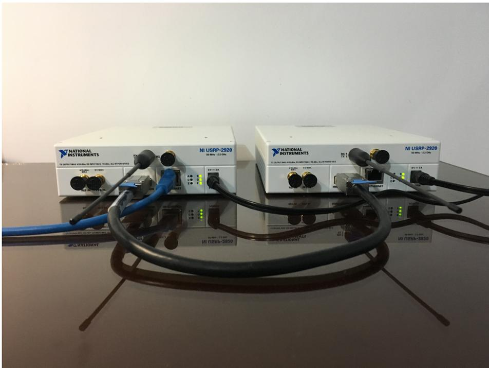
*Figura 22: Conexión física de los USRPs sincronizados mediante cable MIMO Expansion*
