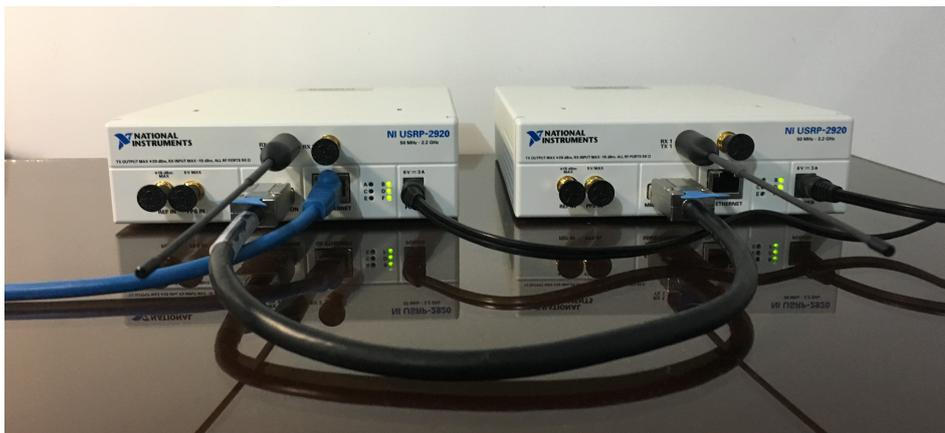
*Figura 1: Conexión física de los USRPs para relojes sincronizados*
