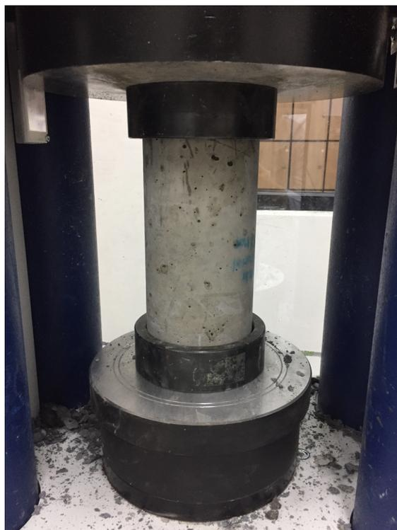
*Figura 15: Determinación de la resistencia a la compresión de cilindros de 100 x 200 mm de acuerdo a ASTM C39*
