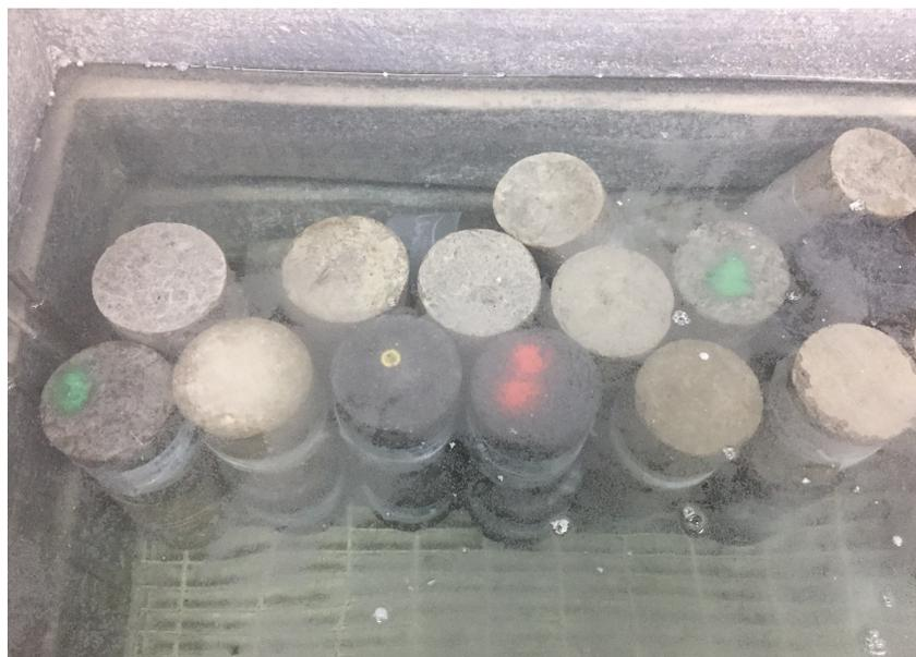
*Figura 14: Cilindros en tanque de curado a  $21^{\circ}\text{C} \pm 2^{\circ}\text{C}$*
