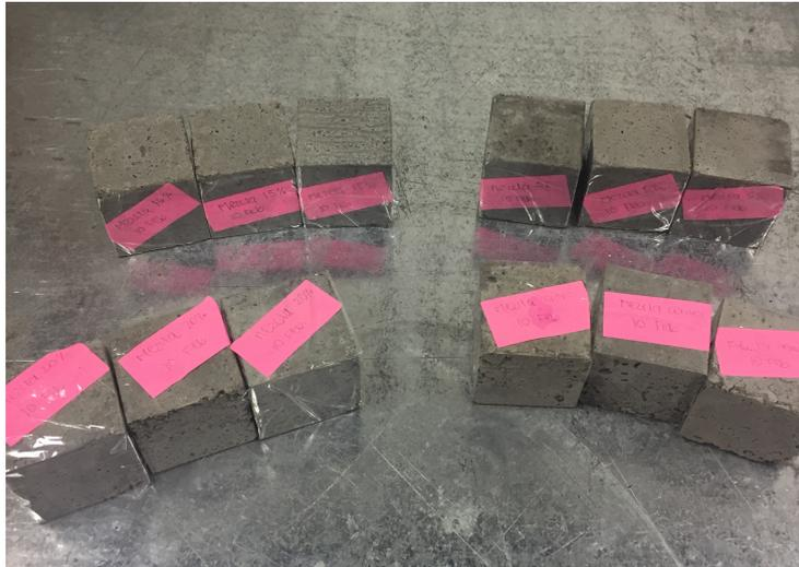
*Figura 11: Cubos de mortero de 50x50mm*
