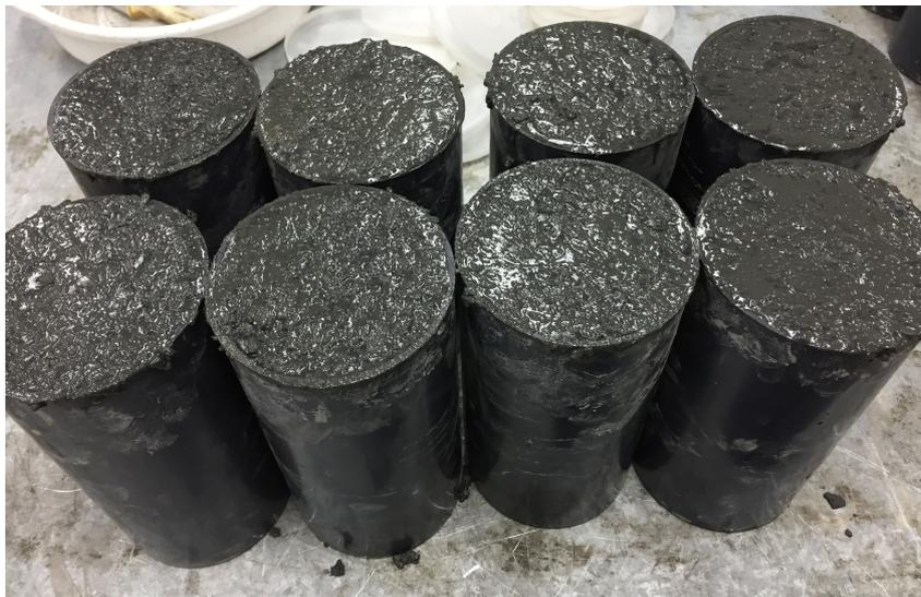
*Figura 13: Elaboración de cilindros de hormigón con %CCA*
